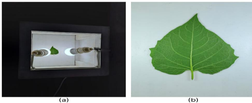
Fig. 14. a) Hoja colocado en la base del prototipo para la captura de imagen. b) Imagen capturada de la hoja.
