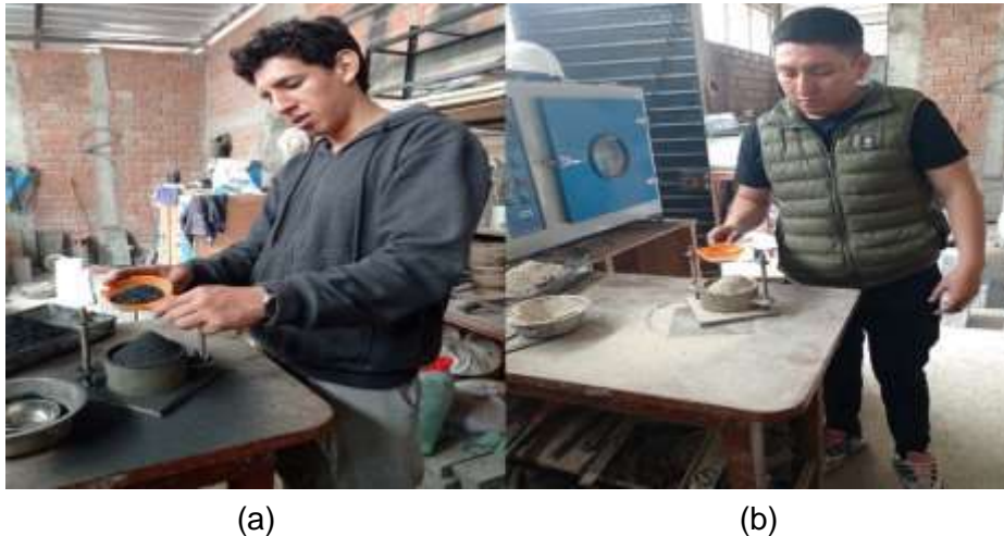
Fig. 15. Ensayo del peso unitario suelto de las muestras. (a) CCA, (b) Diatomita.
