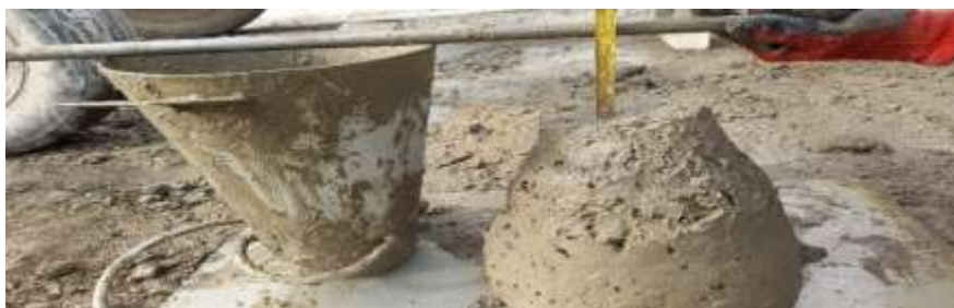
Fig. 18. Prueba de slump.
