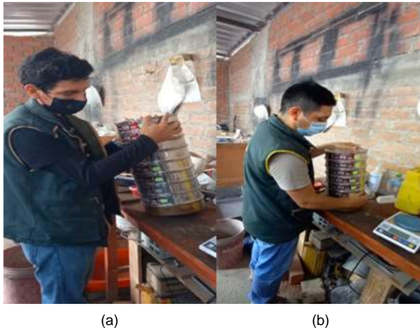
Fig. 8. Proceso del tamizado para agregados. (a) Grueso, (b) Fino.
