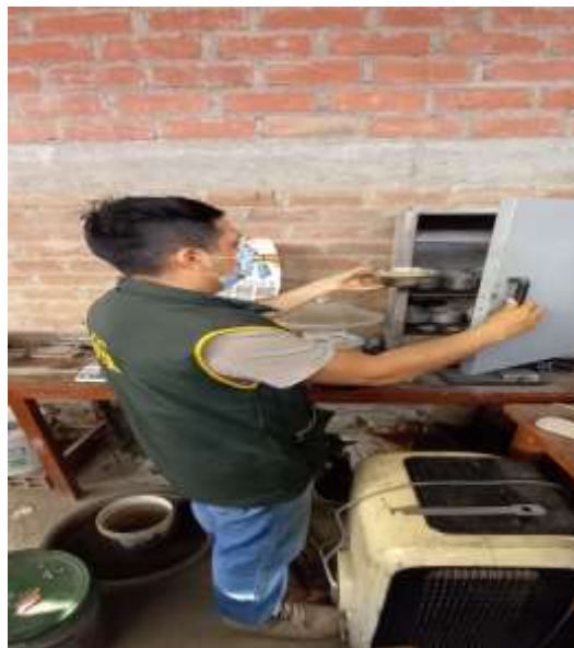
Fig. 10. Muestras de gregados expuestas a 110 °C en el horno.
