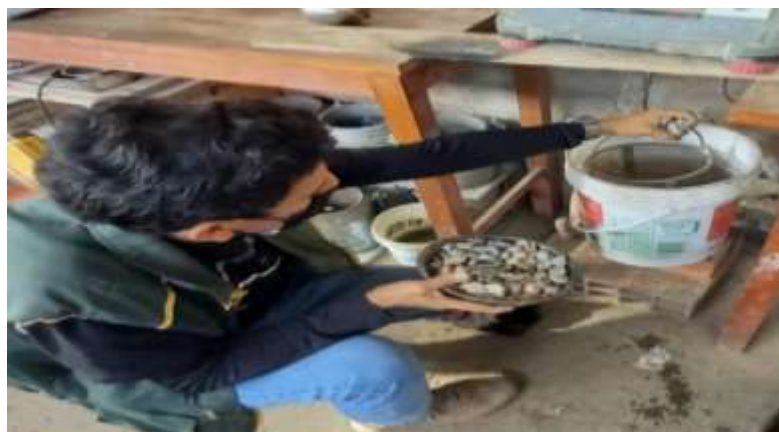
Fig. 11. Muestra saturada superficial seca sumergida con la canastilla en agua.
