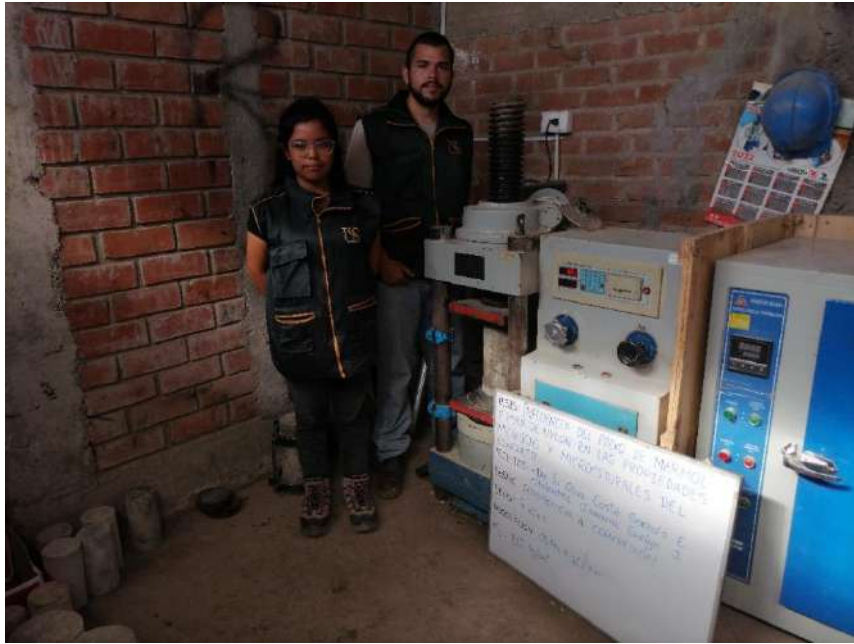
Fotografía 17. Ensayo de resistencia a compresión del concreto a los 7 días f'c = 210 \text{ kg/cm}^2 - 10\%PM + 0.5\%FN
