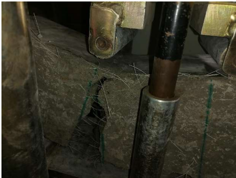
Fotografía 30. Ensayo de resistencia a flexión del concreto a los 28 días f'c = 280 \text{ kg/cm}^2 - 10\%PM + 1\%FN
