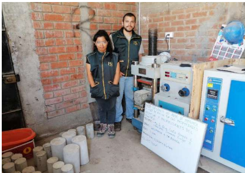
Fotografía 28. Ensayo de resistencia a flexión del concreto a los 7 días f'c = 210 \text{ kg/cm}^2 - 10\%PM + 0.5\%FN
