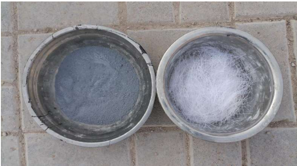
Fotografía 4. Polvo de mármol y fibra de Nailon pesados para el vaciado de la mezcla del concreto
