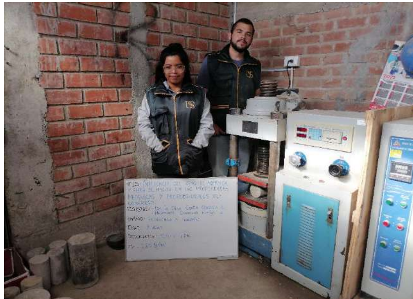
Fotografía 26. Ensayo de resistencia a tracción del a los 7 días f'c = 280 \text{ kg/cm}^2 - 10\%PM + 1\%FN
