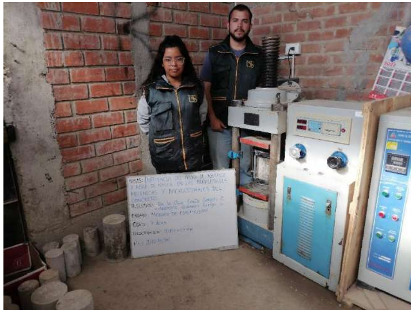
Fotografía 22. Ensayo de módulo de elasticidad del concreto a los 7 días f'c = 280 \text{ kg/cm}^2 - 10\%PM + 0.5\%FN
