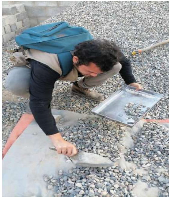
Fotografía 5. Elección del agregado grueso para el análisis granulométrico
