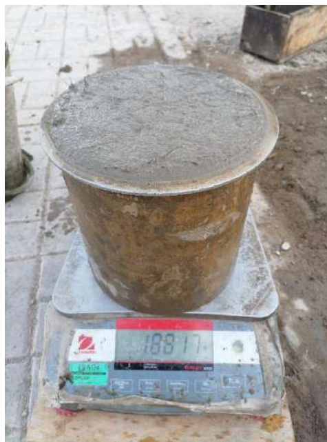
Fotografía 14. Ensayo del peso unitario del concreto en estado fresco
