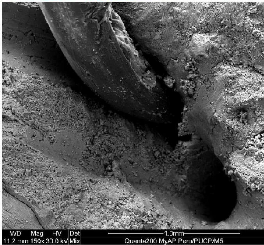
Figura 3. Micrografía a 150x de fragmento de concreto, donde se visualiza una fibra de nylon y un agujero vacío.
