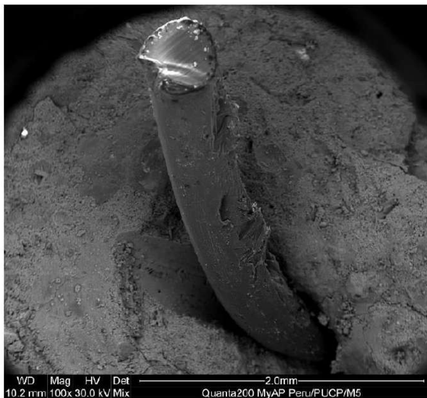
Figura 2. Micrografía a 100x de fragmento de concreto, donde se visualiza una fibra de nylon.
