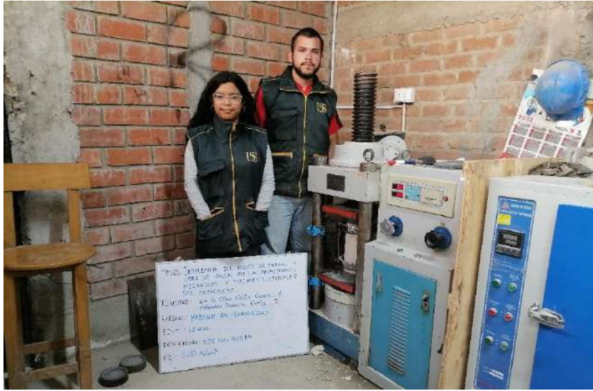
Fotografía 21. Ensayo de módulo de elasticidad del concreto a los 28 días f'c = 280 \text{ kg/cm}^2 - 10\%PM + 0.1\%FN
