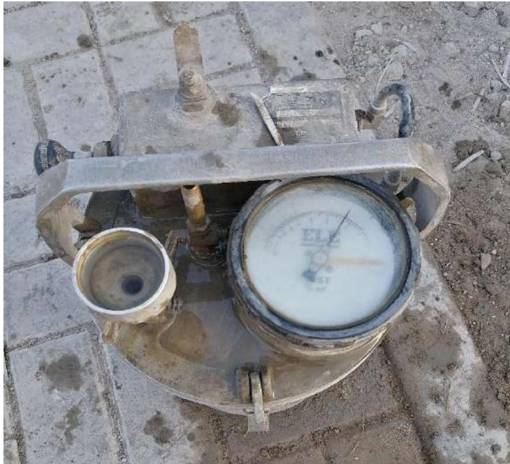
Fotografía 13. Ensayo de contenido de aire del concreto en estado fresco
