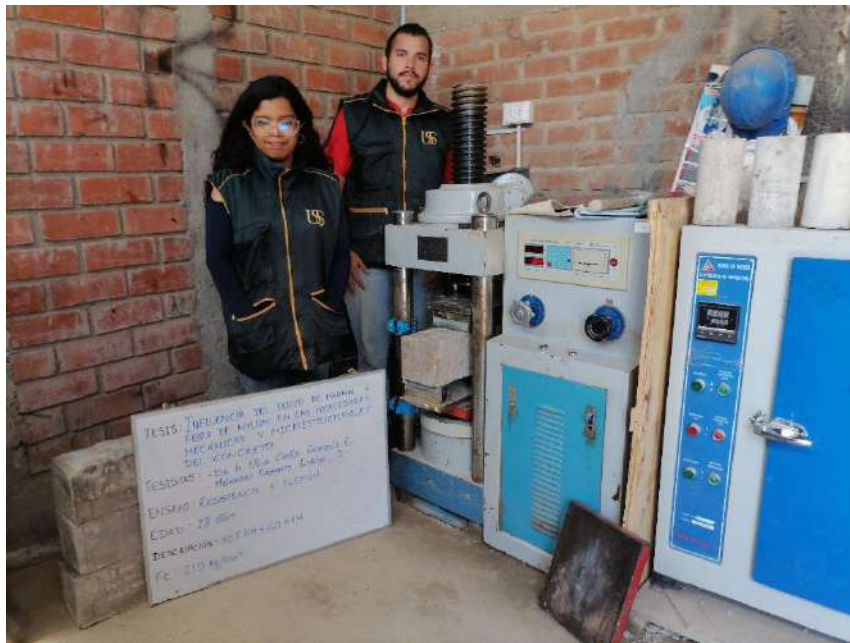
Fotografía 27. Ensayo de resistencia a flexión del concreto a los 28 días f'c = 210 \text{ kg/cm}^2 - 10\%PM + 0.25\%FN
