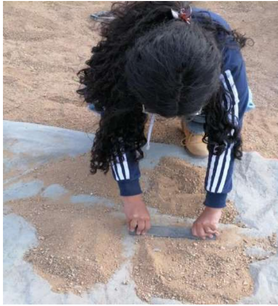
Fotografía 7. Elección del agregado fino para el análisis granulométrico
