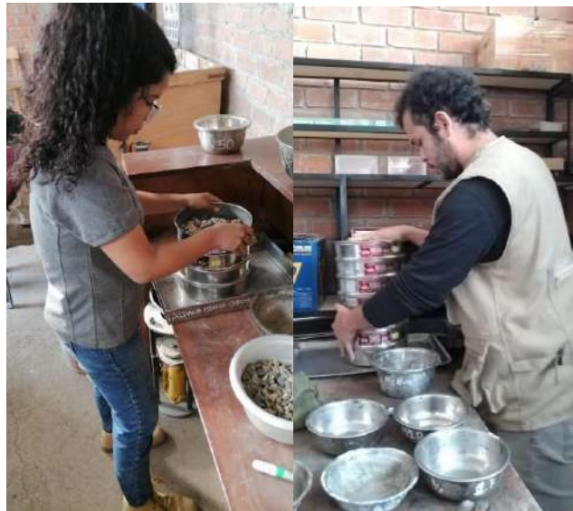
Fig. 8. Tamizado de agregados finos y gruesos
