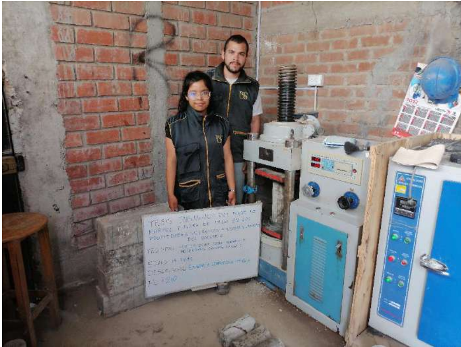
Fotografía 15. Ensayo de resistencia a compresión del concreto a los 14 días f'c = 210 \text{ kg/cm}^2 - Patrón
