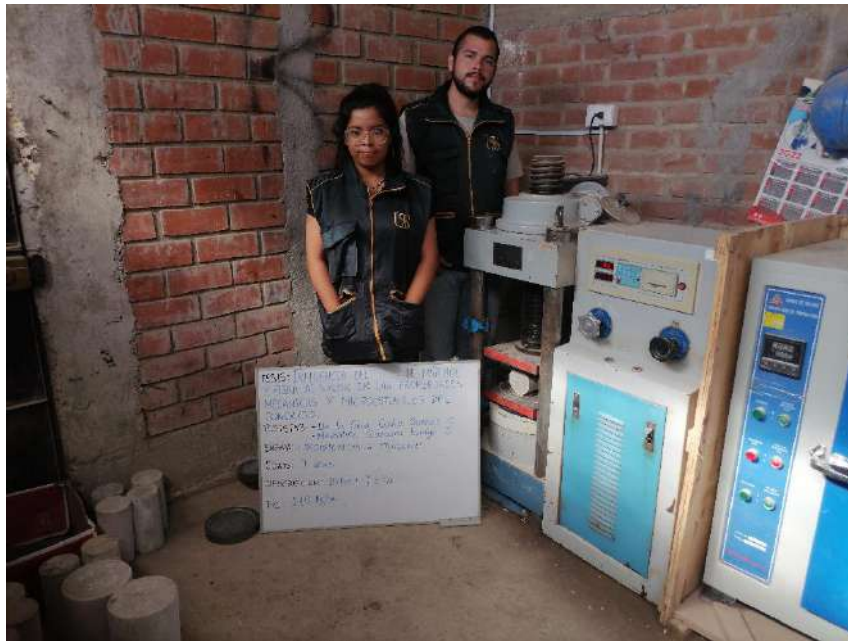
Fotografía 23. Ensayo de resistencia a tracción del concreto a los 7 días f'c = 210 \text{ kg/cm}^2 - 10\%PM + 1\%FN
