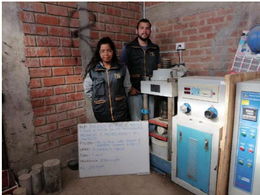
Fotografía 24. Ensayo de resistencia a tracción del concreto a los 7 días f'c = 280 \text{ kg/cm}^2 - 10\%PM + 0.1\%FN
