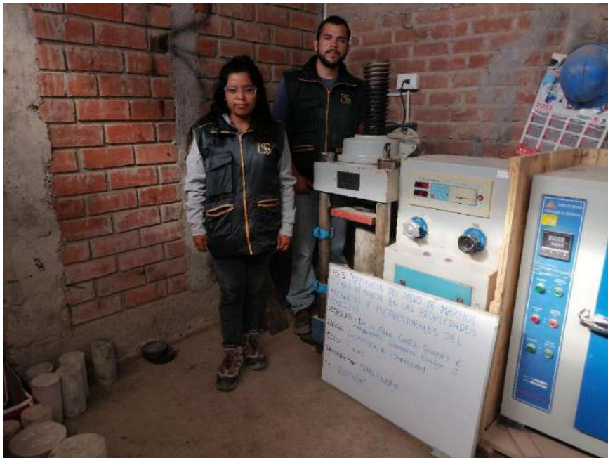
Fotografía 18. Ensayo de resistencia a compresión del concreto en estado endurecido a los 7 días f'c = 280 \text{ kg/cm}^2 - 10\%PM + 0.5\%FN
