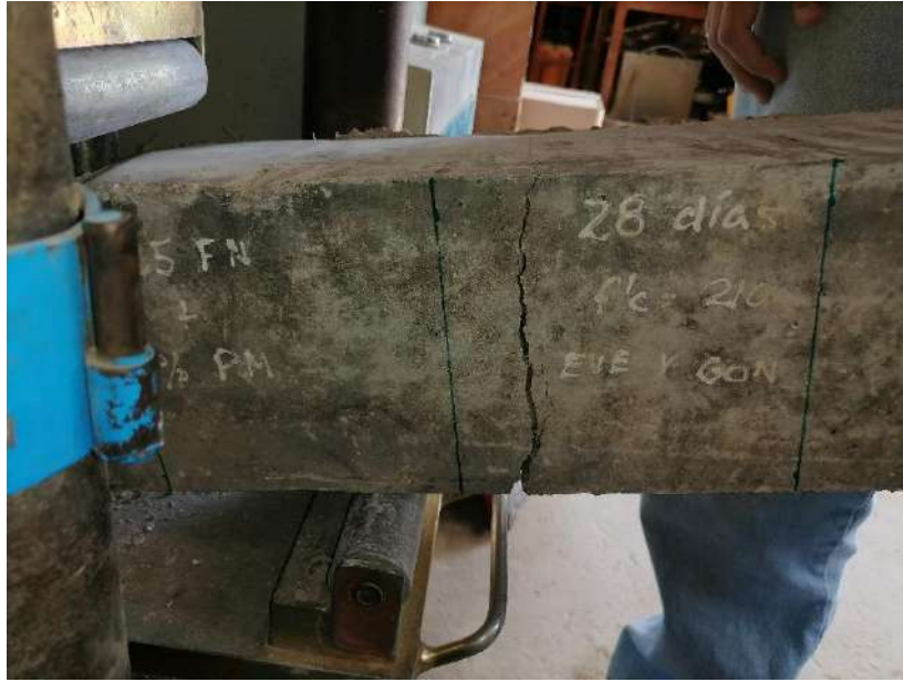
Fotografía 29. Ensayo de resistencia a flexión del concreto a los 28 días f'c = 210 \text{ kg/cm}^2 - 10\%PM + 0.25\%FN
