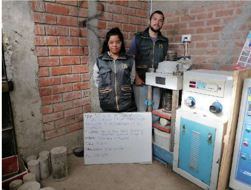
Fotografía 25. Ensayo de resistencia a tracción del concreto a los 7 días f'c = 280 \text{ kg/cm}^2 - 10\%PM + 0.5\%FN
