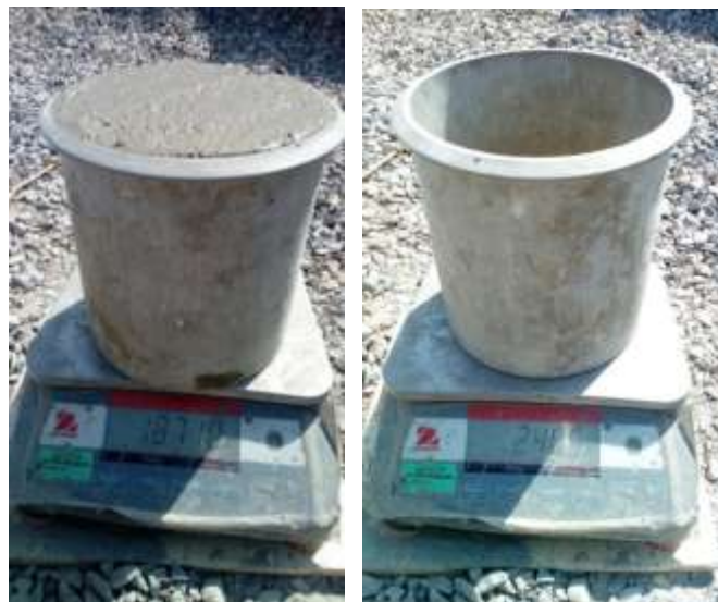
Fotografía 17 Control y Medición de Peso Unitario del Concreto.
