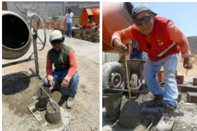
Fotografía 15 Realización y medición de Asentamiento.
