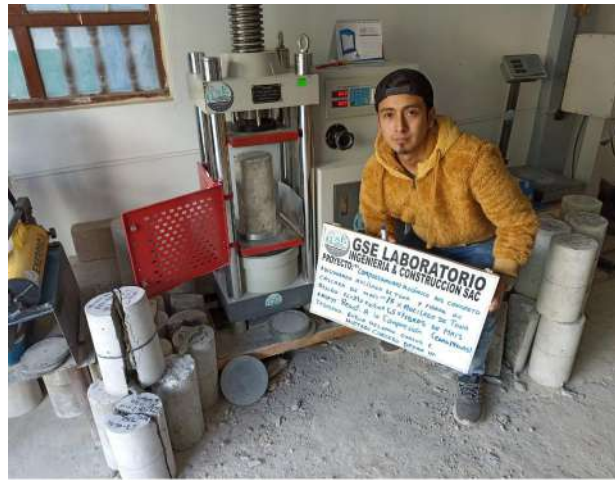
Fotografía 07. Ruptura de probeta en el ensayo de resistencia a la compresión.
