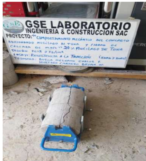
Fotografía 06. Ruptura de probeta en el ensayo de resistencia a la tracción.
