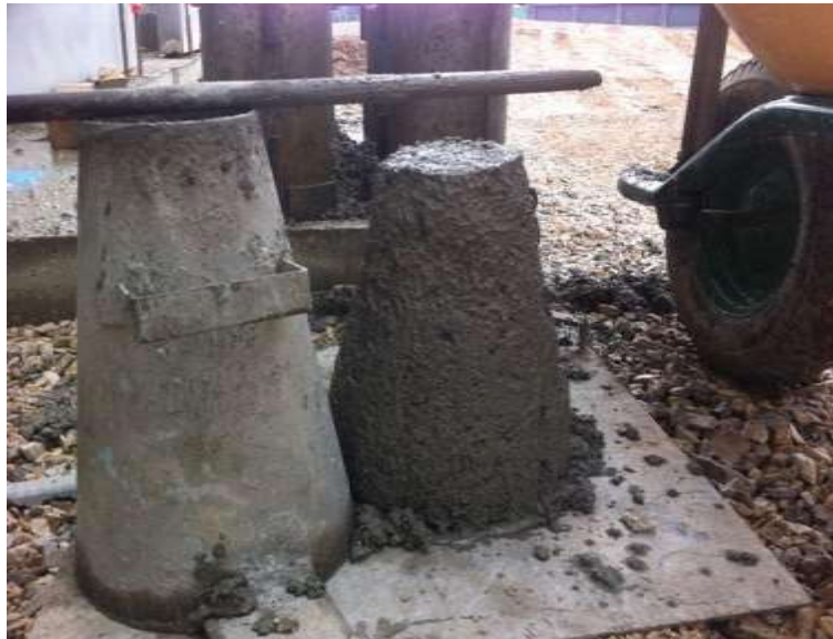
Fig. 1 Prueba de asentamiento del concreto. Adaptada de [43].
