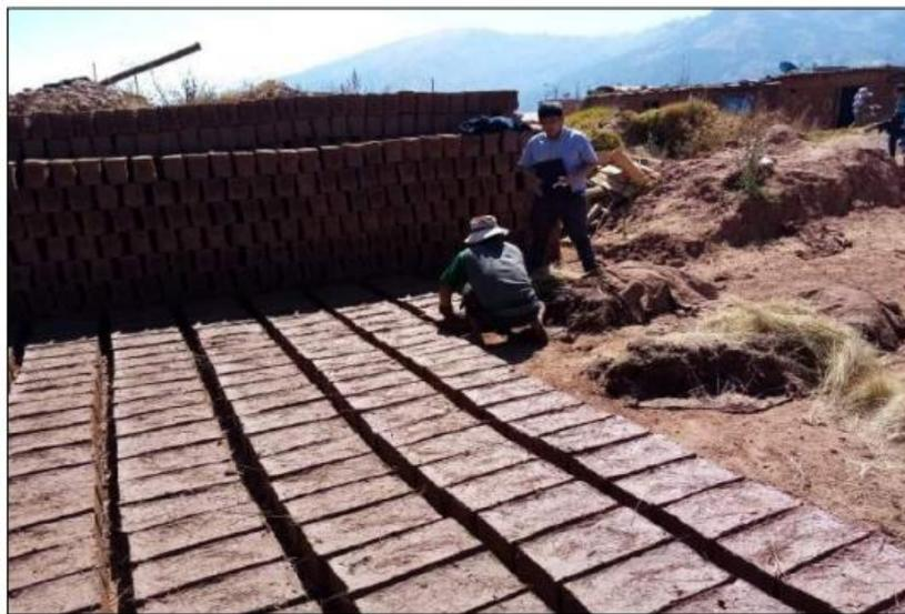
**Fig. 1.** Fabricación del adobe convencional
