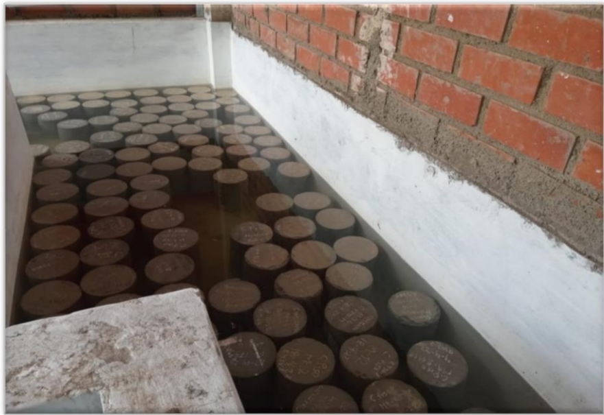
Fig. 28. Curado de muestras de concreto (Probetas cilíndricas y prismáticas)
