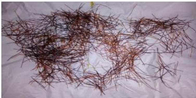
Fig. 1. Fibras de alambre de cobre de desecho eléctrico. [3]
