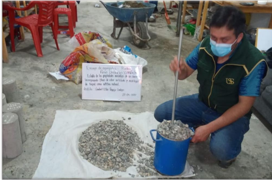
Fig. 21. Peso unitario compactado del agregado grueso.
