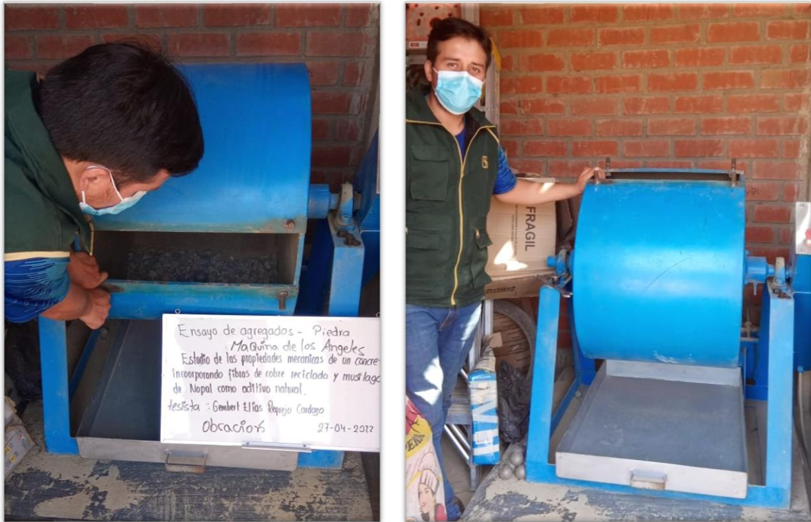
Fig. 23. Peso Específico y Absorción del Agregado grueso - Maquina de los ángeles.
