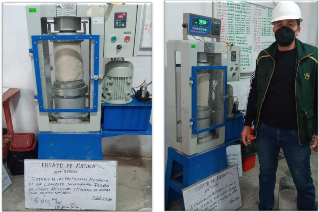
Fig. 27. Rotura de probetas cilíndricas de concreto.
