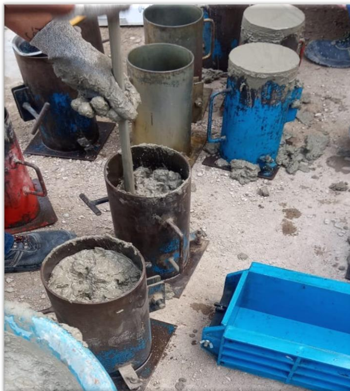
Fig. 25. Llenado de probetas cilíndricas de concreto.
