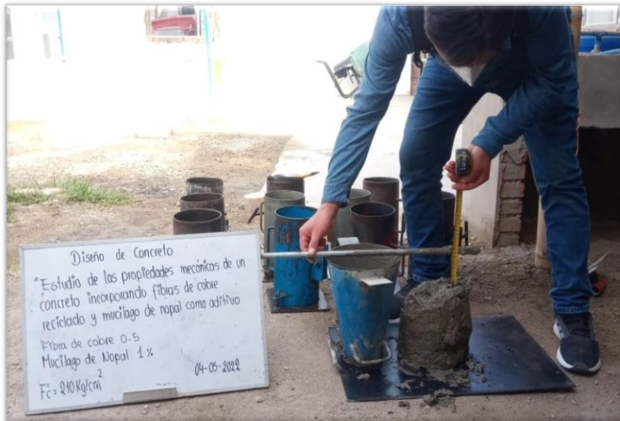
Fig. 24. Asentamiento del concreto.
