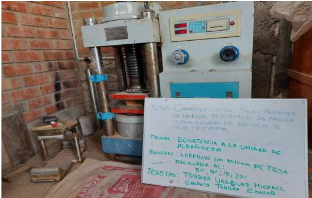
Anexo 2.27: resistencia a la compresión a unidades de albañilería.
