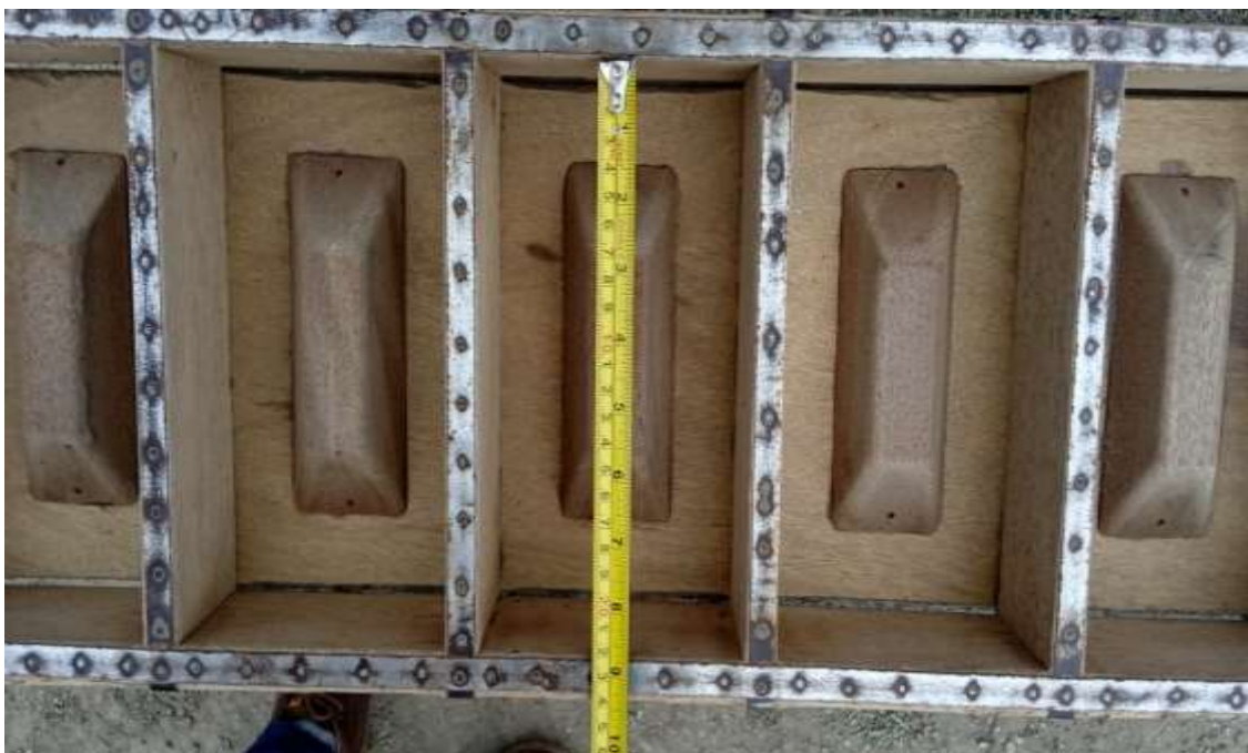
Anexo 2.8: Medición del molde de ladrillo artesanal con cinta métrica.
