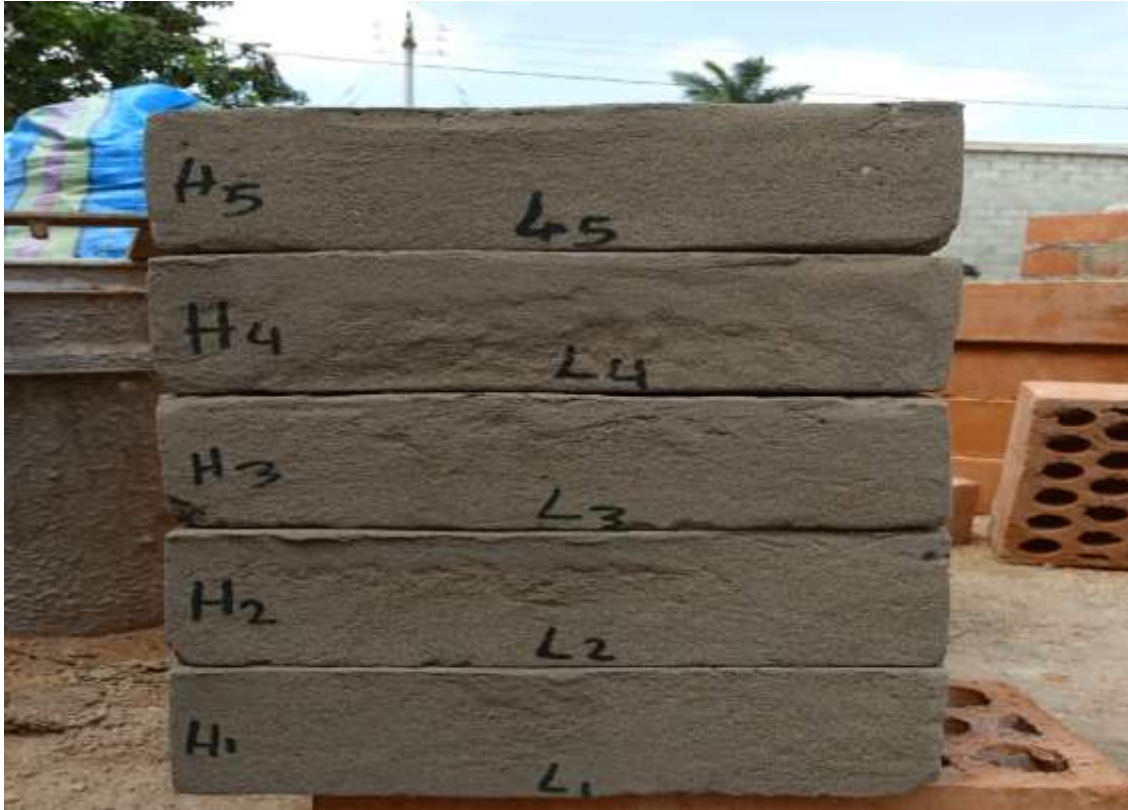
Anexo 2.11: Muestreo de las unidades de albañilería antes de ingresar al horno.
