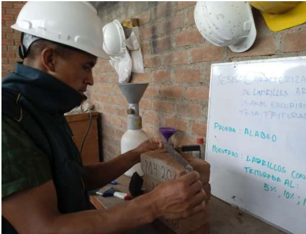
Anexo 2.23: Alabeo a unidades de albañilería adicionadas escorias de aluminio.
