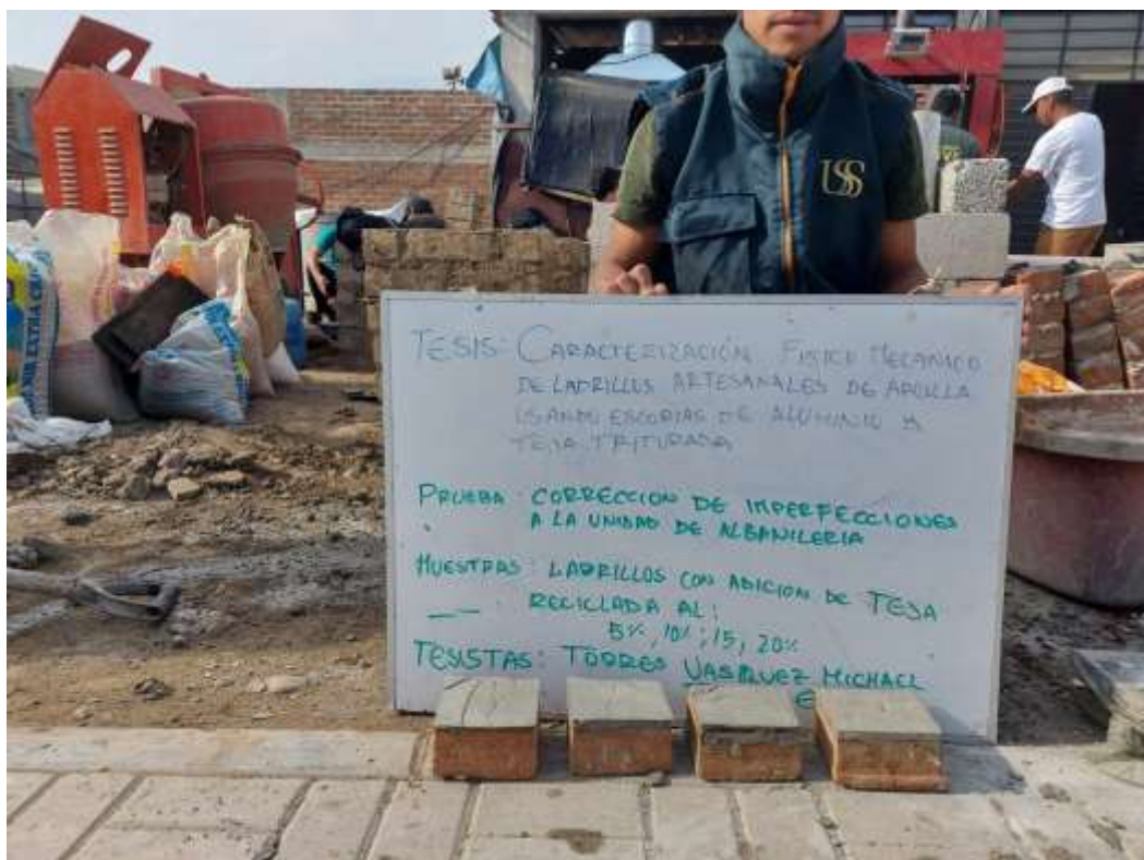
Anexo 2.26: nivelación de imperfecciones a unidades de albañilería.
