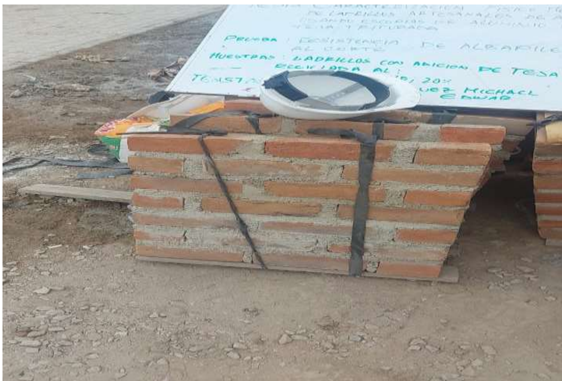
Anexo 2.16: Acopio de muretes para su traslado a laboratorio.
