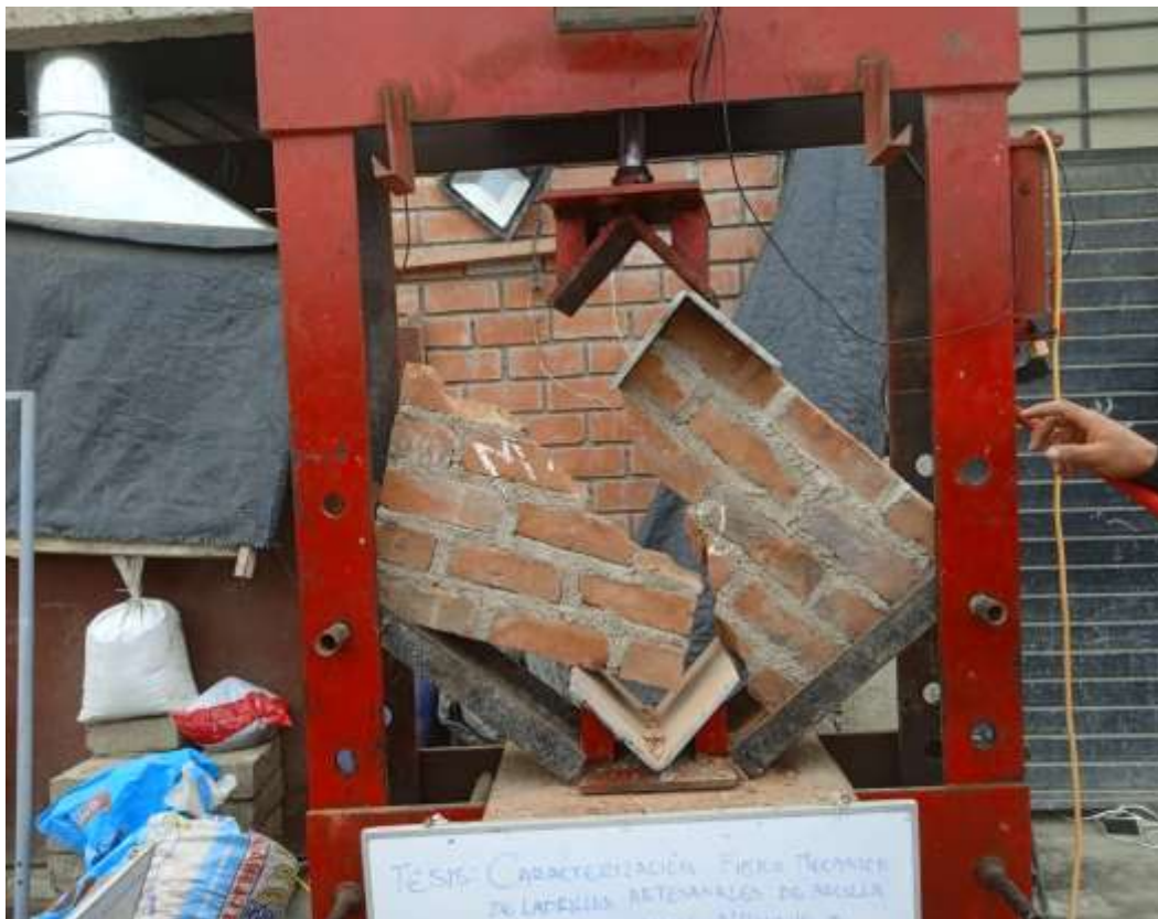
Anexo 2.30: fraccionamiento de muretes.
