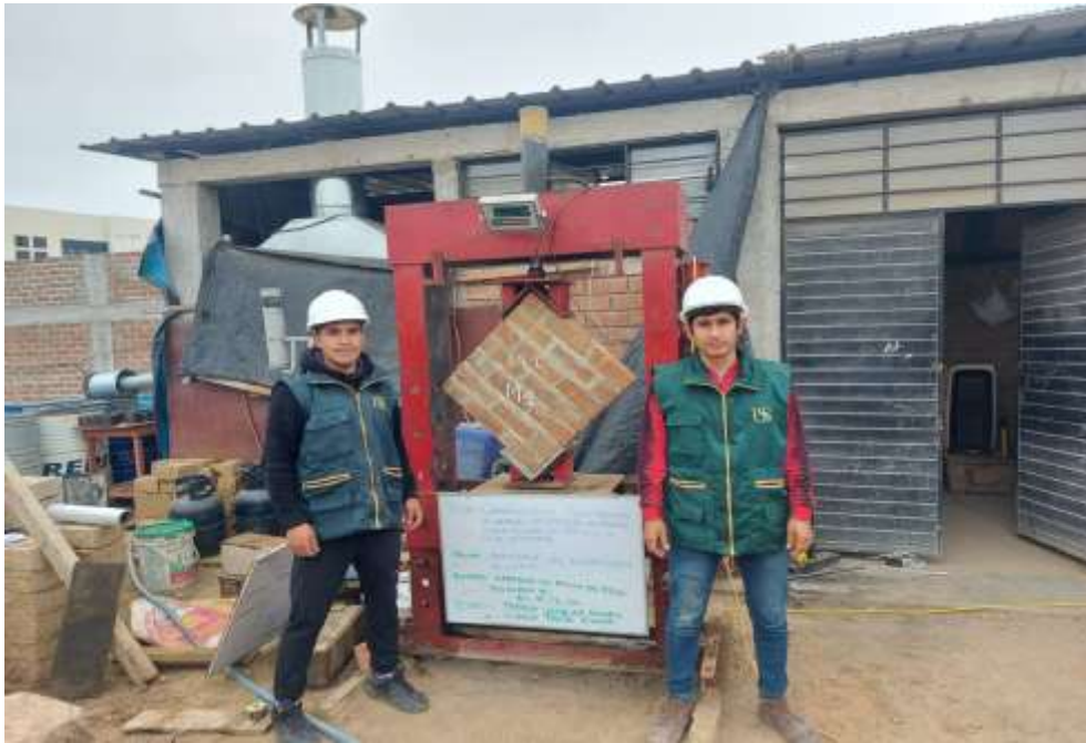
Anexo 2.29: resistencia a la compresión de muretes.
