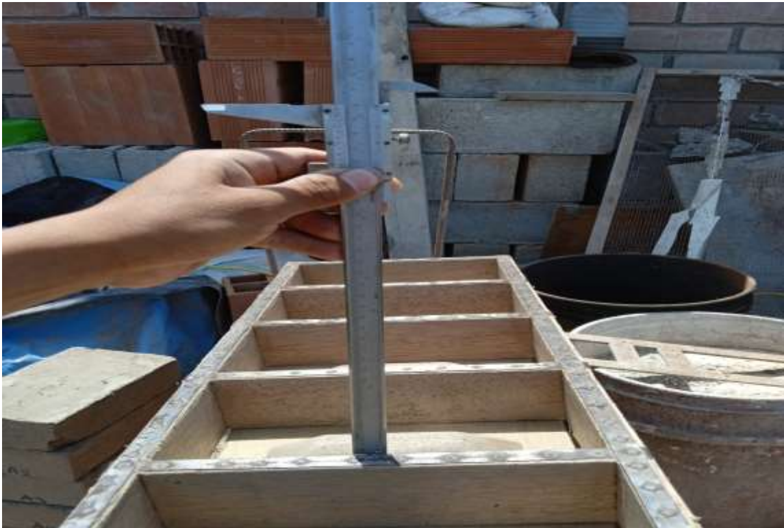
Anexo 2.7: Medición del molde de ladrillo artesanal con vernier.
