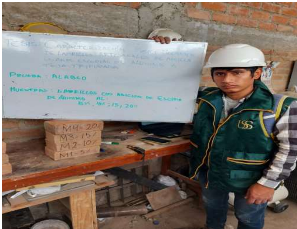
Anexo 2.24: Alabeo a unidades de albañilería adicionadas escorias de aluminio.
