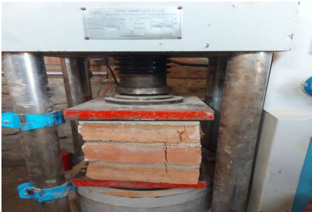
Anexo 2.28: resistencia a la compresión a pilas.
