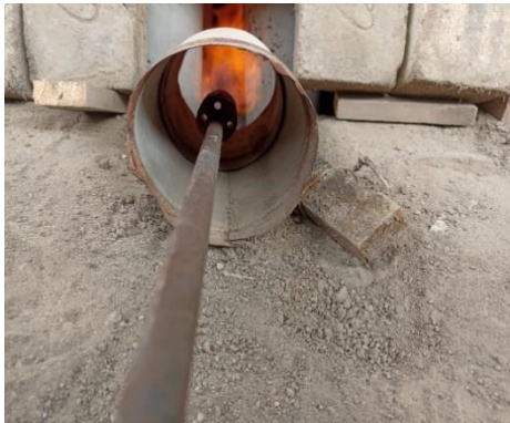
Fig 3: testigos de concreto expuestos al fuego
