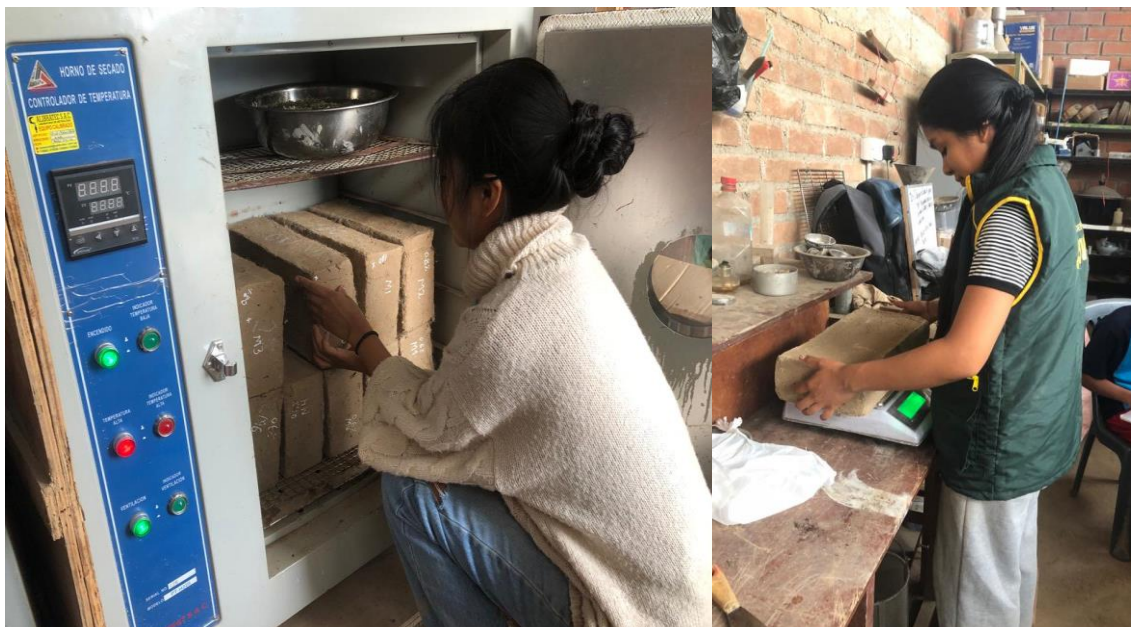
Fig. 38. Retirado del horno y peso de la unidad de adobe.
