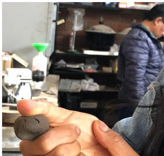
Fig. 18. Rotura de esferas de la muestra de Chongoyape.
