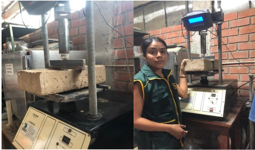
Fig. 36. Ensayo de resistencia a la flexión.
