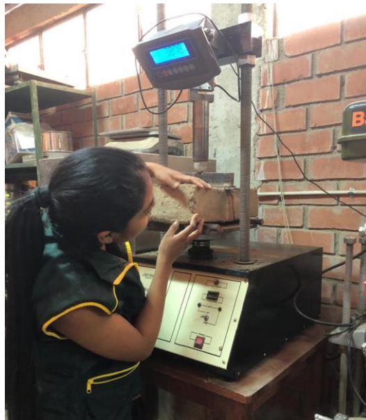
Fig. 37. Rotura de unidad de adobe a la flexión.
