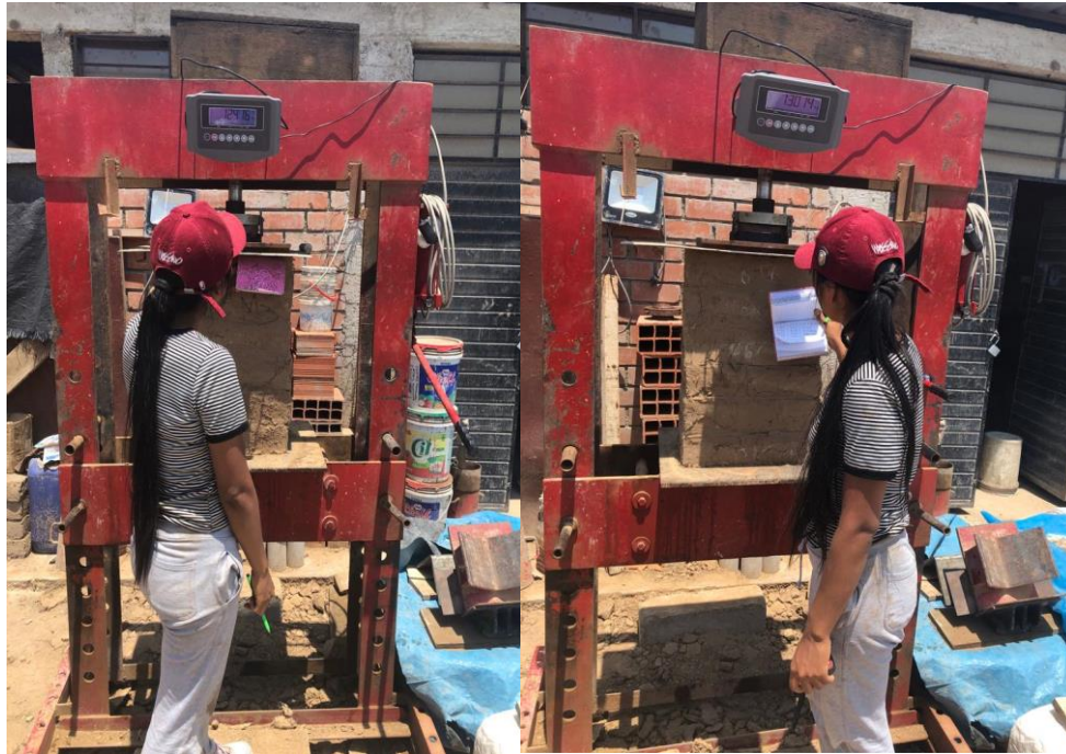
Fig. 40. Rotura de prismas a la compresión.
