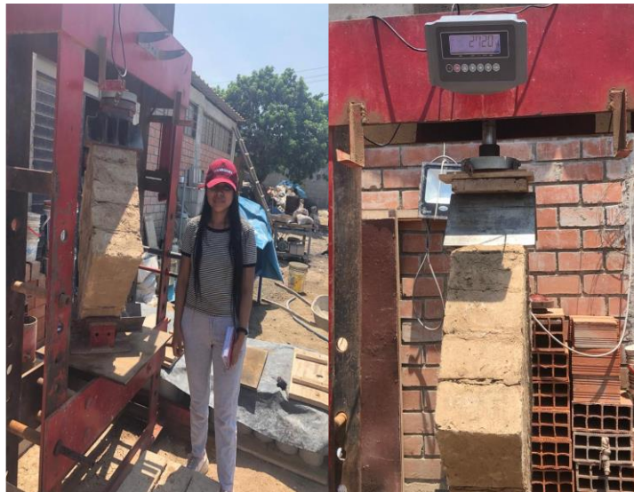
Fig. 41. Compresión diagonal en muretes.
