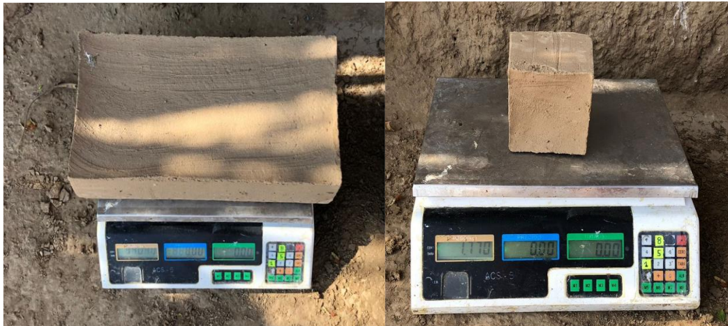
Fig. 25. Mezcla para adobe de prueba.
