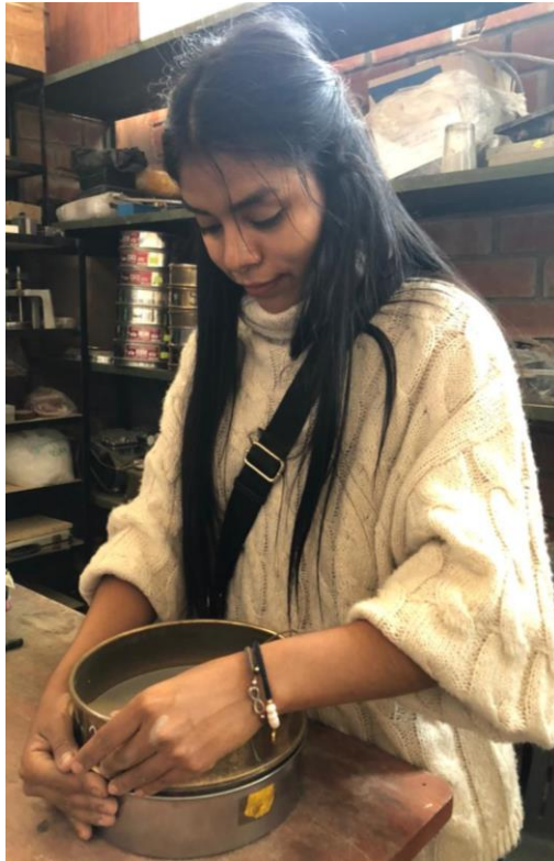
Fig. 20. Granulometría por tamizado.
