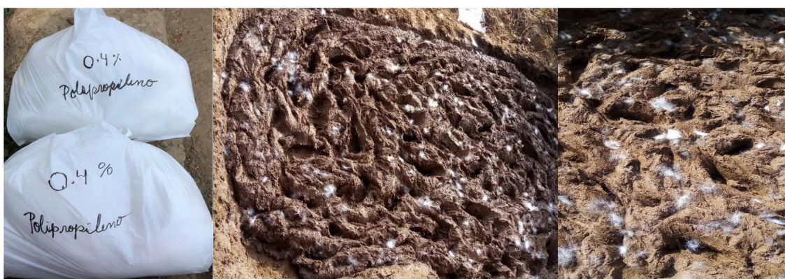
Fig. 33. Incorporación de las fibras a la mezcla.
