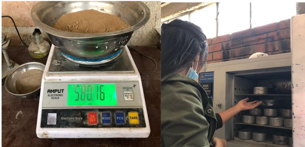
Fig. 21. Muestras para contenido de humedad colocadas al horno.
