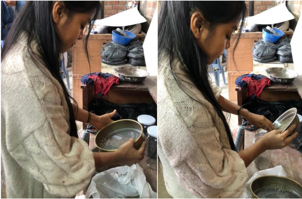
Fig. 8. Prueba de granulometría de campo.
