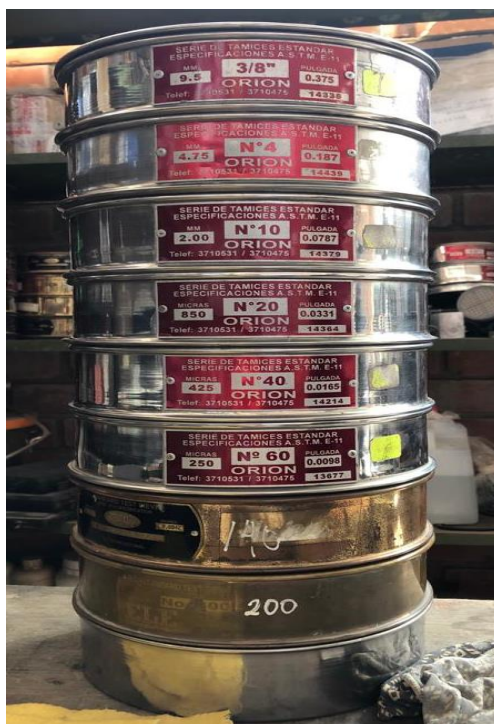
Fig. 1. Tamices empleados para el análisis granulométrico.
