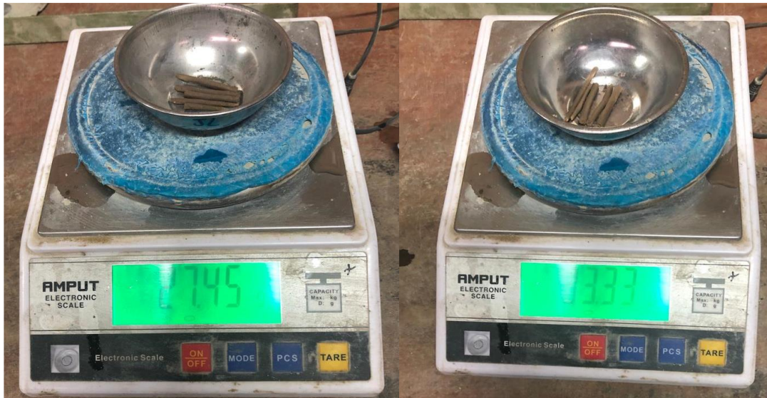
Fig. 24. Peso de muestra de limite plástico.
