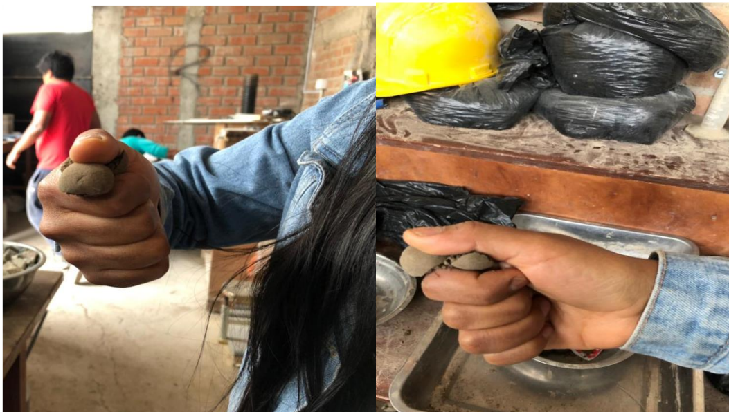
Fig. 15. Rotura de esferas de la muestra de La Cria.
