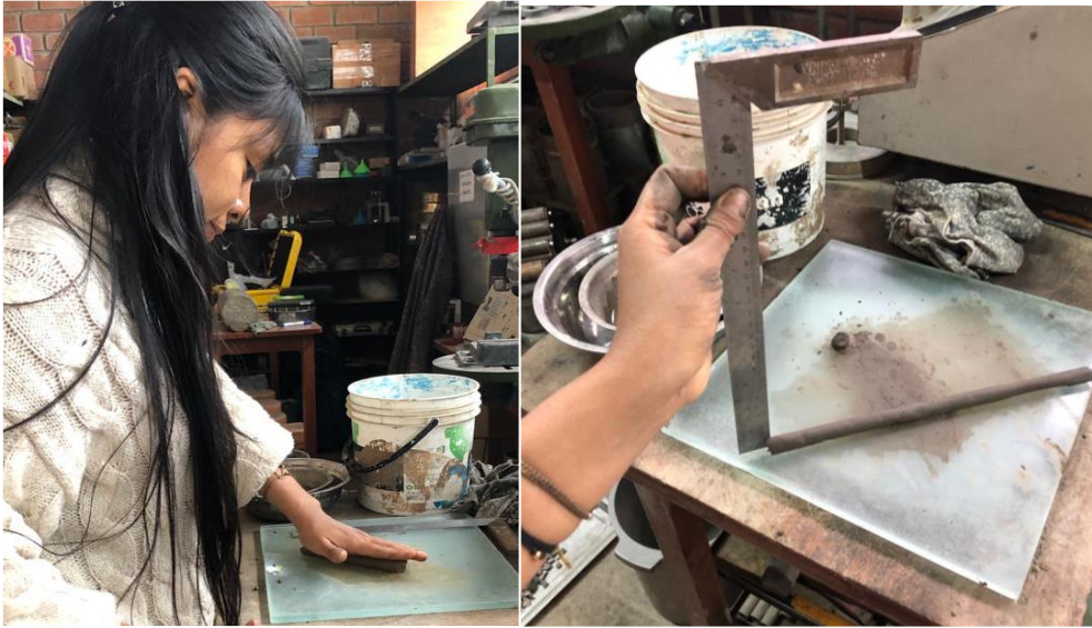
Fig. 11. Prueba de la cinta de barro.
