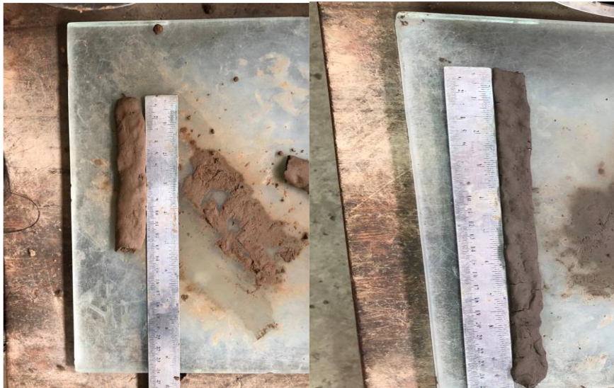
Fig. 13. Medición de la cinta de barro.
