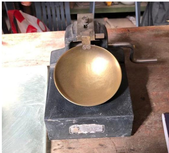
Fig. 2. Cuchara de Casagrande, para realizar el ensayo.
