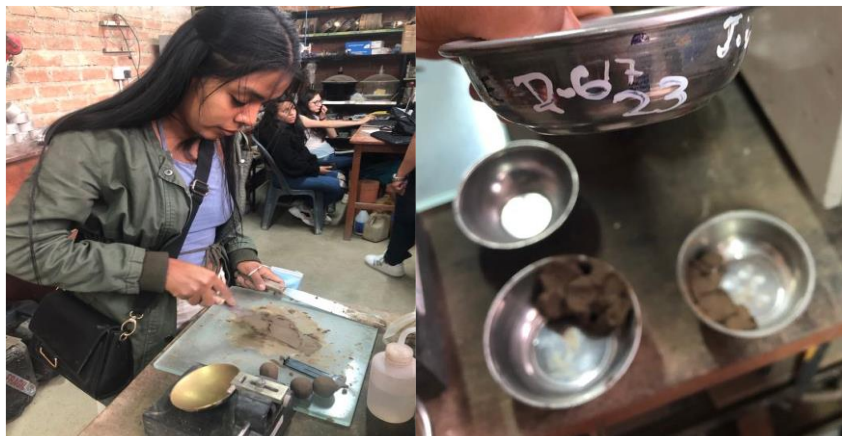
Fig. 22. Ensayo de límite líquido
