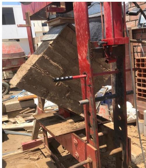
Fig. 42. Falla del murete.
