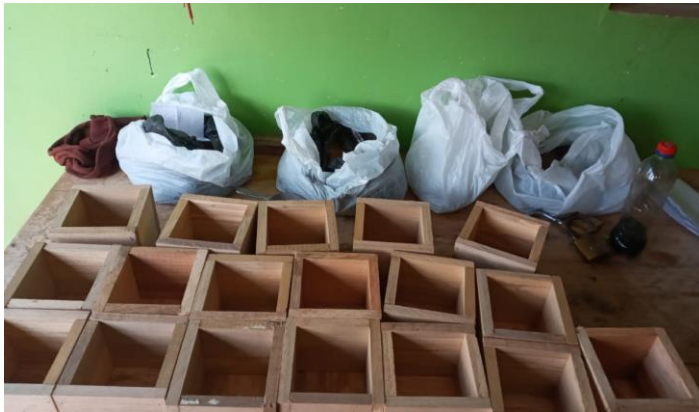
Moldes de madera y fierro para cubos de mortero
