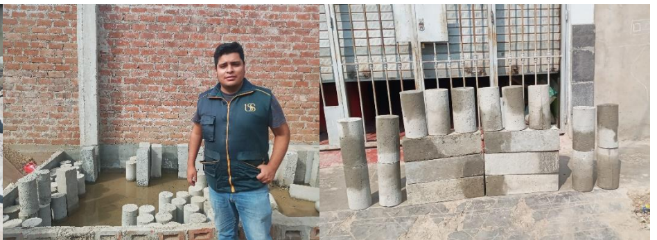
Curado de especímenes de concreto
