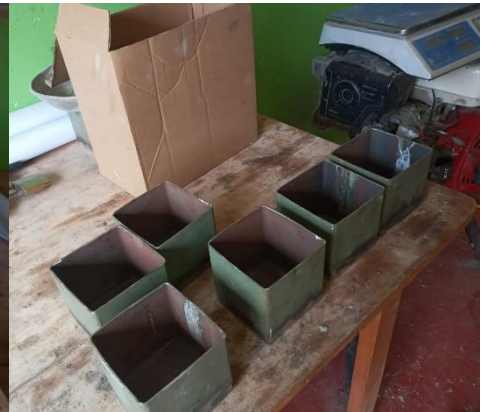
Moldes de madera y fierro para cubos de mortero
