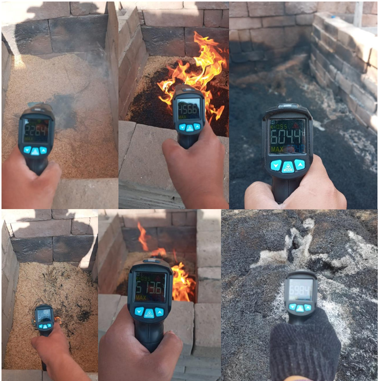
Control de temperatura durante el proceso de calcinado de la cascara de arroz
