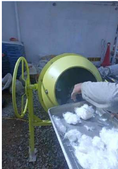
Fig. 12. Fibra de polipropileno añadida a la mezcla.
