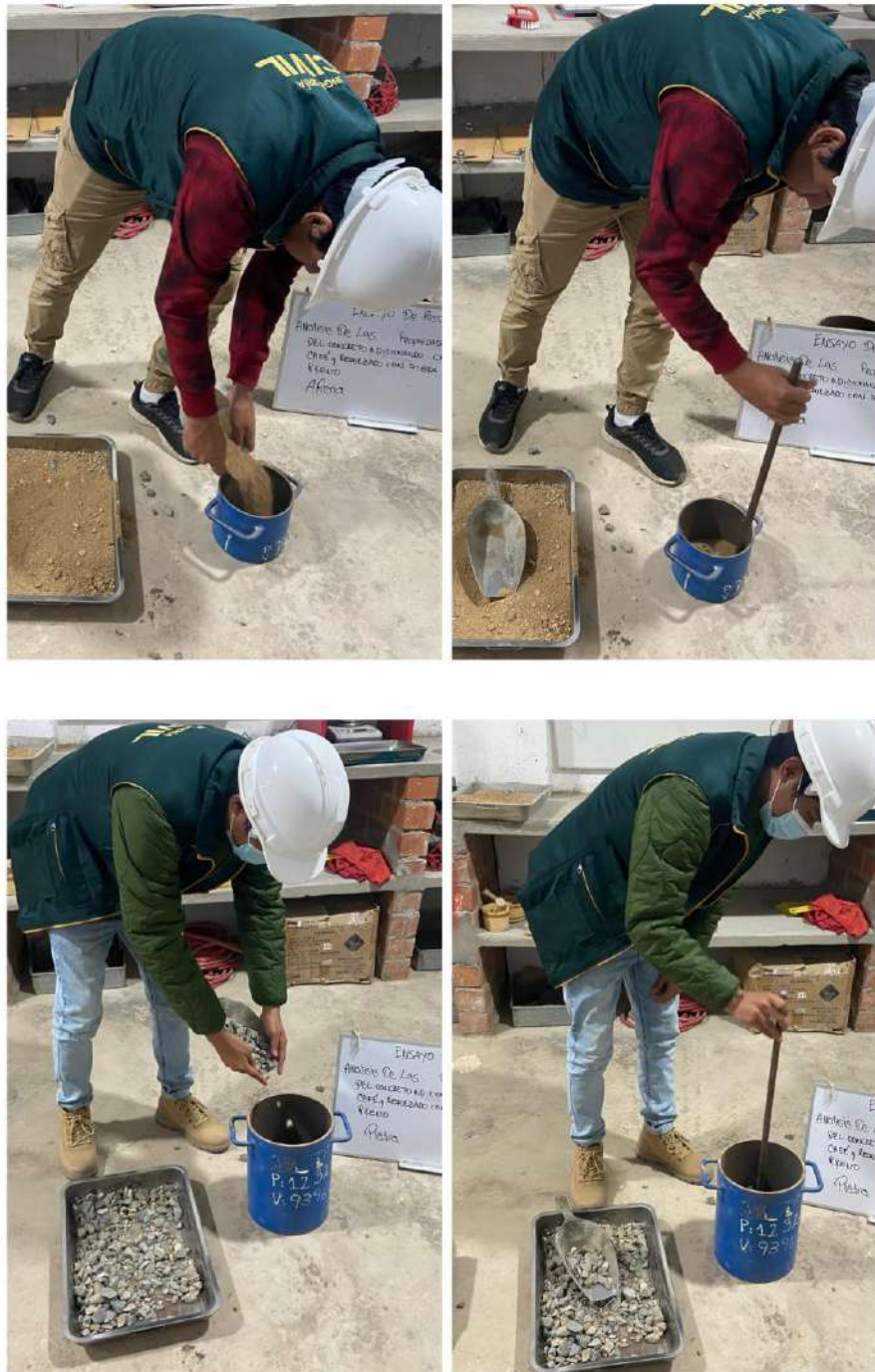
Fig. 43. Ensayo de peso unitario suelto y compactado del agregado.
