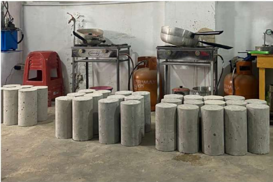
Fig. 46. Elaboración de las muestras de concreto
