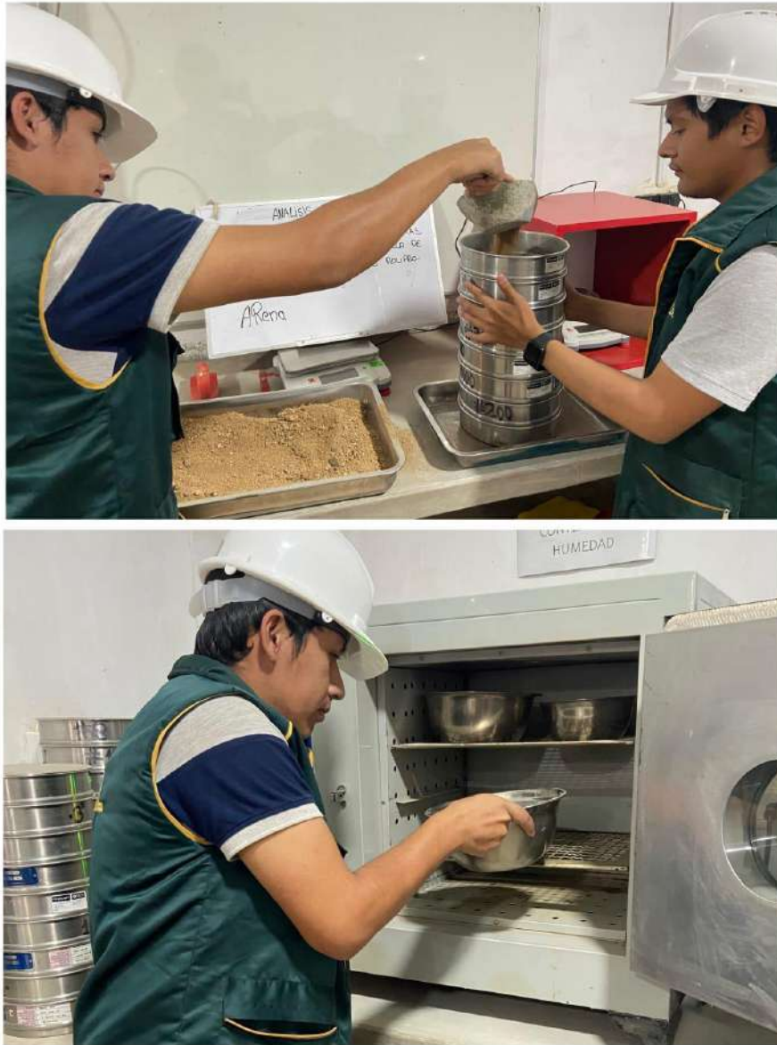
Fig. 44. Ensayo de peso específico, absorción y contenido de humedad de los agregados.
