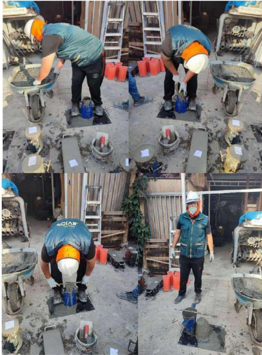
Realización del ensayo de SLUMP
