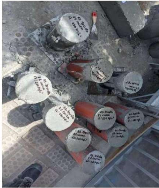
Testigos de concreto terminados
