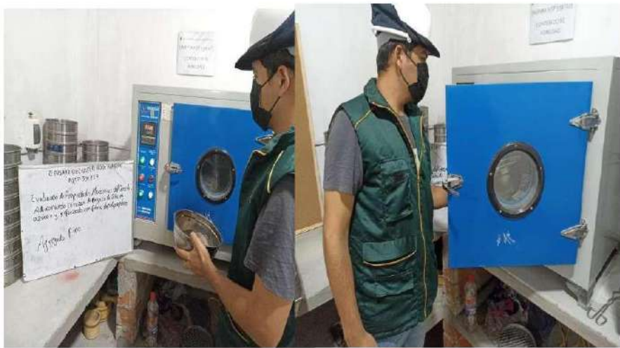
Secado de la muestra de agregado Grueso
