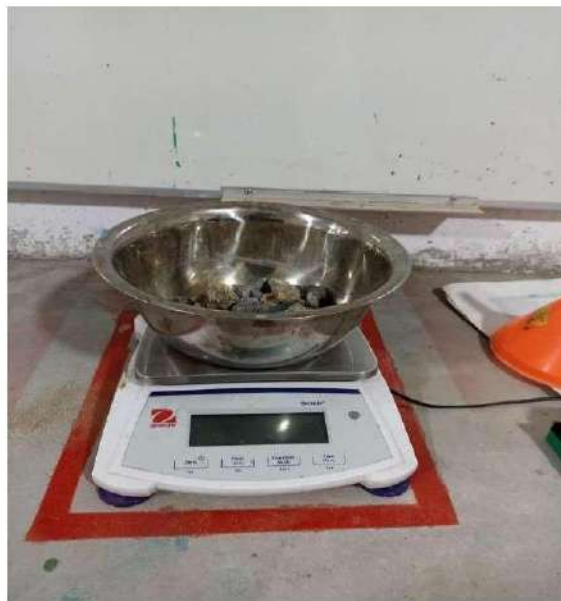
Pesado de la muestra de agregado grueso luego de ser introducido al horno
