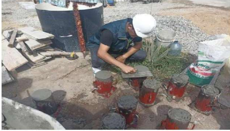
Llenado de testigos con la mezcla de concreto con adición de CBCA
