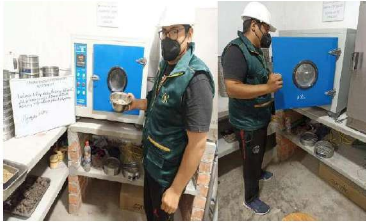
Secado de la muestra de agregado Fino
