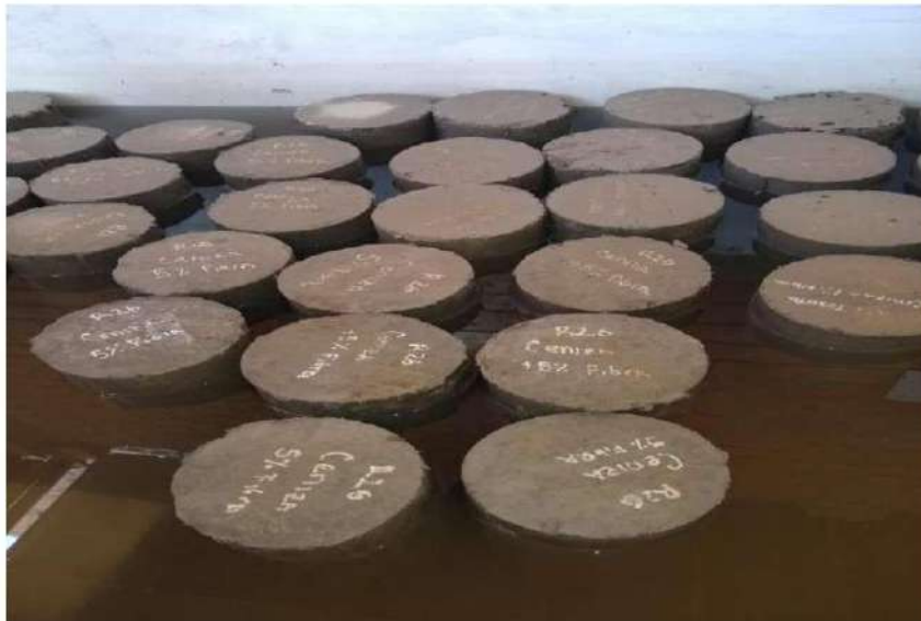
Curado de testigos de concreto con adición de ceniza
