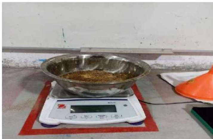
Pesado de la muestra de agregado fino luego de ser introducido al horno
