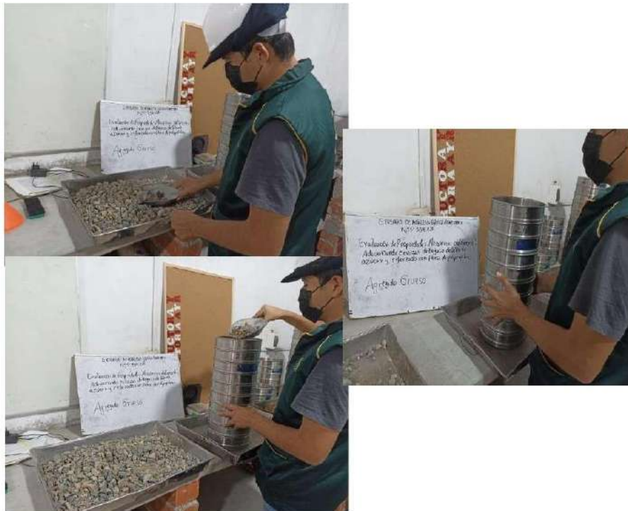
Pasado de la muestra de agregado grueso por el juego de tamices y posterior agitado para que la muestra pase por cada tamiz
