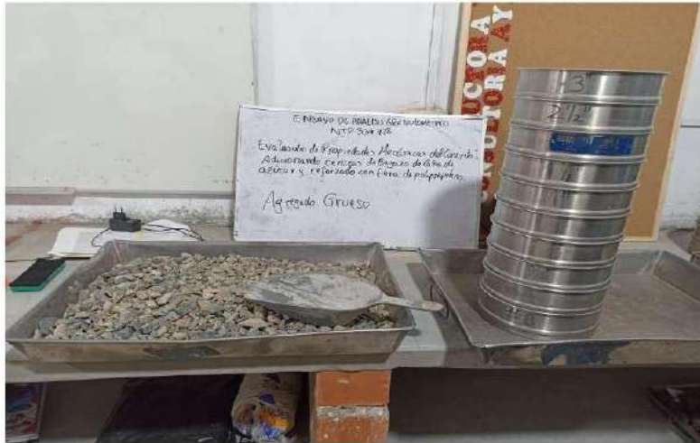
Ensayo granulométrico de Agregado Grueso
