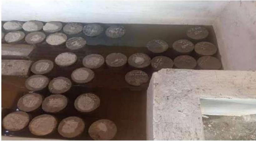
Curado de testigos de concreto con incorporación de FP
