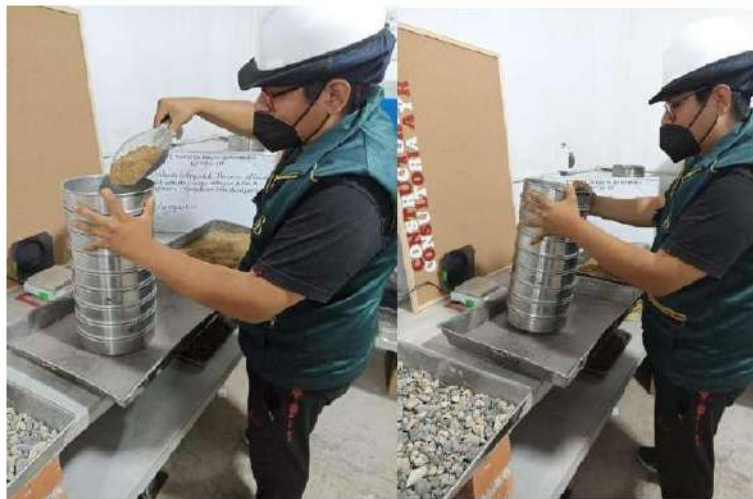
Pasado de la muestra de agregado fino por el juego de tamices y posterior agitado para que la muestra pase por cada tamiz
