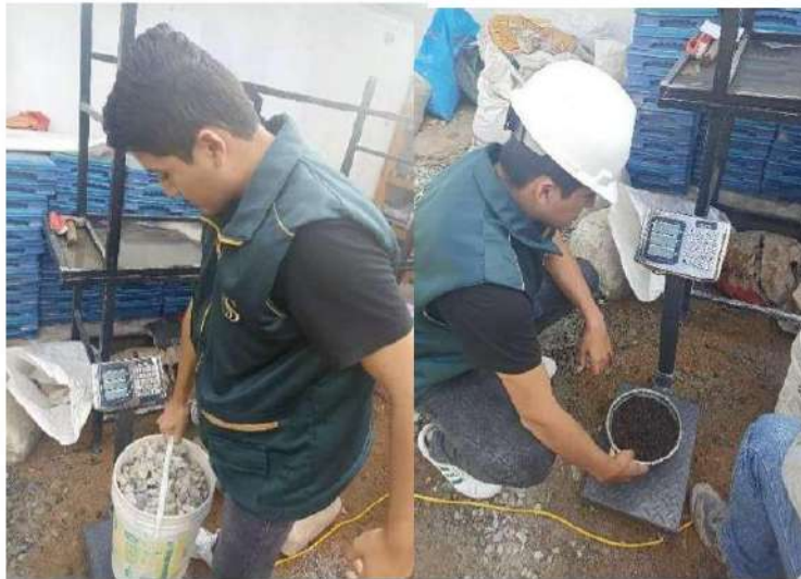
Pesado de material a utilizar en la mezcla de concreto con adición de ceniza
