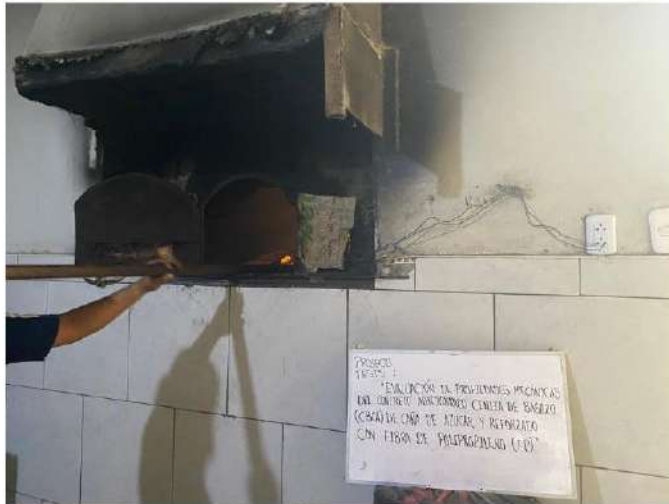
Obtención de ceniza de bagazo de caña de azúcar mediante la quema de la fibra de la caña de azúcar
