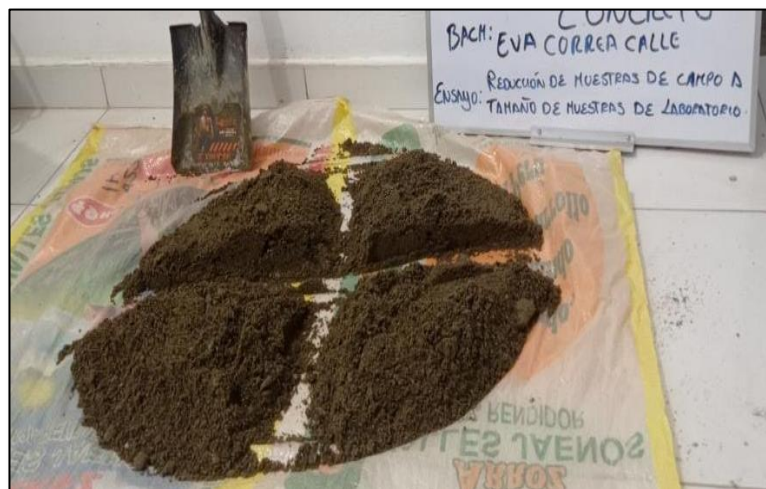
Figura 45: Ensayo de reducción de muestras de campo a tamaño de muestras de laboratorio del agregado fino
