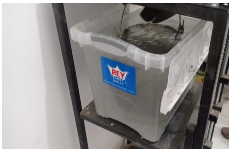
Fig.19. Ensayo de absorción y peso específico de la arena
