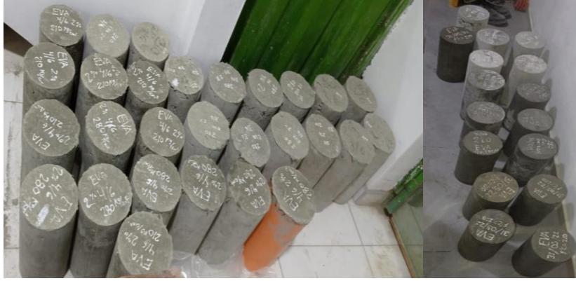
Fig.27. Testigos de concreto cilíndricos de concreto endurecido con y sin adiciones de f'c=210 y 280 \text{ kg/cm}^2
