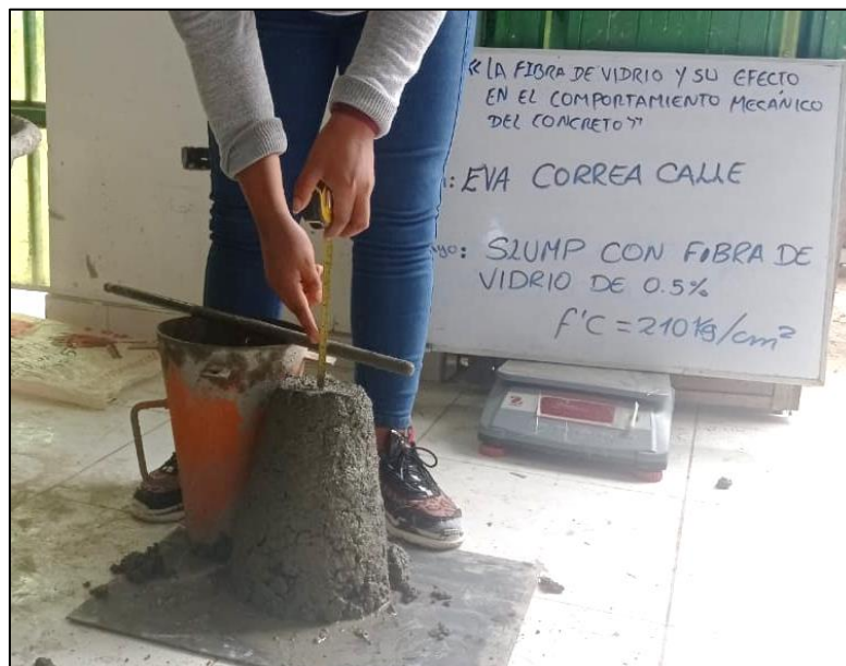
Figura 53: Medición del asentamiento, verificando que este en el rango 3" a 4" – Concreto Patrón + adición de 0.5%, 1%, 2%, 3% de fibra de vidrio.
