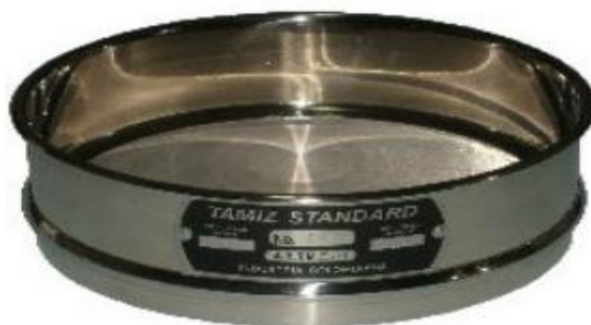
Fig.21. Material tamizado que pasa por la malla normalizada N°200
