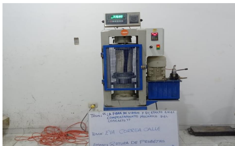
Fig.30. Probeta para ser sometida al ensayo de compresión
