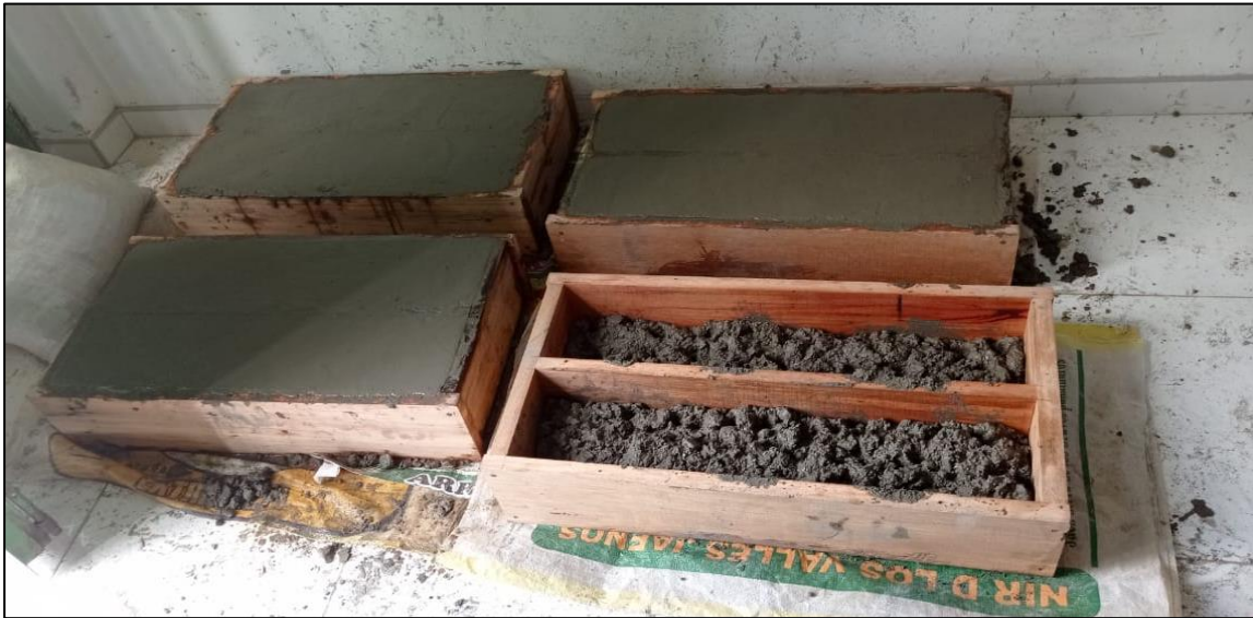
Figura 57: Elaboración de probeta prismáticas de concreto patrón de resistencia f'c = 210 \text{kg/cm}^2 y f'c = 280 \text{kg/cm}^2
