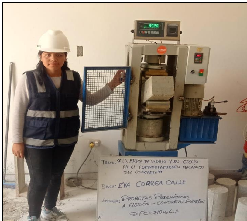
Figura 64: Muestras ensayadas por el ensayo de resistencia a la flexión concreto patrón
