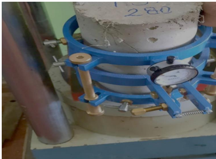
Fig.33. Probeta para ser sometida al ensayo módulo de elasticidad
