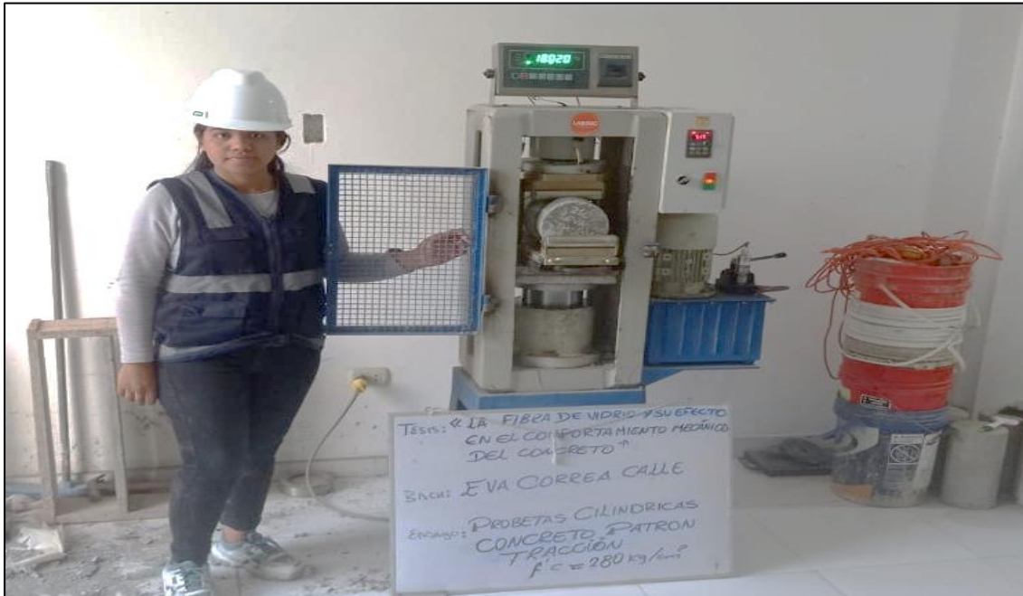
Figura 62: Muestras de concreto patrón ensayadas por el ensayo de resistencia a la compresión diametral – Tracción
