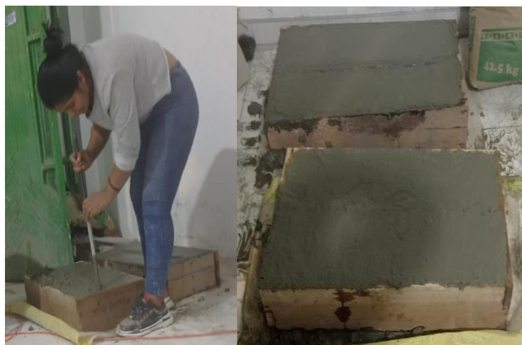
Fig.25. Testigos de vigas de concreto para medir su asentamiento
