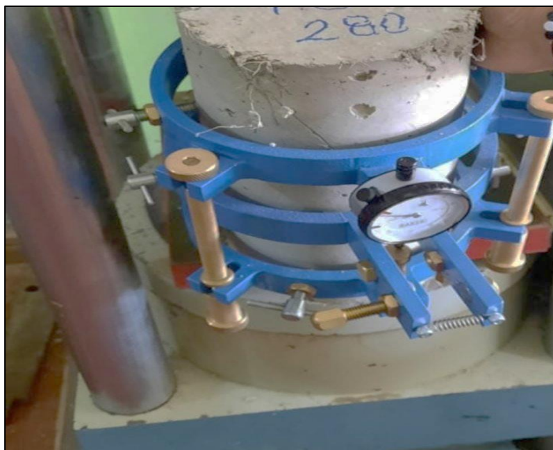
Figura 66: Muestra de concreto patrón y con adición de fibra de vidrio dentro de la máquina del módulo de elasticidad.
