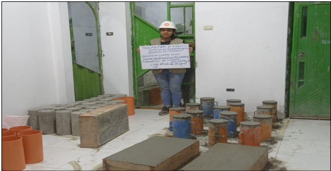
Figura 58: Elaboración de probeta cilíndricas y prismáticas de concreto patrón de resistencia f'c = 210 \text{kg/cm}^2 y 280 \text{kg/cm}^2 con adición de fibra de vidrio.
