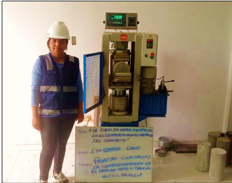
Figura 63: Muestra de concreto con adición de fibra de vidrio-Compresión por Tracción
