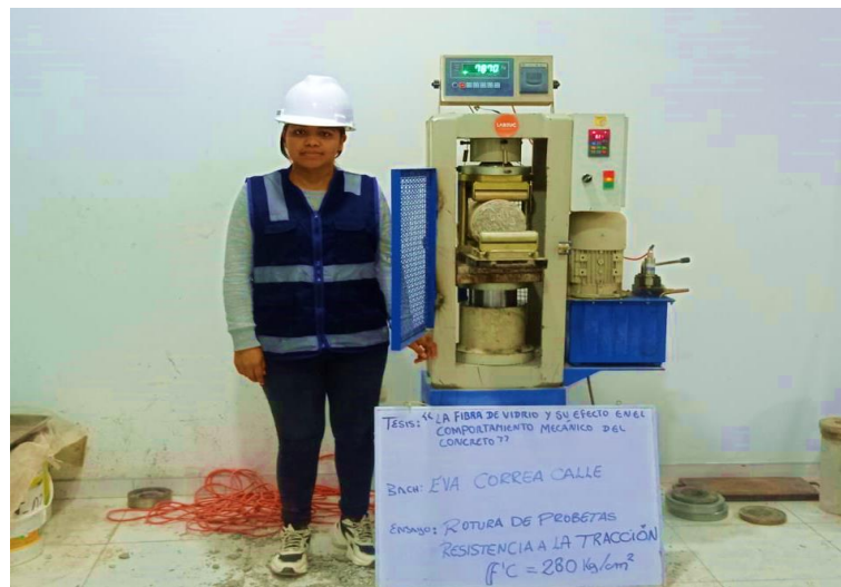
Fig.31. Probeta para ser sometida al ensayo a tracción
