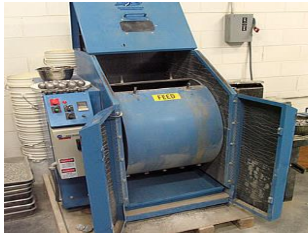
Fig.22. Ensayo de abrasión en la máquina de los Ángeles
