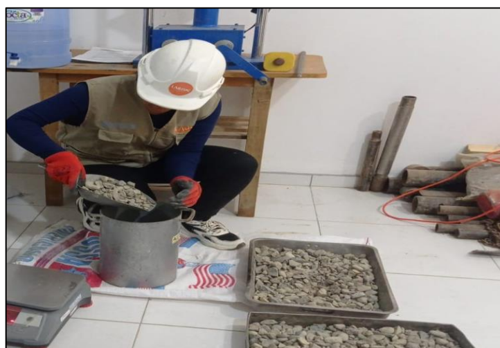
Figura 48: Ensayo de peso unitario suelto del agregado suelto para el Agregado grueso
