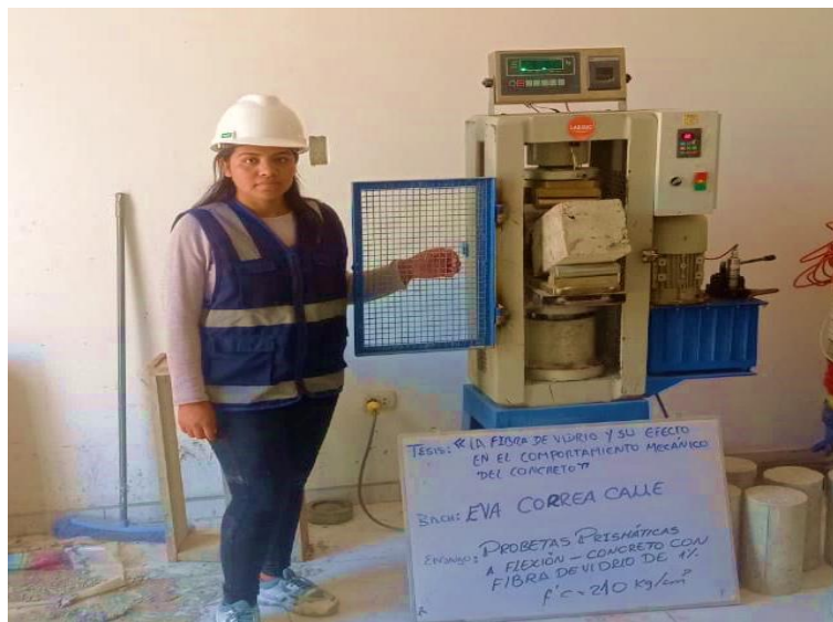
Fig.32. Probeta para ser sometida al ensayo a flexión
