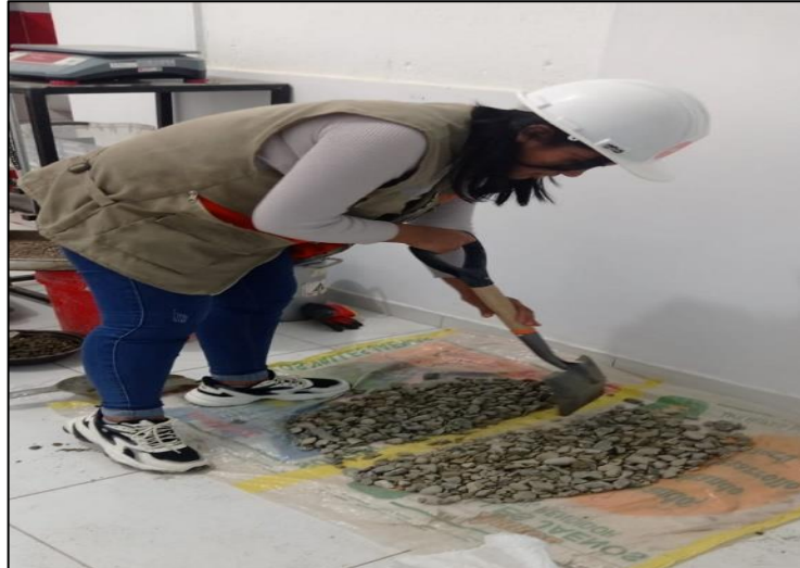
Figura 46: Ensayo de reducción de muestras de campo a tamaño de muestras de laboratorio del agregado grueso
