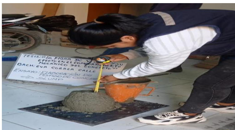
Fig.29. Medición del asentamiento del concreto
