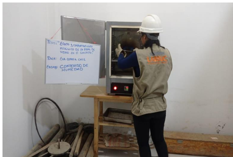
Fig.18. Contenido de Humedad
