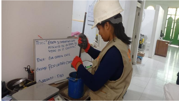
Fig.14. Peso Unitario suelto compactado de la arena
