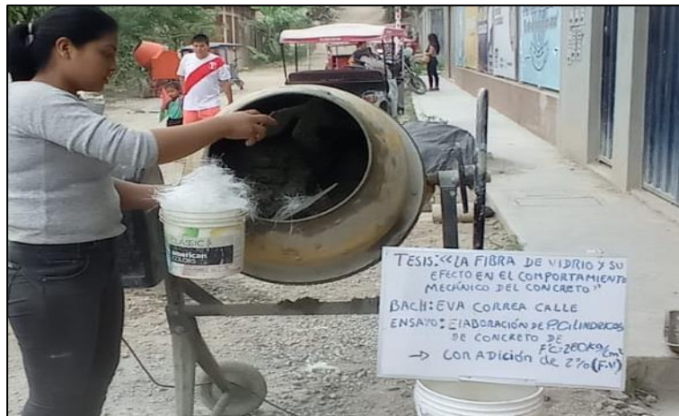
Figura 55: Adición de la fibra de vidrio al concreto para la determinación óptima
