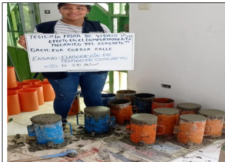
Figura 56: Elaboración de probeta cilíndricas de concreto patrón de resistencia f'c 210 kg/cm 2
