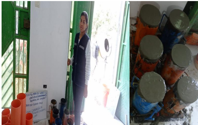
Fig.24. Testigos de concreto cilíndricos para medir su asentamiento
