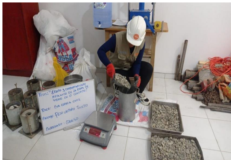
Fig.16. Peso Unitario suelto compactado de la piedra
