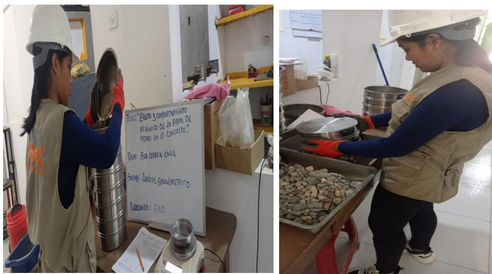
Fig.12. Ensayo de granulometría por tamizado de los áridos
