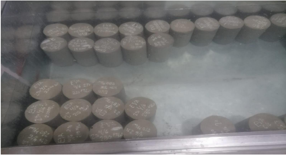
Figura 61: Curado de probetas de concreto sumergidas hasta la fecha de rotura
