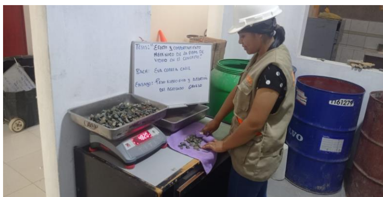
Fig.20. Ensayo de absorción y peso específico del agregado grueso
