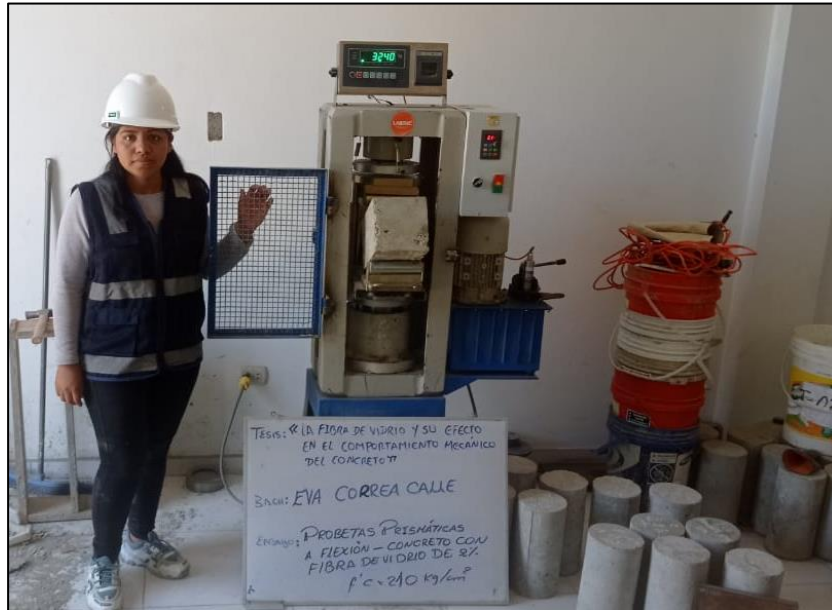
Figura 65: Muestras ensayadas por el ensayo de resistencia a la flexión concreto patrón + la adición de fibra de vidrio
