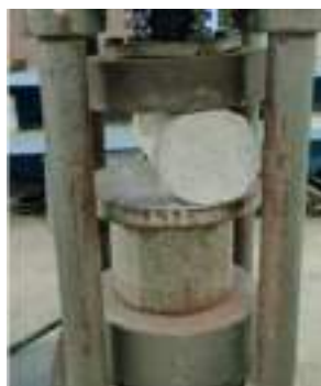
Fig. 6. Prueba del cilindro para resistencia a la tracción partida
