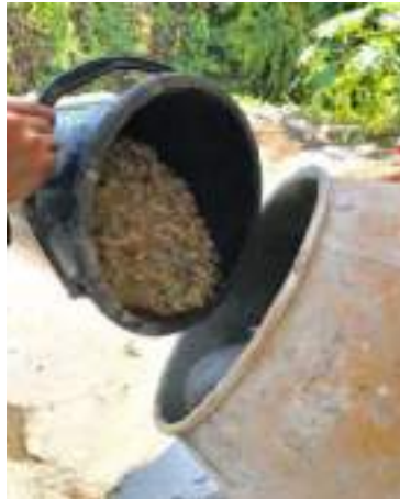
Fig. 5. La fabricación del bloque de concreto PET.
