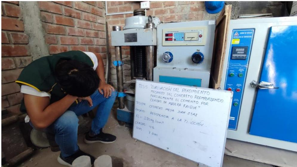
c) Ensayo de módulo de elasticidad  $f'_c = 210\text{kg/cm}^2$  y  $280\text{kg/cm}^2$
