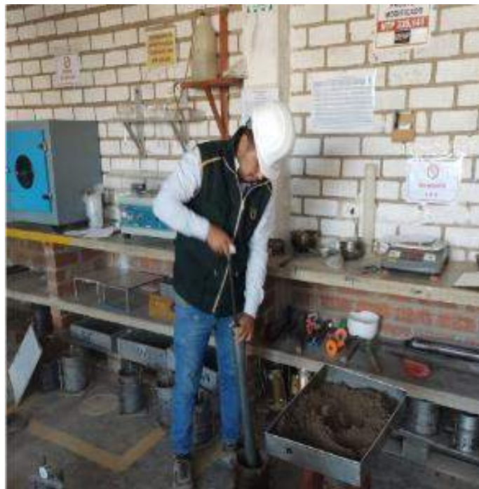
Fotografía 20: Golpes de compactación por capas para el Proctor Modificado.
