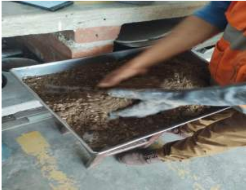
Fotografía 23: Preparación de la muestra de suelo natural para ser incorporado con el SBCA.
