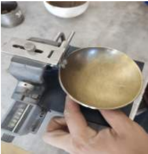
Fotografía 14: Preparación para los ensayos de Límites de Atterberg.
