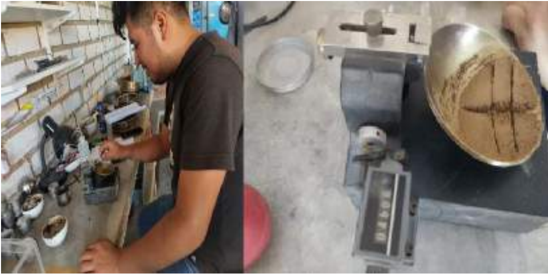
Fotografía 15: Preparación para los ensayos de Límite líquido.
