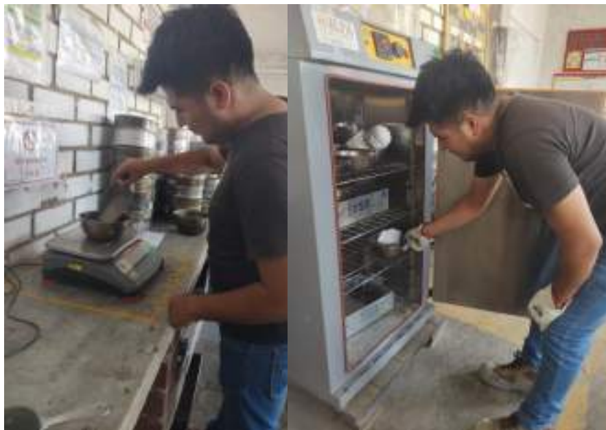
Fotografía 10: Ensayo del contenido de Humedad pesando la muestra, luego ubicándolo al horno la muestra húmeda.
