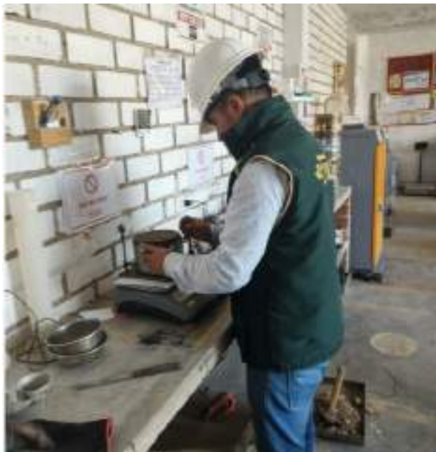
Fotografía 18: Peso del molde y la muestra de suelo, ensayo de Proctor Modificado.
