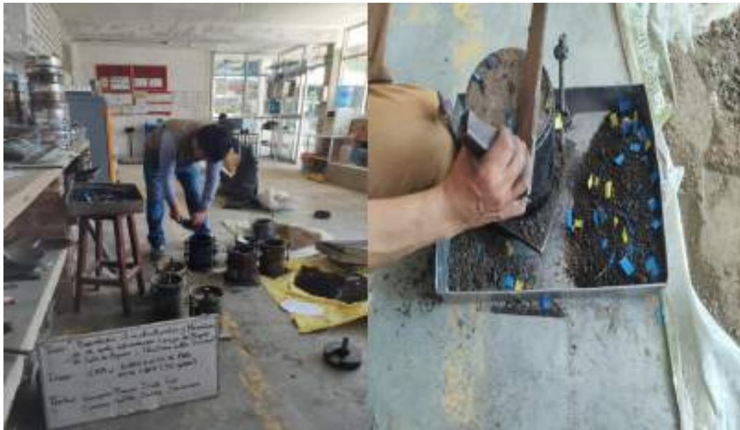
Fotografía 28: Ensayo de Proctor Modificado, incorporando el 10% de SBCA, y HDPE 0.50%.
