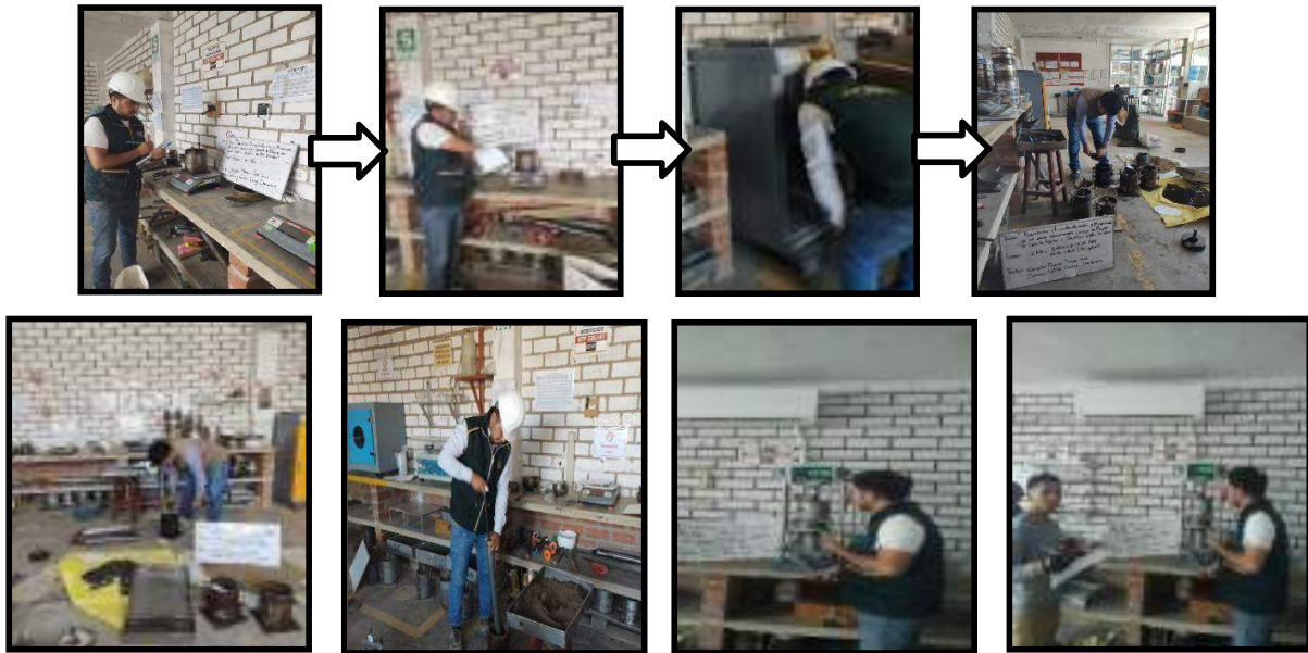
Fig. 11. Procedimiento del ensayo del CBR con el suelo convencional.
