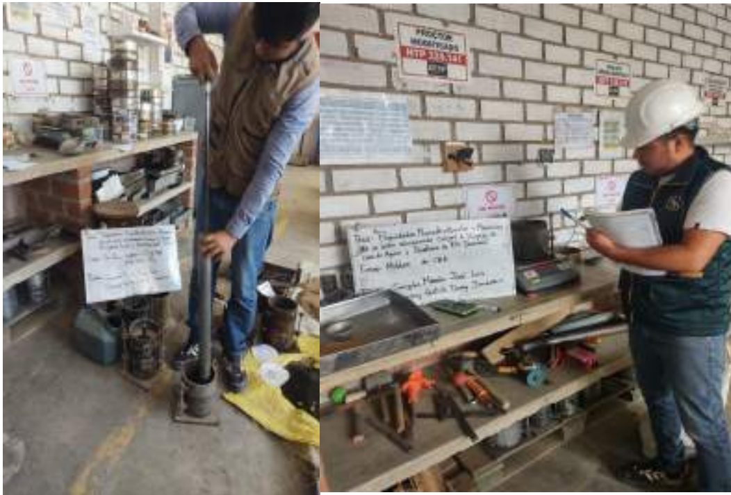
Fotografía 31: Ensayo de CBR incorporando SBCA y HDPE.
