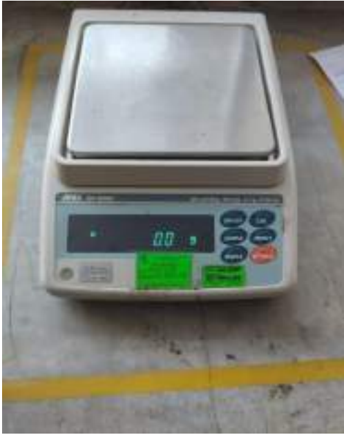
Fotografía 13: Balanzas utilizada para los ensayos de limite líquido y plástico del suelo, ensayo de límites de Atterberg.
