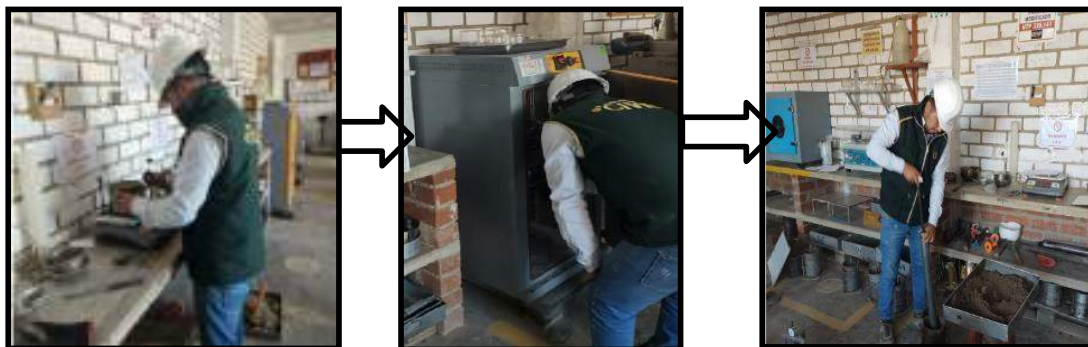
Fig. 10. Procedimiento del ensayo Proctor modificado con el suelo convencional.
