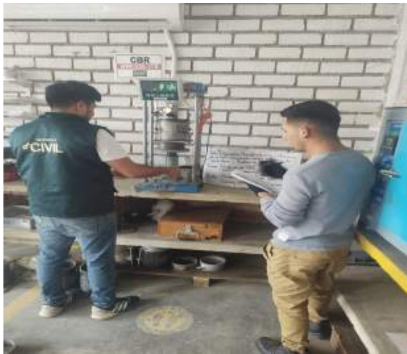
Fotografía 34: Toma de lectura de muestra M2 de CBR incorporando SBCA
