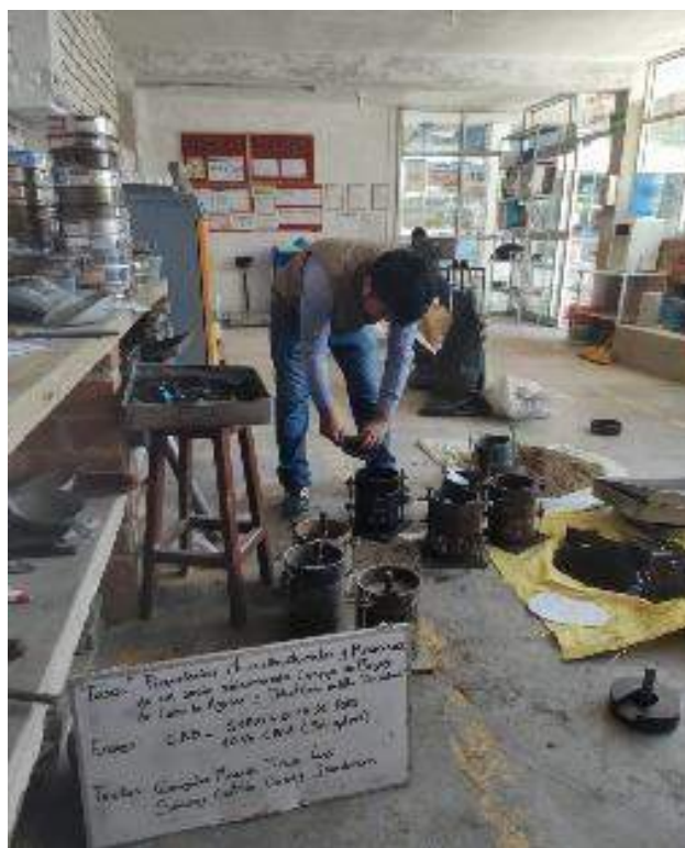
Fotografía 26: Ensayo de CBR con el SBCA, incorporando el 15%.
