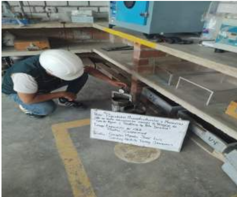
Fotografía 39: Ensayo de CBR incorporando SBCA y HDPE.
