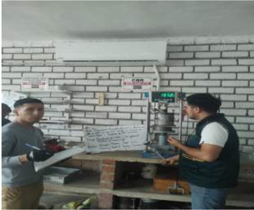
Fotografía 33: Lecturas de CBR incorporando SBCA y HDPE.
