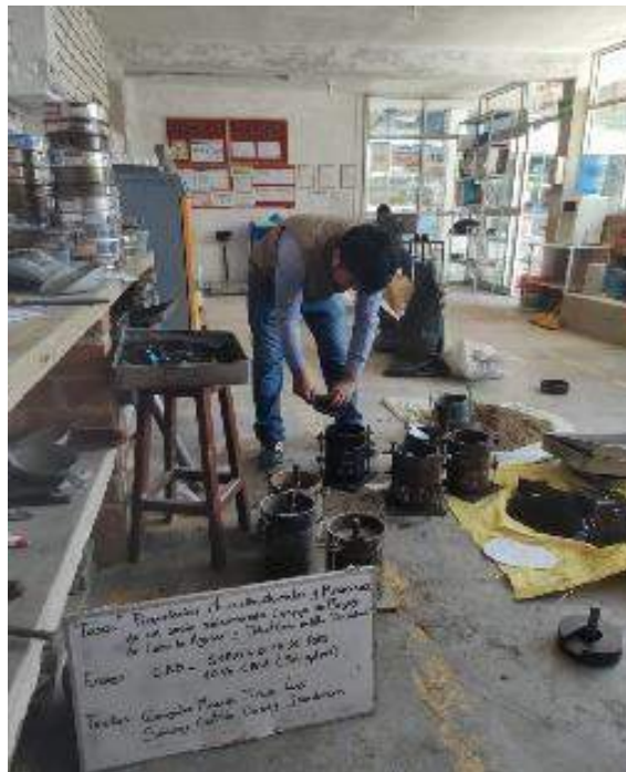
Fotografía 22: Ensayo de CBR, del suelo natural.
