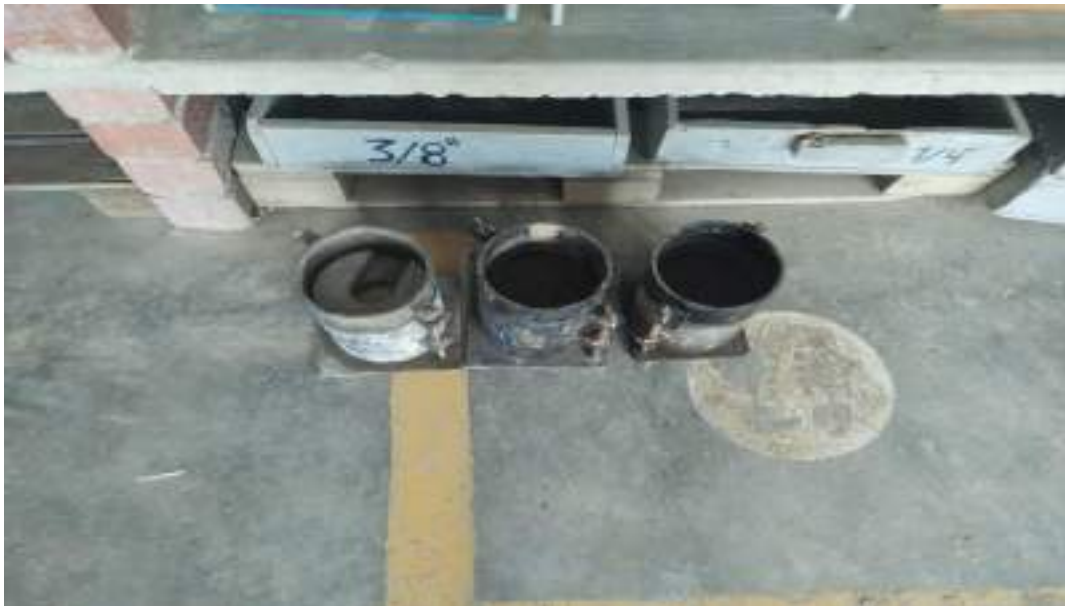
Fotografía 30: Moldes para hacer el ensayo de CBR incorporando SBCA y HDPE.
