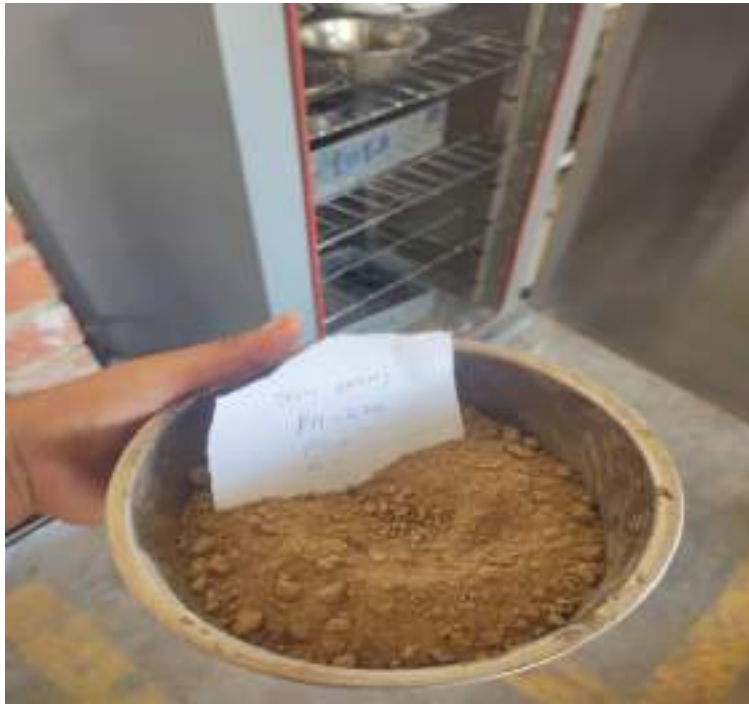
Fotografía 11: Ensayo del contenido de humedad, extrayendo la muestra seca después de 24 horas.
