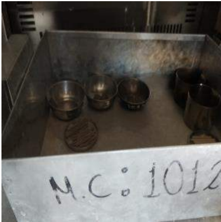
Fotografía 17: Ubicación al horno los ensayos para el contenido de humedad
