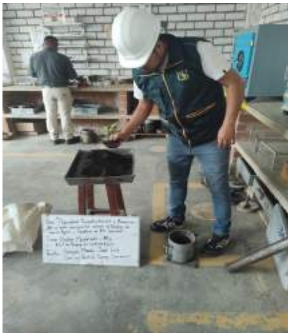
Fotografía 24: Ensayo de Proctor modificado del suelo natural con el SBCA.
