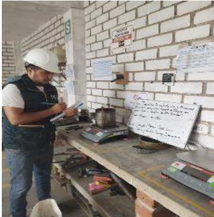
Fotografía 21: Toma de pesos de moldes de CBR
