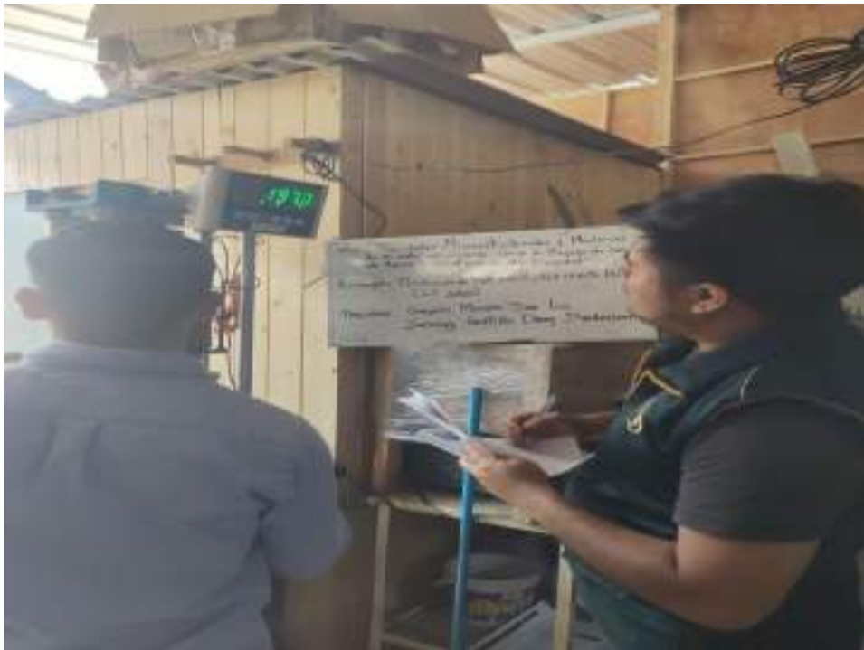
Fotografía 36: Toma de lecturas de CBR incorporando SBCA y HDPE.
