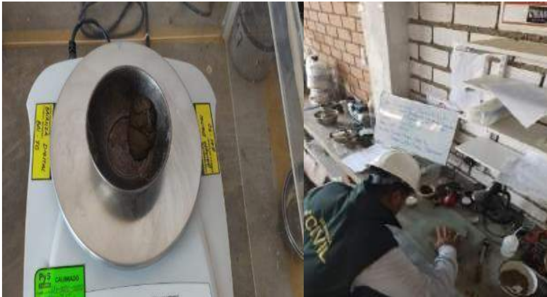
Fotografía 16: Preparación para los ensayos de límite plástico.
