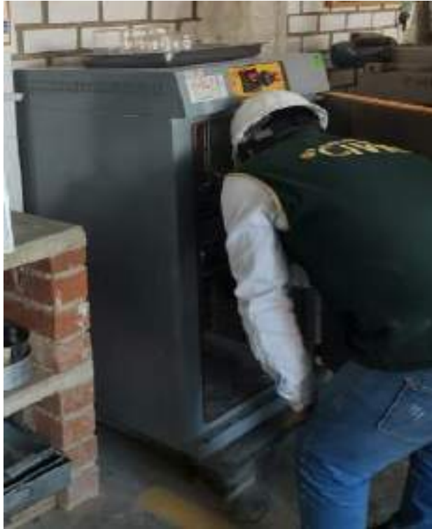
Fotografía 19: Muestra puesta al horno, ensayo de Proctor Modificado.
