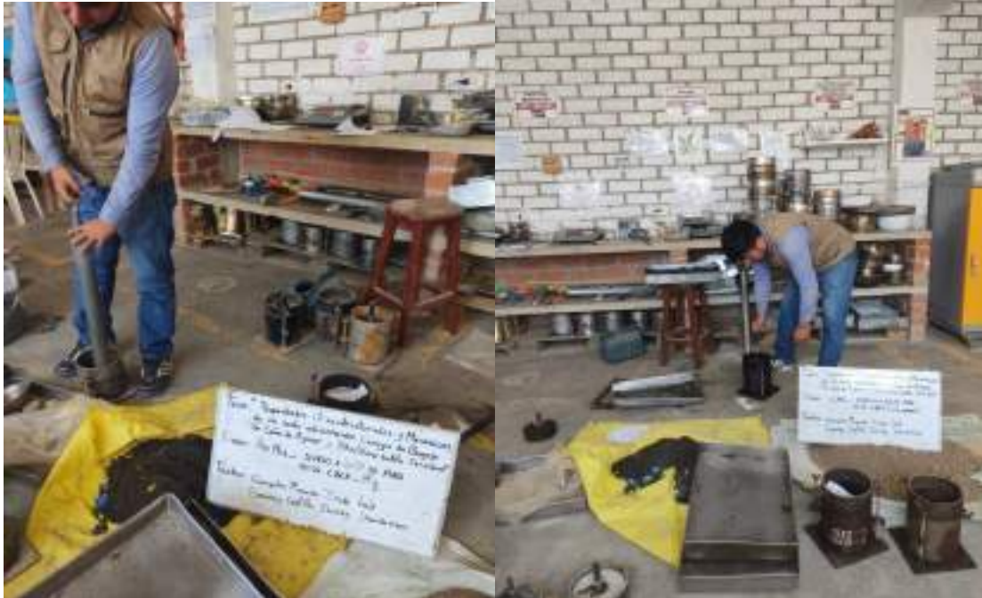
Fotografía 27: Ensayo de Proctor Modificado, incorporando el 10% de SBCA, y HDPE 0.25%.
