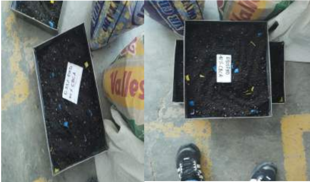
Fotografía 29: Muestras en moldes en porcentajes de SBCA y HDPE.
