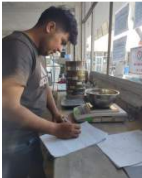
Fotografía 12: Ensayo del análisis granulométrico.
