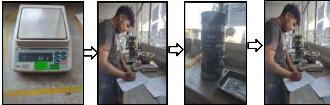
Fig. 8. Procedimiento del ensayo análisis granulométrico con el suelo convencional.
