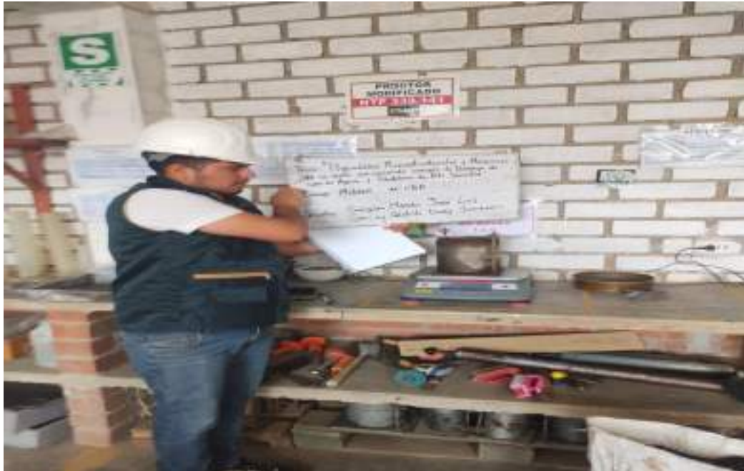
Fotografía 32: Peso de molde de ensayo de CBR incorporando SBCA y HDPE.
