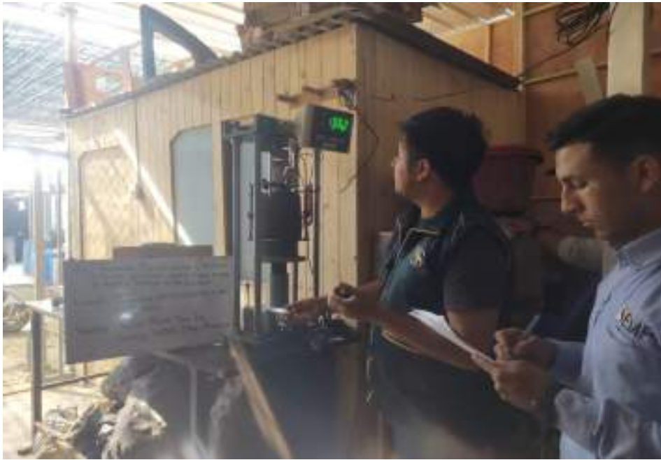
Fotografía 35: Ensayo de CBR incorporando SBCA y HDPE.
