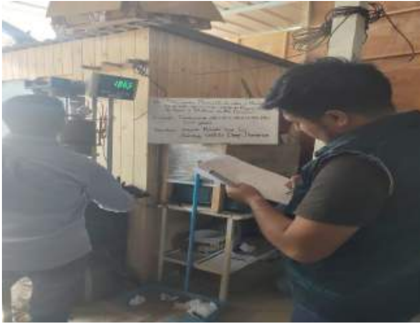
Fotografía 37: Toma de lectura de CBR incorporando SBCA y HDPE.
