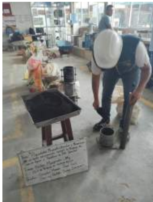
Fotografía 24: Ensayo de Proctor modificado del suelo natural con el SBCA.
