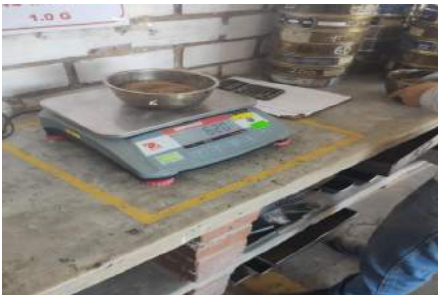
Fotografía 9: Peso del suelo natural para realizar los ensayos correspondientes.
