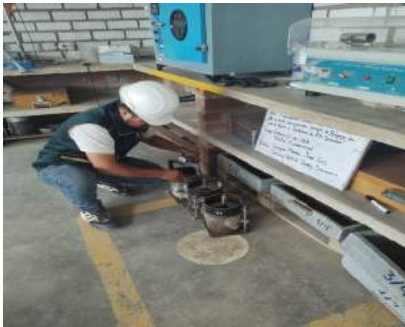
Fotografía 40: Pruebas de CBR incorporando SBCA y HDPE.
