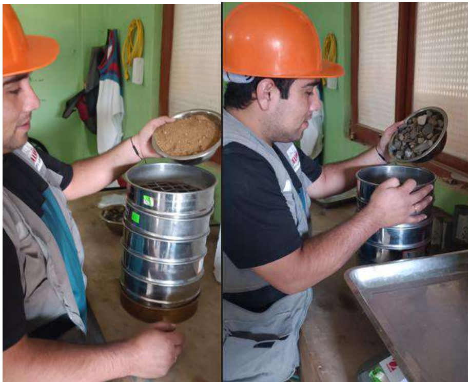
Fotografía 4. Granulometría de los agregados finos y gruesos
