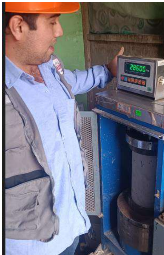
Fotografía 14. Ensayo para definir la resistencia a la compresión del concreto
