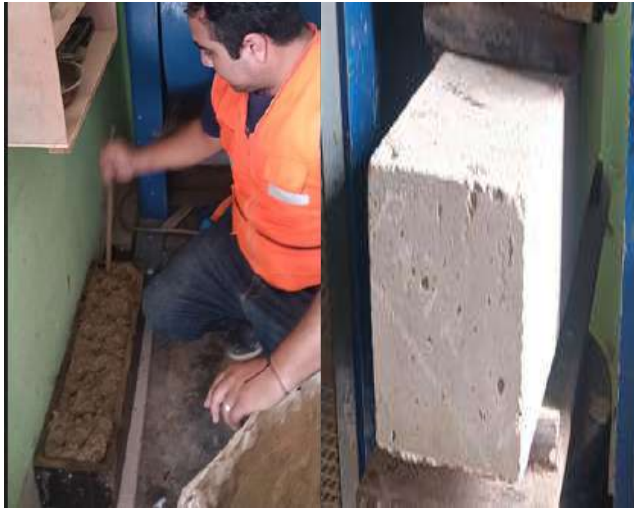
Fig. 14. Elaboración de vigas rectangulares de concreto
