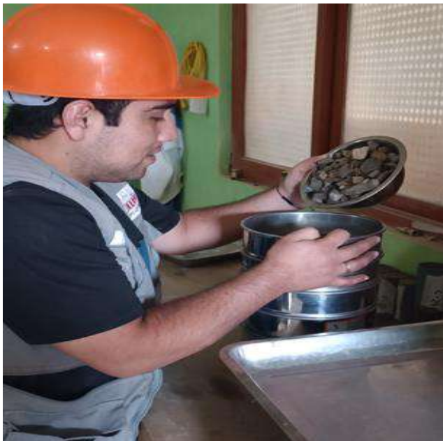
Fig. 6. Análisis granulométrico del árido grueso
