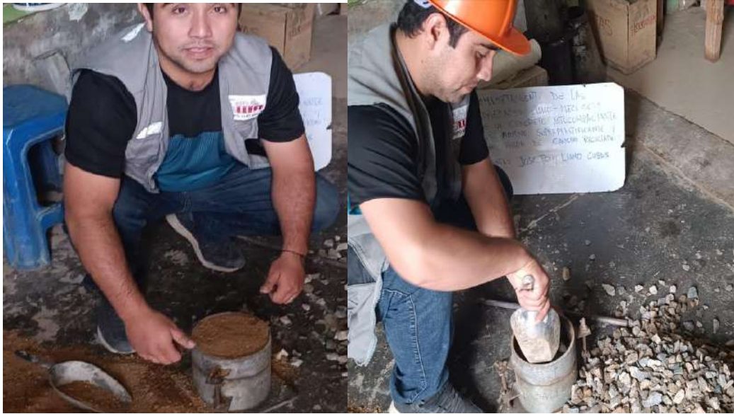
Fotografía 5. Ensayo para definir el peso unitario para los agregados gruesos y finos
