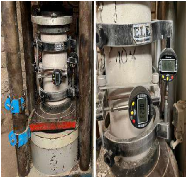
Fig. 22. Ensayo para definir el módulo de elasticidad del concreto en estado sólido.
