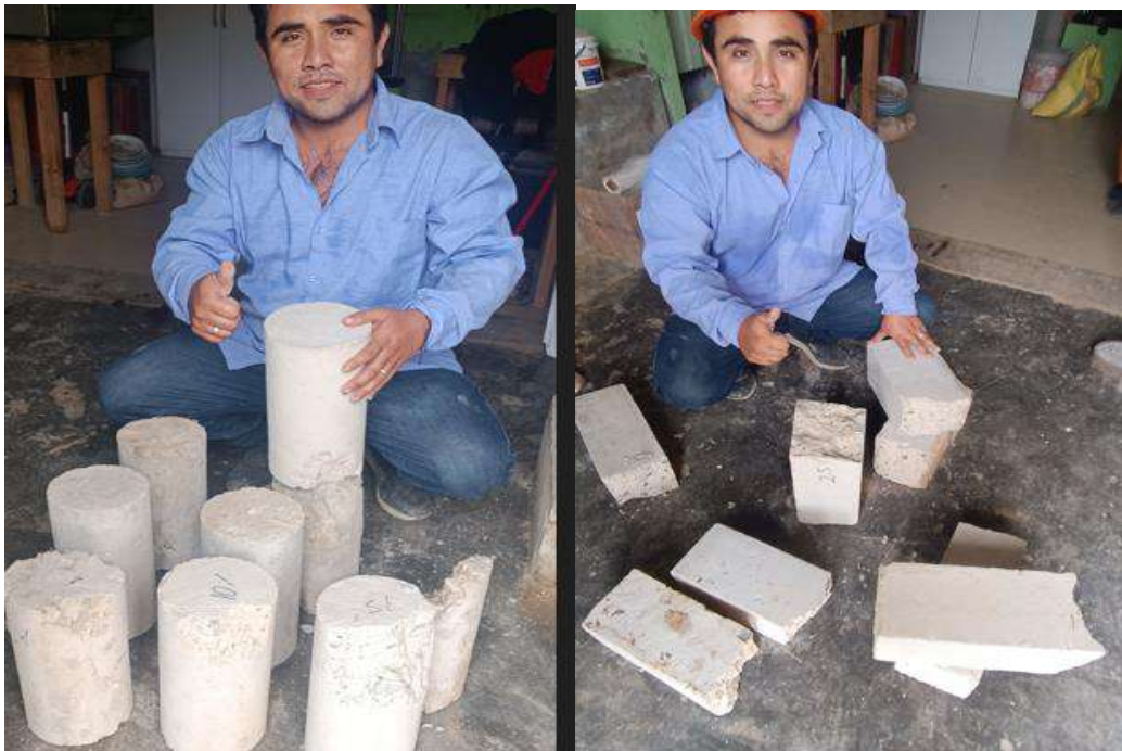
Fotografía 18. Rotura de muestras (probetas y vigas) de concreto tras someterse a los ensayos en estudio.
