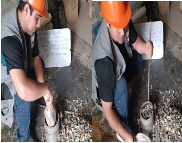
Fig. 8. Análisis de la masa unitaria suelta y compactada el árido grueso
