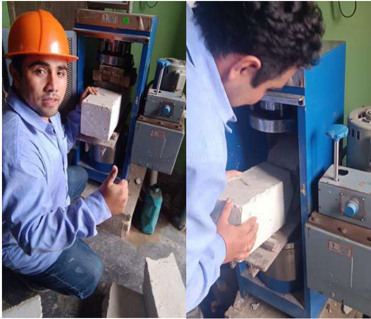
Fig. 21. Ensayo para definir el esfuerzo de flexión del concreto en estado sólido.
