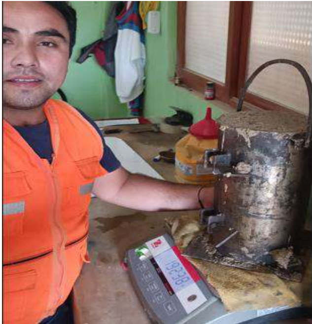
Fig. 16. Peso unitario del concreto en estado fresco
