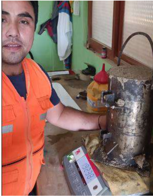
Fotografía 11. Cálculo del peso unitario del concreto
