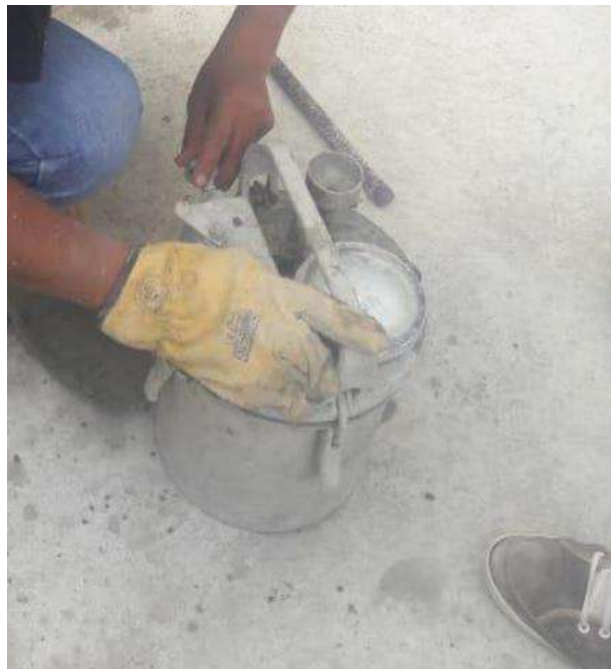
Fotografía 12. Contenido de aire del concreto
