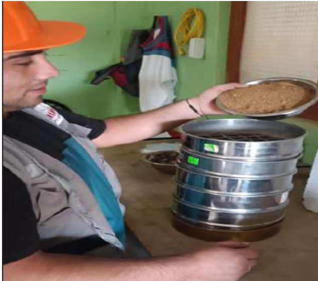
Fig. 5. Análisis granulométrico del árido fino
