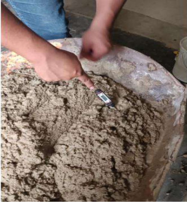
Fig. 17. Ensayo para definir la temperatura del concreto en estado fresco.
