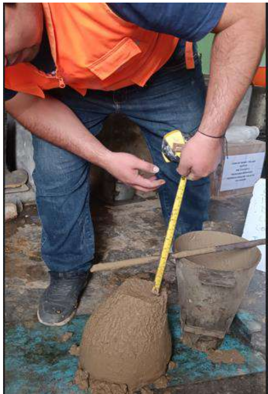
Fotografía 10. Ensayo de asentamiento del concreto
