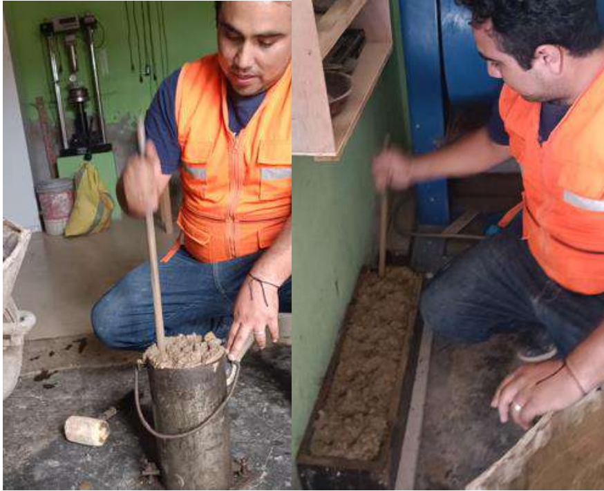
Fotografía 9. Encofrado de las muestras de concreto en las probetas cilíndricas y viguetas rectangulares
