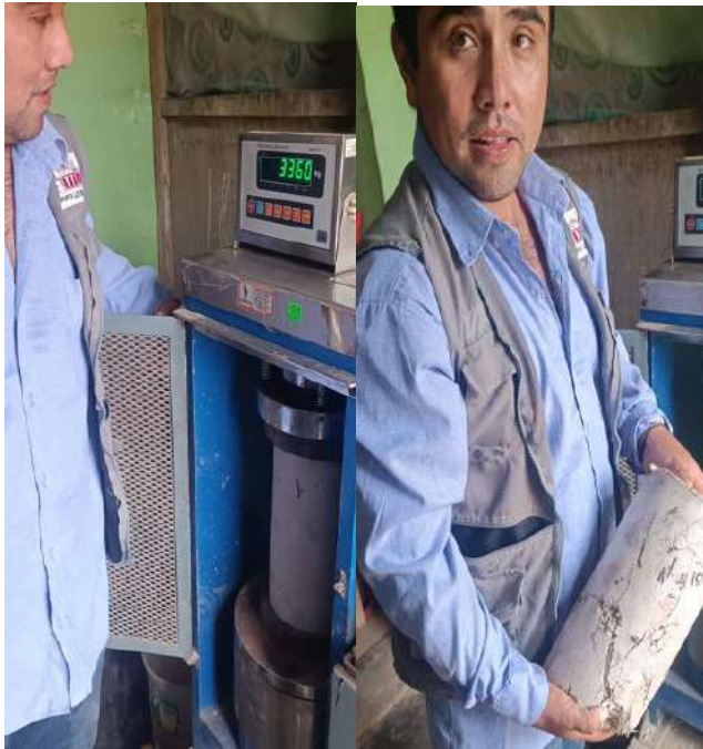
Fig. 19. Ensayo para definir el esfuerzo de compresión del concreto en estado sólido
