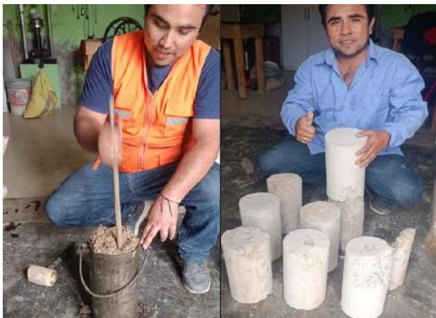
Fig. 13. Elaboración de probetas cilíndricas de concreto
