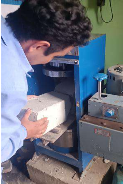
Fotografía 17. Ensayo para definir la resistencia a la flexión
