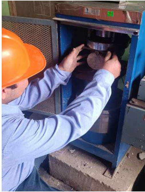
Fotografía 15. Ensayo para definir la resistencia a la tracción del concreto
