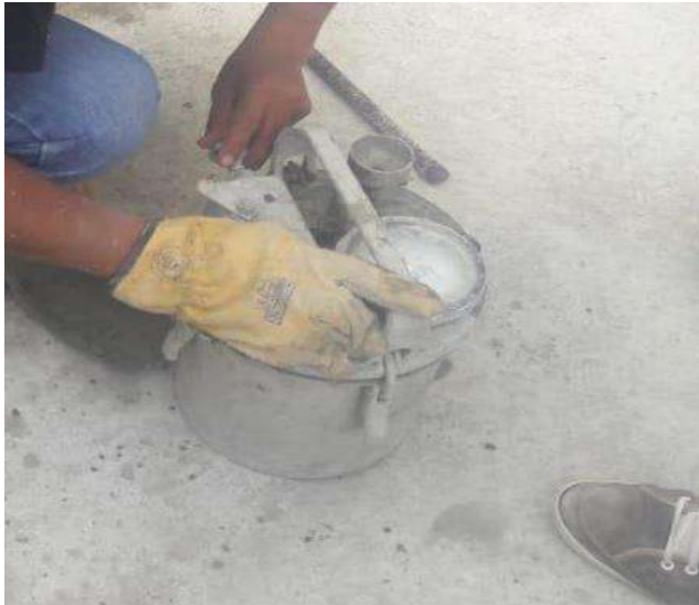
Fig. 18. Ensayo para definir el contenido de aire del concreto en estado fresco.
