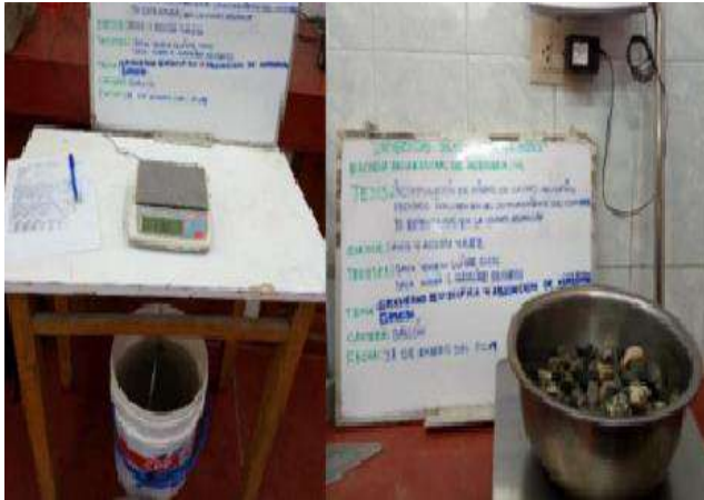
Fig. 10. Ensayo para identificar el peso y absorción específico del árido grueso
