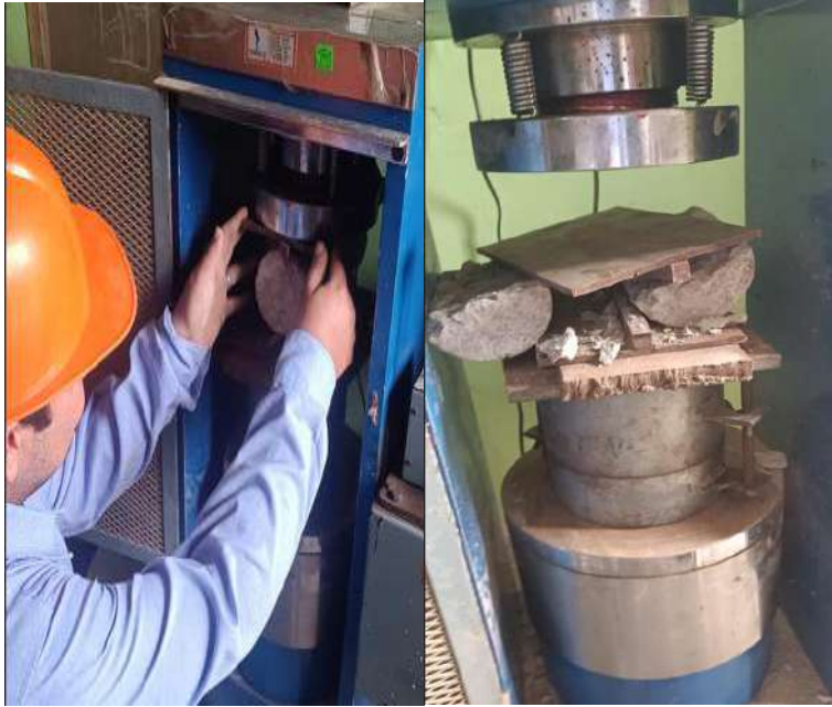
Fig. 20. Ensayo para definir el esfuerzo de tracción del concreto en estado sólido.
