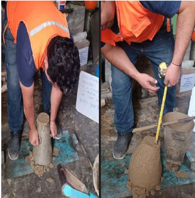
Fig. 15. Ensayo para definir el nivel de asentamiento del concreto
