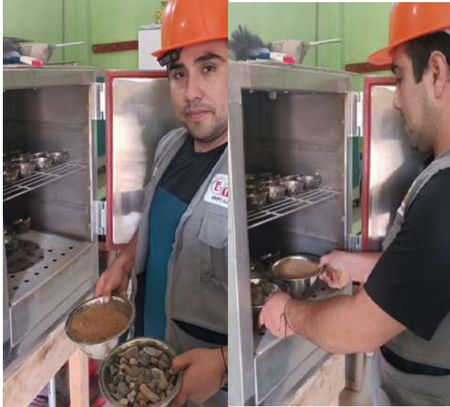
Fig. 11. Ensayo para definir el contenido de humedad del árido fino y grueso
