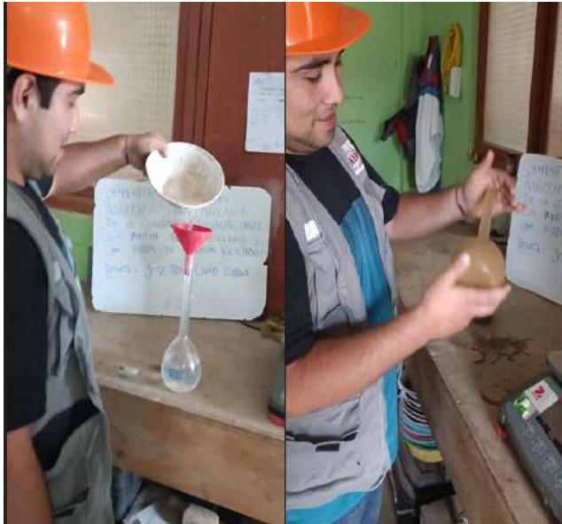
Fig. 9. Ensayo para identificar el peso y absorción específico del árido fino
