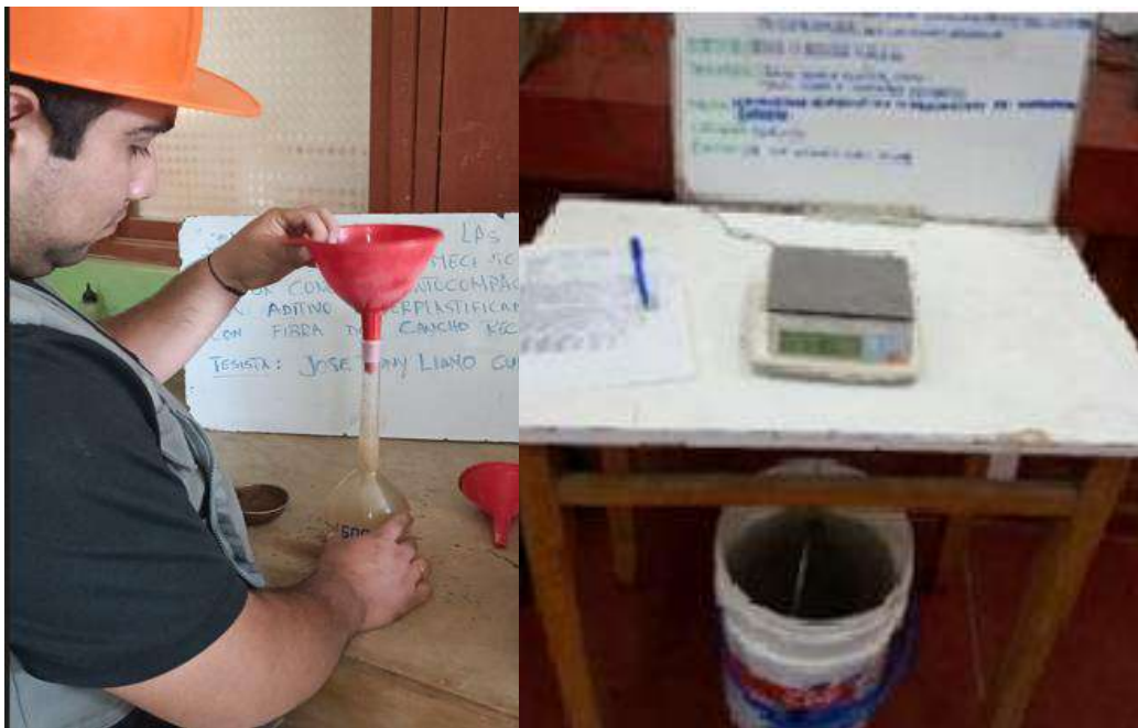
Fotografía 6. Ensayo para definir gravedad específica y absorción de los agregados (fino y grueso)
