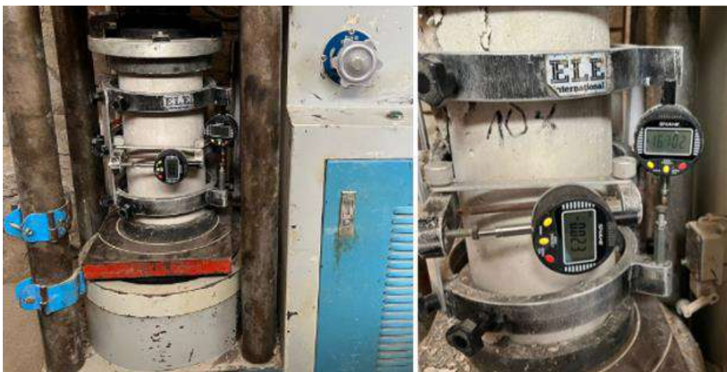
Fotografía 16. Ensayo para definir la elasticidad del concreto
