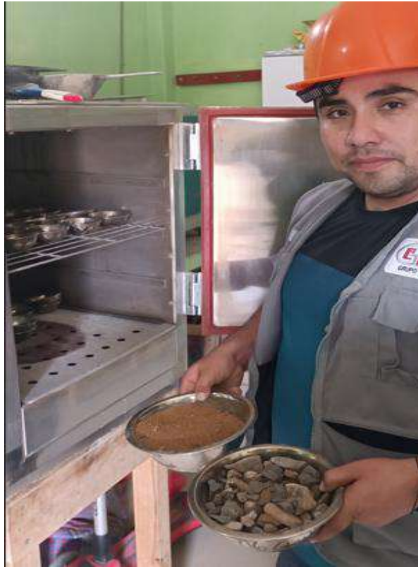
Fotografía 7. Ensayo para definir el contenido de humedad de los agregados (fino y grueso)
