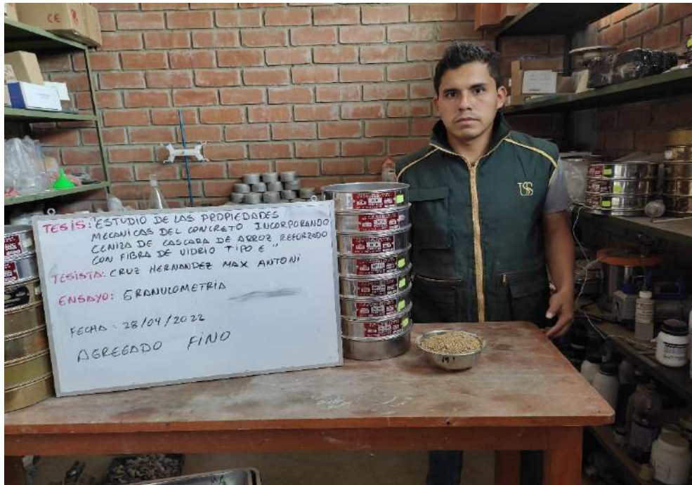
Ensayo de Granulometría de Agregado Fino
