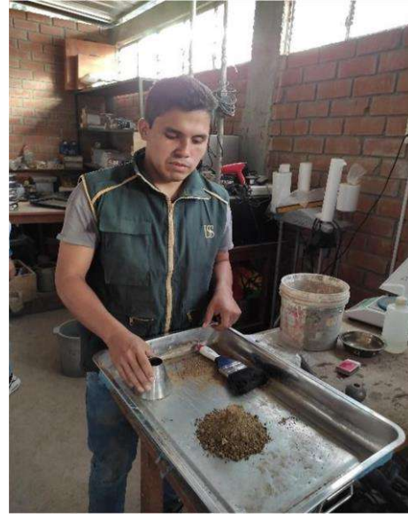
Punto óptimo de la humedad del Agregado Fino
