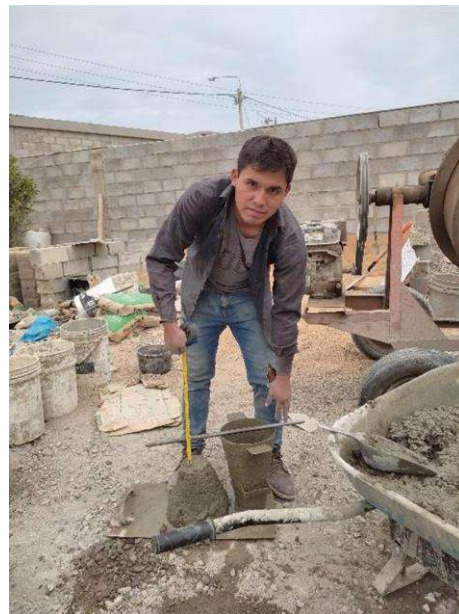
Consistencia del Concreto con FV y 0.75FV con CCA
