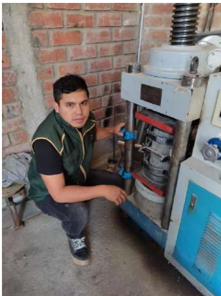
Ensayo a la Compresión de concreto con Fibra de Vidrio
