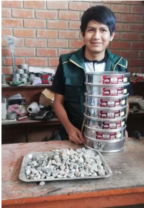
Ensayo de Granulometría de Agregado Grueso
