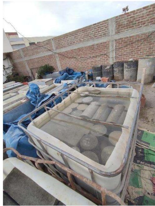
Curado de probetas durante 7, 14 y 28 días
