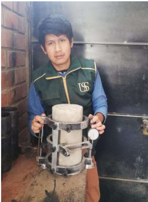
Módulo de Elasticidad de concreto con Fibra de Vidrio
