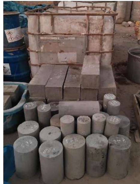
Desmoldado de probetas y vigas de concreto
