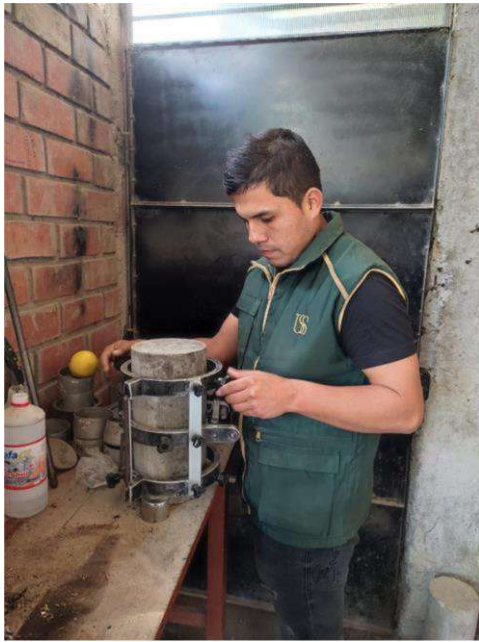
Módulo de Elasticidad de concreto con 0.75 de Fibra de Vidrio y Ceniza de Cáscara de Arroz
