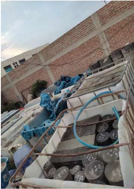
Curado de probetas durante 7, 14 y 28 días
