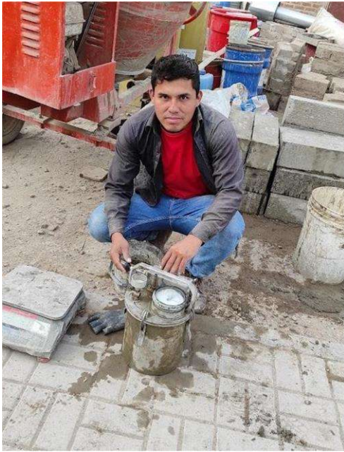
Ensayo de contenido de aire del concreto
