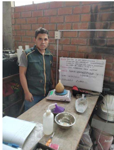
Peso específico y absorción del agregado fino
