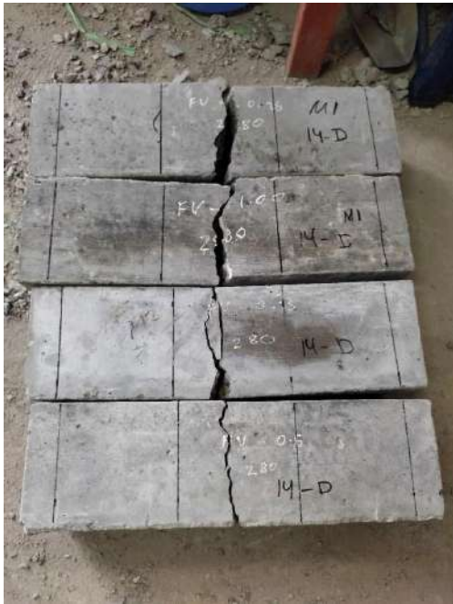
Ensayo de Flexión de concreto Fibra de Vidrio
