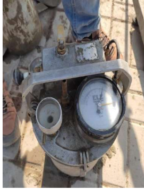
Ensayo de contenido de aire del concreto
