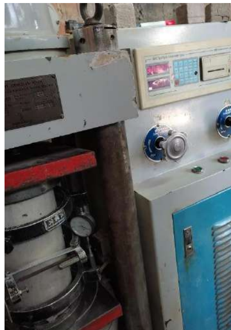
Módulo de Elasticidad de concreto con Fibra de Vidrio
