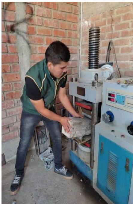
Ensayo de Flexión de concreto con Fibra de vidrio
