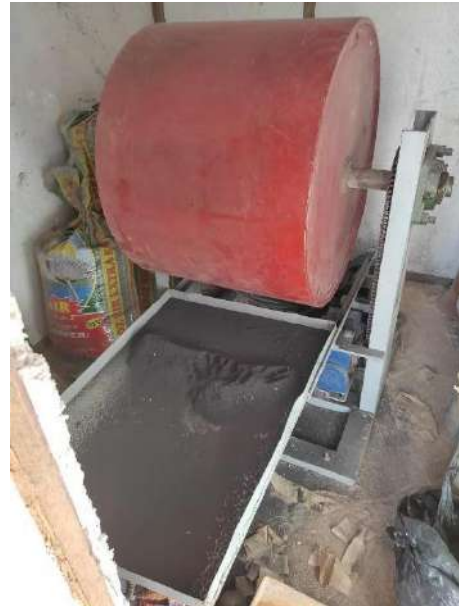
Obtención y molienda de Cenizas de Cáscara de Arroz
