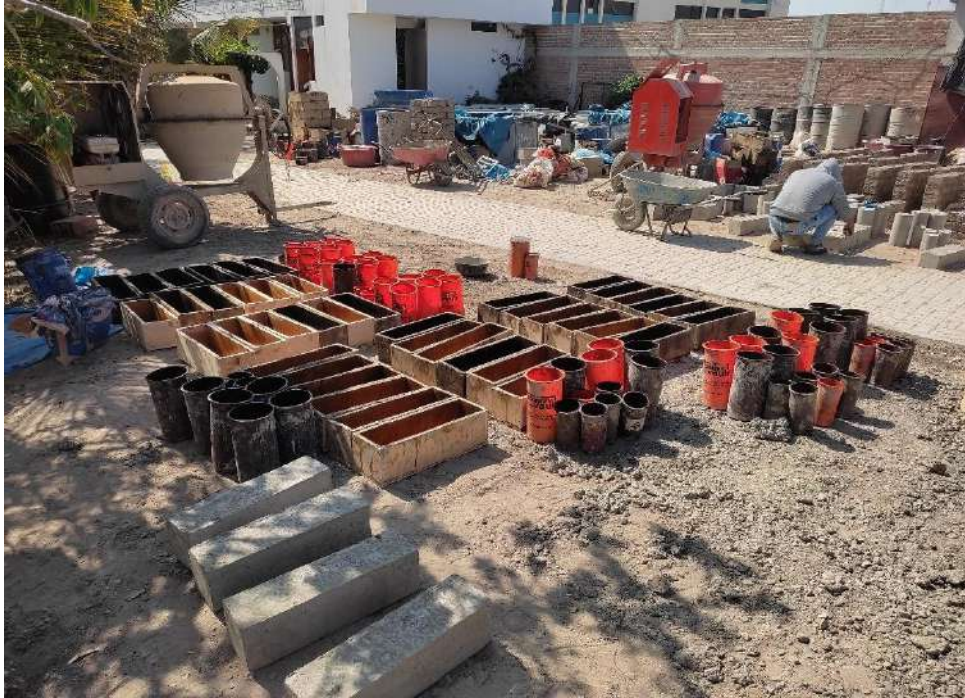
Moldes de vigas y probetas listo y engrasado con aceite
