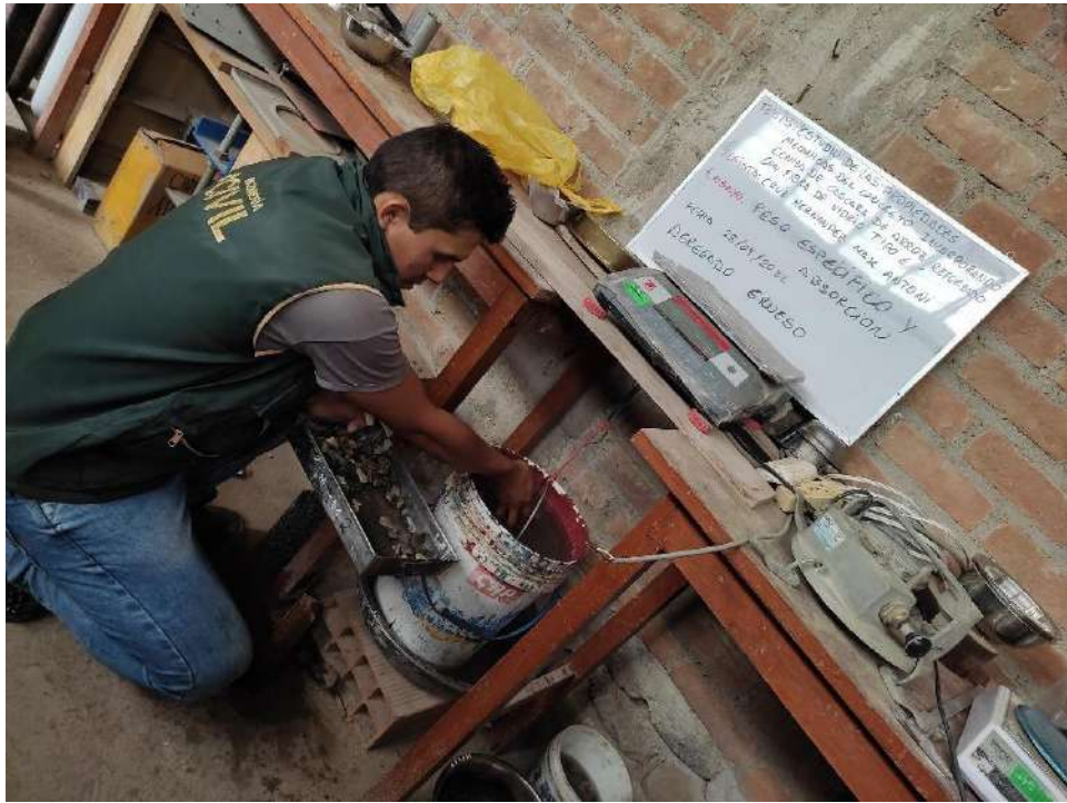
Peso específico y absorción del agregado grueso
