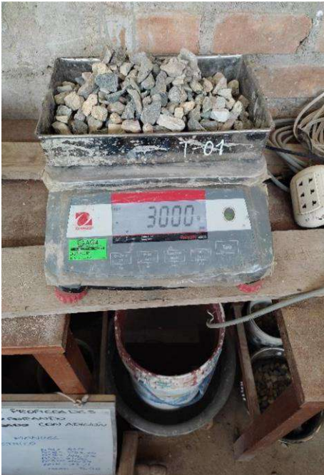
Ensayo de contenido de humedad de agregado fino y grueso
