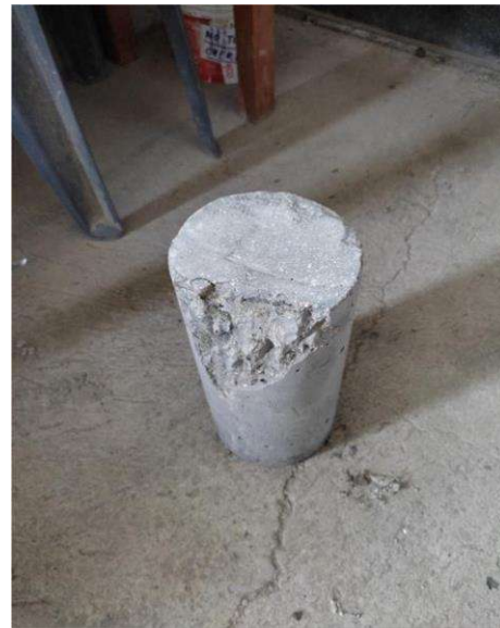
Ensayo a la Compresión de concreto con Fibra de Vidrio
