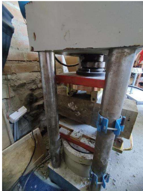
Ensayo de Flexión de concreto con 0.75 de Fibra de Vidrio y Ceniza de Cáscara de Arroz
