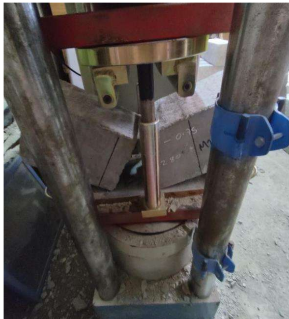
Ensayo de Flexión de concreto con Fibra de vidrio
