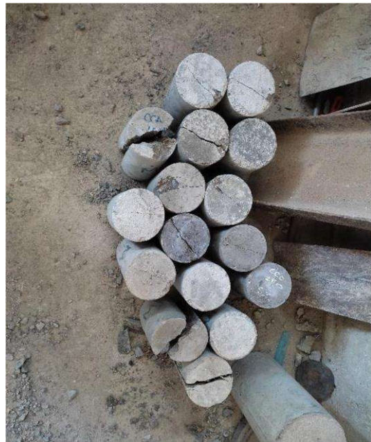
Ensayo de Tracción de concreto con 0.75 de Fibra de Vidrio y Ceniza de Cáscara de Arroz
