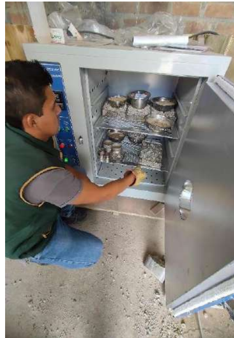
Ensayo de contenido de humedad de agregado fino y grueso
