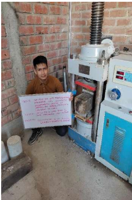
Ensayo de Flexión de concreto con 0.75 de Fibra de Vidrio y Ceniza de Cáscara de Arroz
