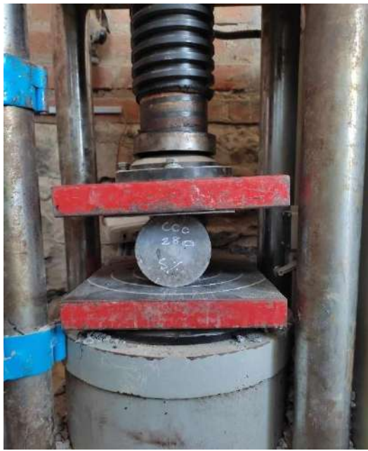
Ensayo de Tracción de concreto con 0.75 de Fibra de Vidrio y Ceniza de Cáscara de Arroz
