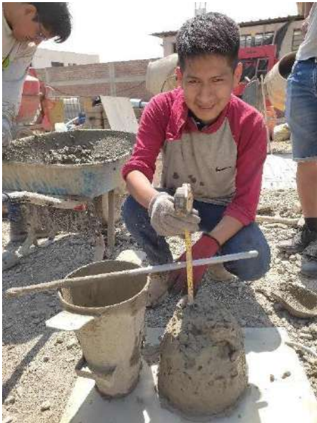
Consistencia del Concreto con FV y 0.75FV con CCA
