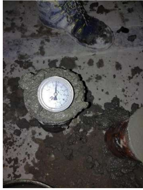
Temperatura del concreto
