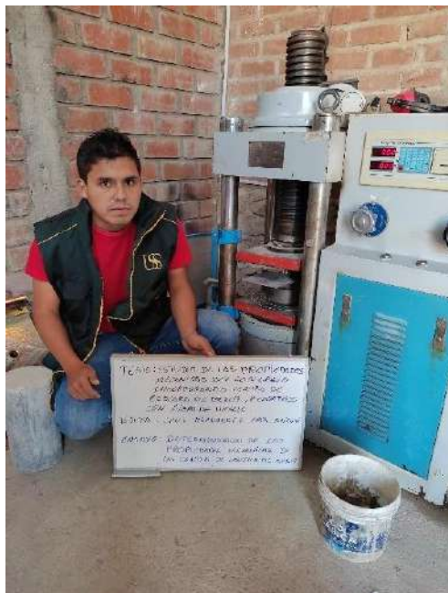
Ensayo de compresión de cubos de (5x5x5 cm)
