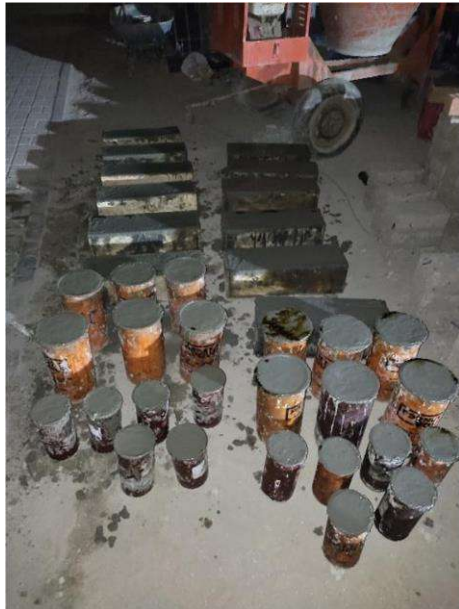
Moldes de vigas y probetas llenadas
