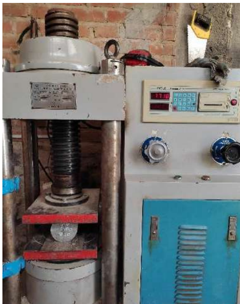
Ensayo de Tracción de concreto con Fibra de Vidrio
