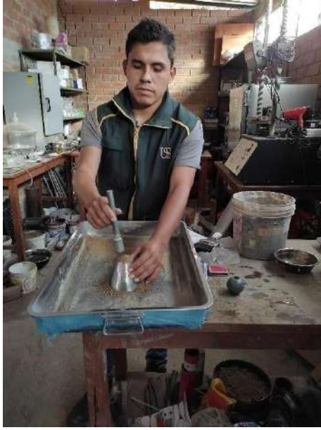
Punto óptimo de la humedad del Agregado Fino
