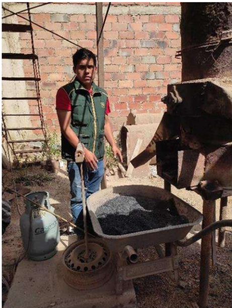
Obtención y molienda de Cenizas de Cáscara de Arroz
