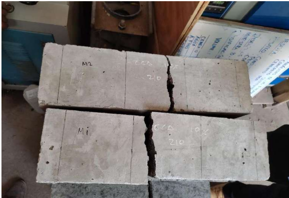
Ensayo de flexión de concreto con 0.75 de Fibra de Vidrio y Ceniza de Cáscara de Arroz
