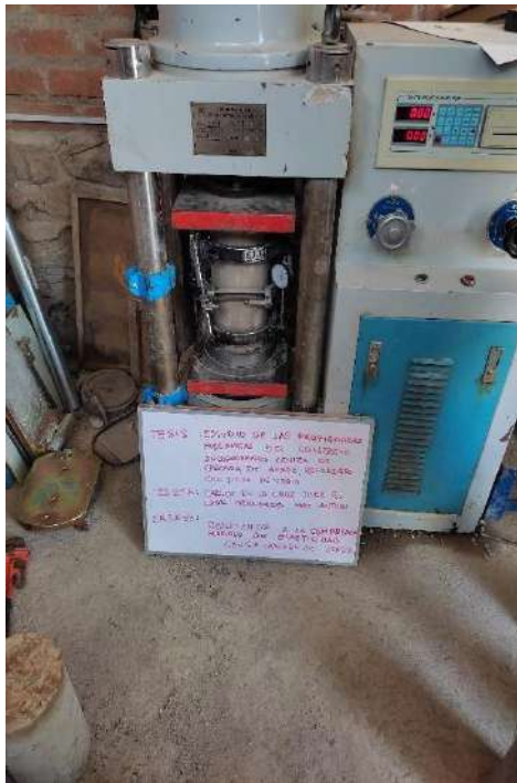
Ensayo a la Compresión del concreto con 0.75 Fibra de Vidrio y Cenizas de Cáscara de Arroz
