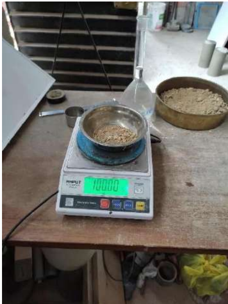
Peso específico y absorción del agregado fino
