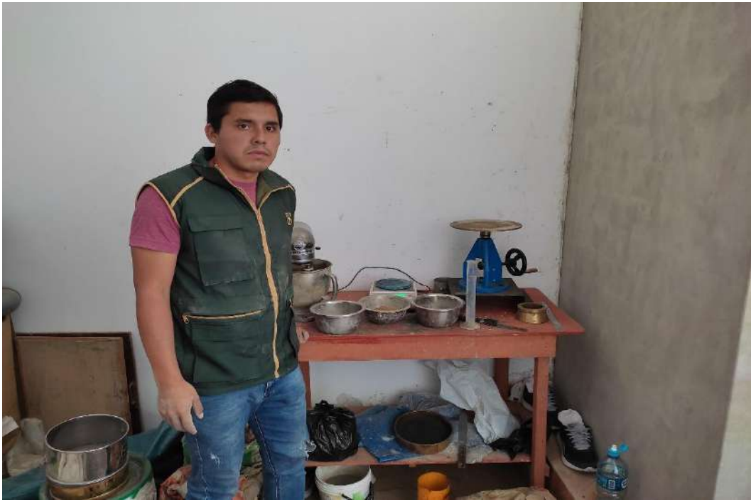
Ensayo para la determinación de Fluidez, del concreto con cenizas de Cáscara de arroz
