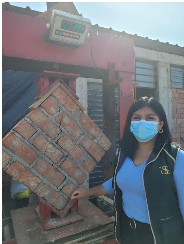
**Fig. 25.** Ensayo de la resistencia a la compresión diagonal de muretes.
