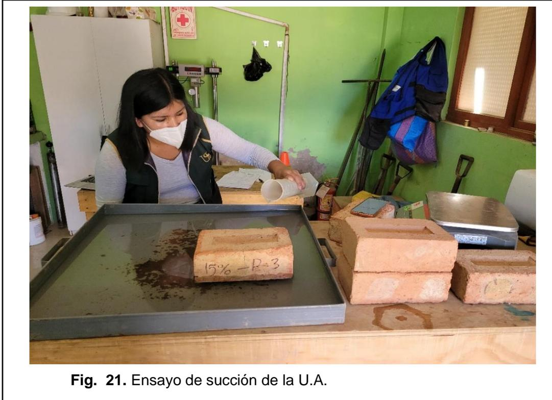
**Fig. 21.** Ensayo de succión de la U.A.
