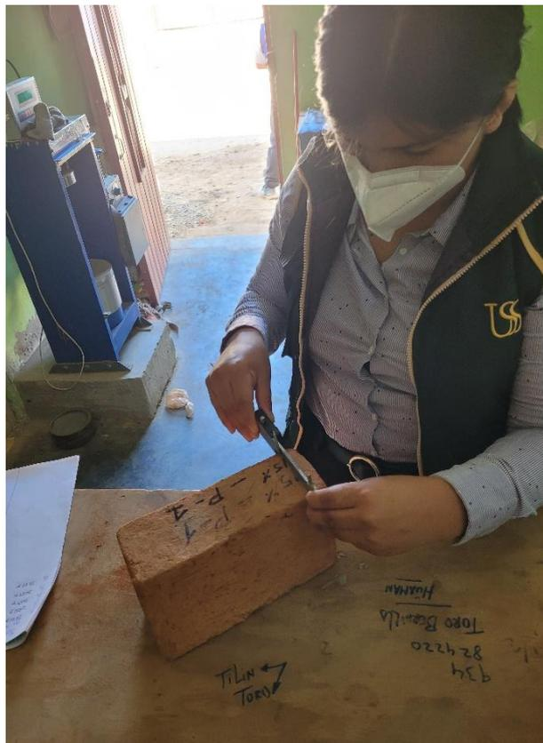
**Fig. 20.** Ensayo de variación dimensional de las U.A.
