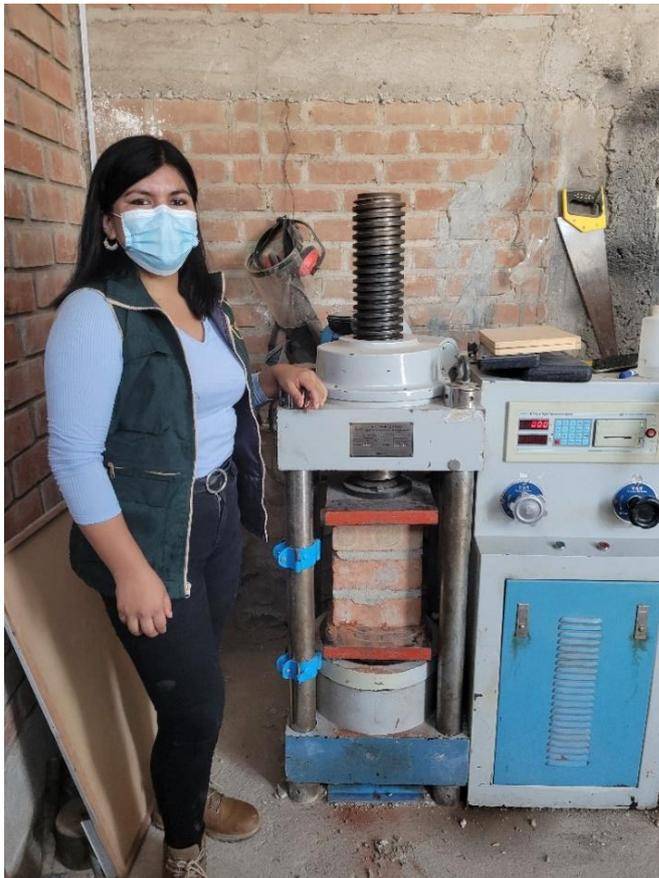
**Fig. 24.** Ensayo de la resistencia a la compresión axial de la albañilería.
