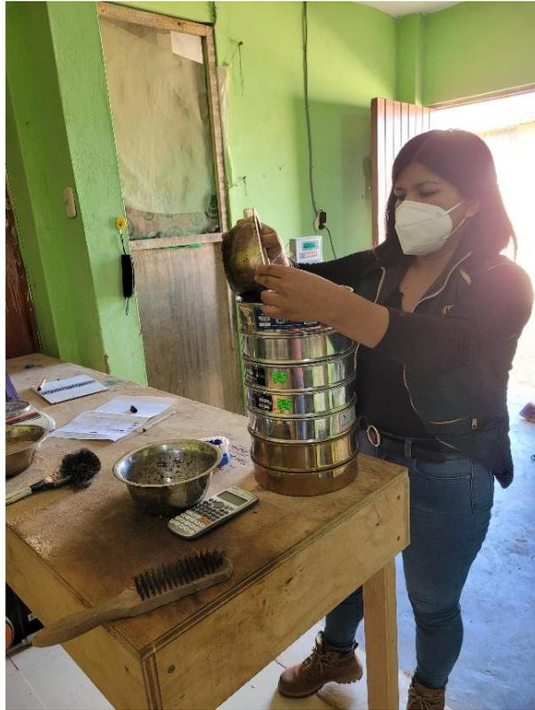
**Fig. 15.** Análisis de ensayo de granulometría de la arcilla, arena y vidrio triturado.
