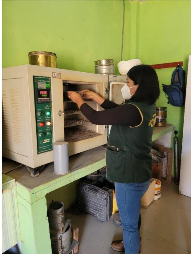
**Fig. 16.** Ensayo de contenido de humedad de la arcilla y arena.
