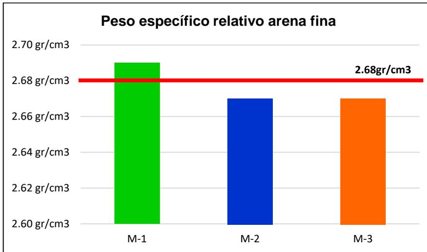
**Fig. 33.** Peso específico relativo de la arena.
