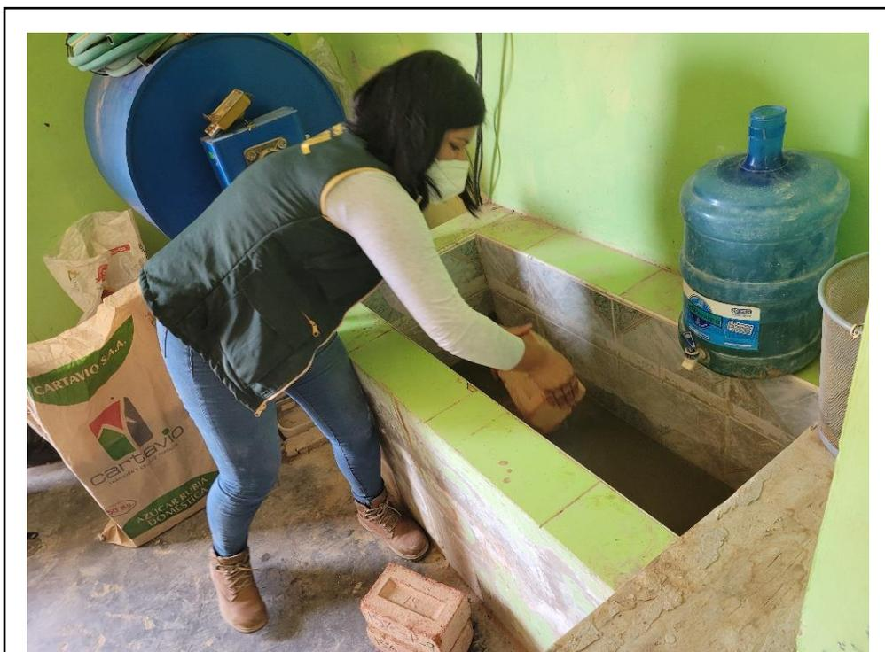
**Fig. 22.** Ensayo de absorción de las U.A.
