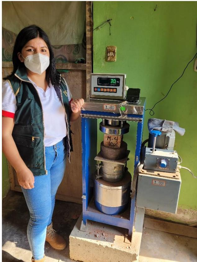
**Fig. 23.** Ensayo de la resistencia a la compresión axial de la U.A.
