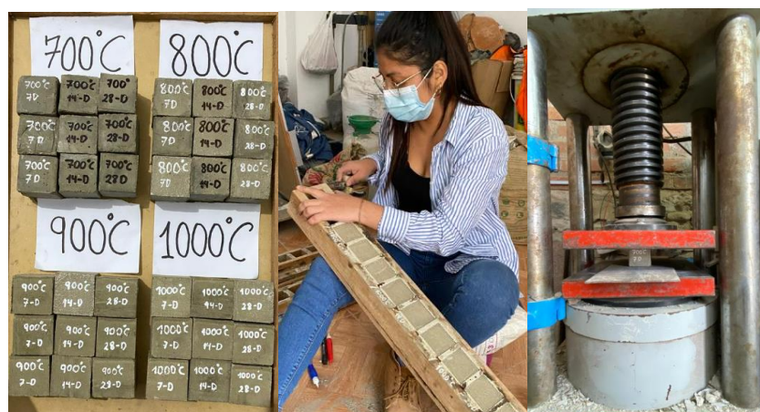
Fig. 16. Análisis de los cubos de concreto de Cenizas de CH
