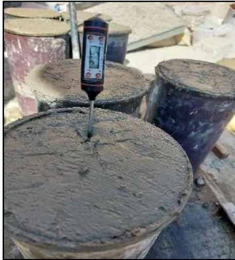
Fig. 26. Medición de lecturas de las diferentes temperaturas del concreto
