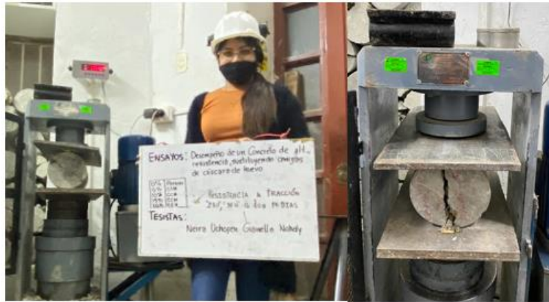
Fig. 28. Ensayo de resistencia a Tracción
