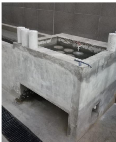
Fig. 12. Tanque de curado de muestras
