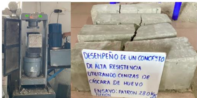
Fig. 29. Ensayo de resistencia a flexión
