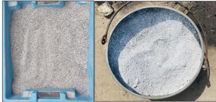
Fig. 17. Cenizas de Grado Optimo de 900°C, obtención de 100kg
