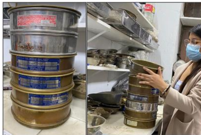
Fig. 20. Tamices seleccionados para los materiales pétreos
