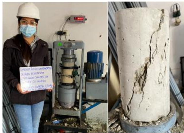
Fig. 27. Ensayo de resistencia a compresión
