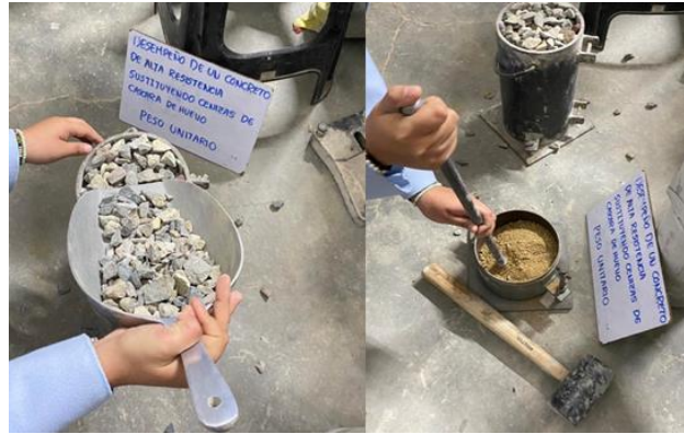
Fig. 21. Peso unitario de los Agregados Pétreos
