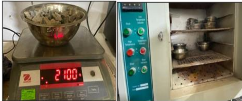
Fig. 22. Contenido de Humedad
