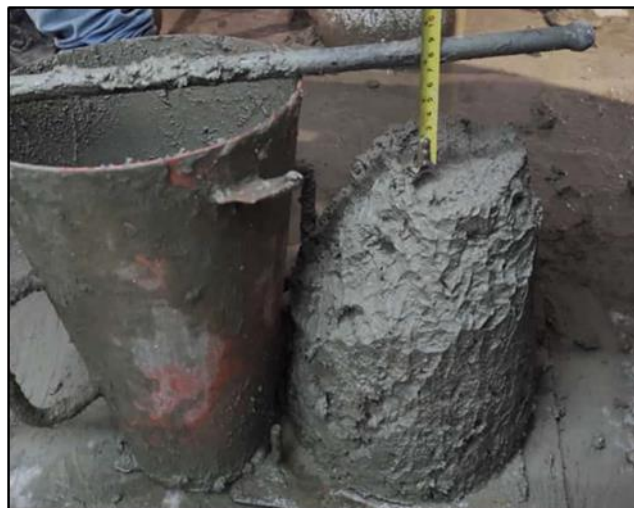
Fig. 25. Medición de lecturas del asentamiento que este dentro del rango de 3" a 4"
