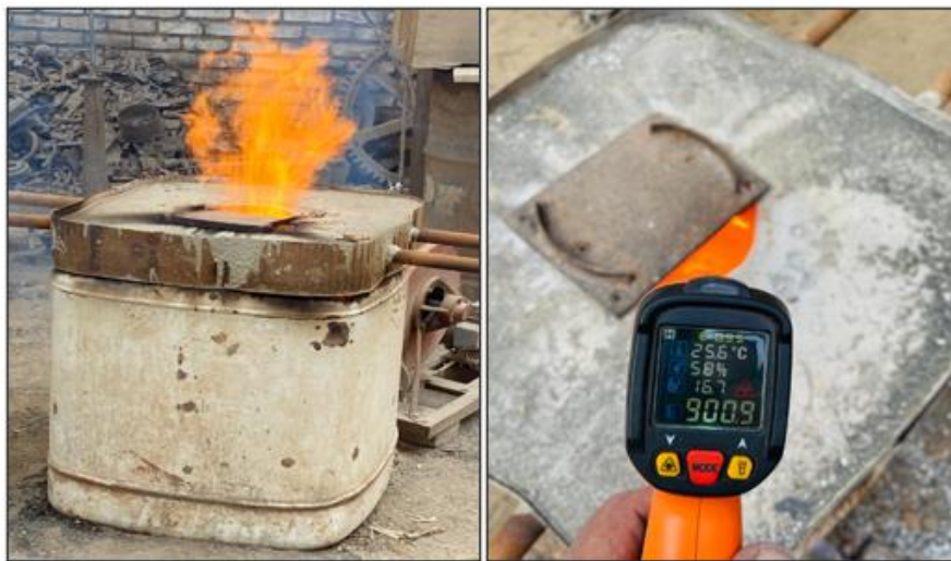
Fig. 17. Quemado óptimo de la cáscara de huevo
