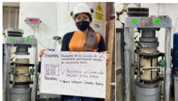
Fig. 30. Ensayo de Modulo de elasticidad
