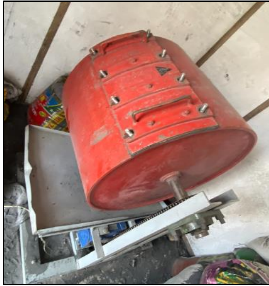
Fig. 23. Abrasión del agregado grueso en la Máquina de los Ángeles
