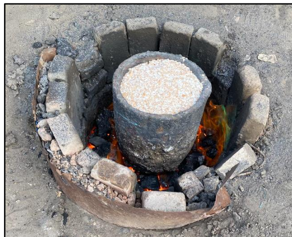
Fig. 18. Segundo horno de tierra-Crisol de 15Kg Cenizas
