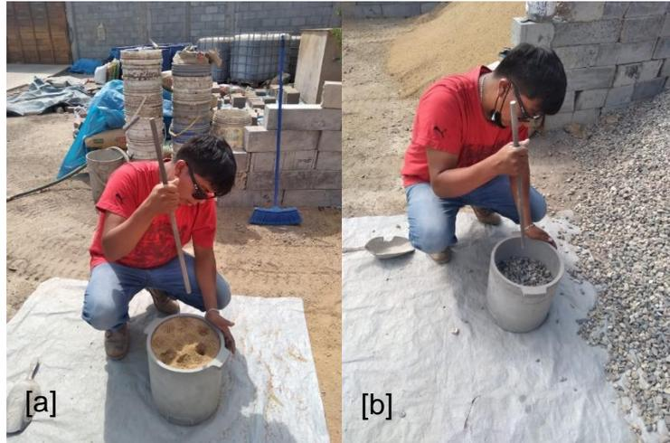
Fig. 16. Proceso de realización de peso unitario compactado de agregados a) fino, b) grueso.
