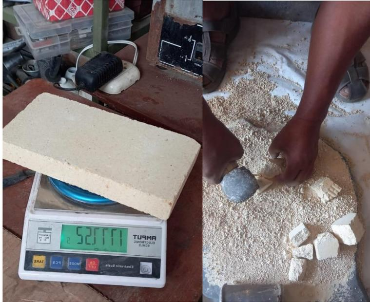
Fig. 13. Adquisición de ladrillos refractarios para fines de investigación y molienda del material.
