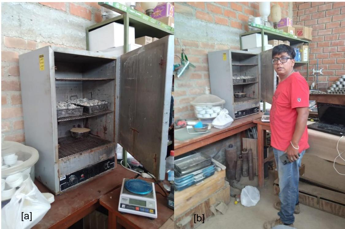
Fig. 17. Proceso de peso de muestras para el contenido de humedad a) árido grueso, b) árido fino.
