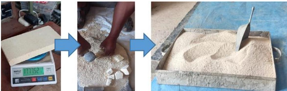
Fig. 8. Proceso de obtención de agregado refractario fino
