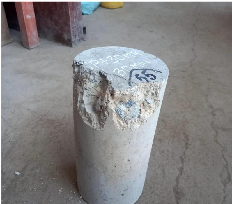
**Especímen expuesto a ensayo de compresión axial presentando una resistencia óptima luego de ser sometida durante 30 minutos al fuego**
