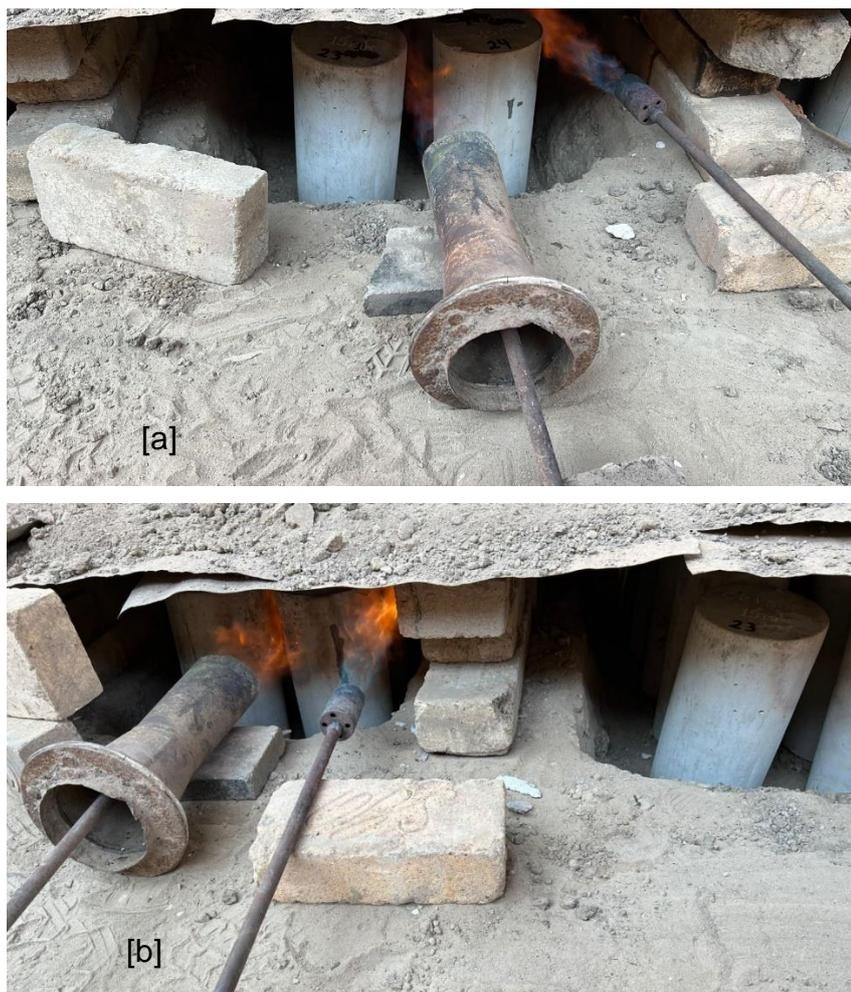
Fig. 26. a) Coloración de probetas debido al rango de temperatura, b) exposición al fuego directo utilizando una antorcha industrial.
