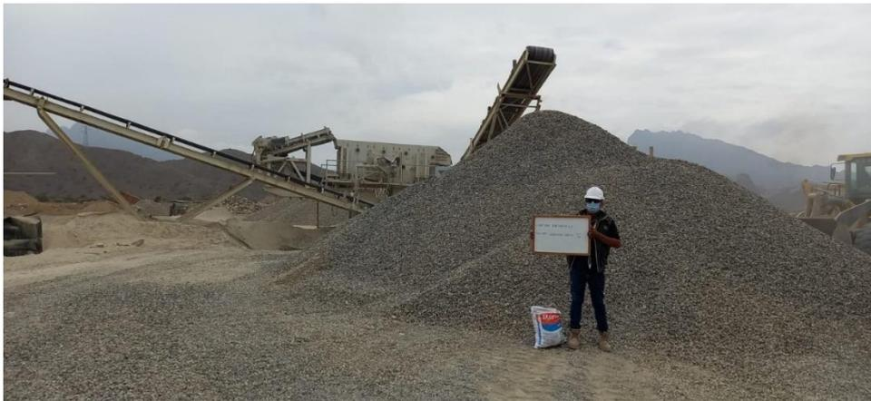
Fig. 11. Extracción de muestra de la cantera “Pacherres” para agregado grueso.
