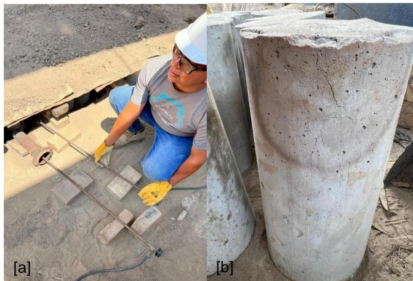
Fig. 25. a) Colocación de probetas en el horno para su exposición a rangos de temperaturas, b) textura luego de someterlas al fuego.
