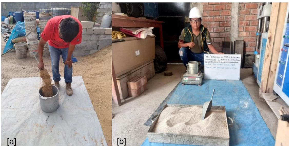
Fig. 15. Proceso de realización de a) peso unitario suelto de agregados, b) material refractario.
