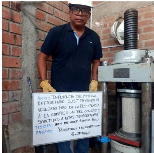
Fig. 24. Proceso de rotura de probetas en la máquina de resistencia a la compresión.
