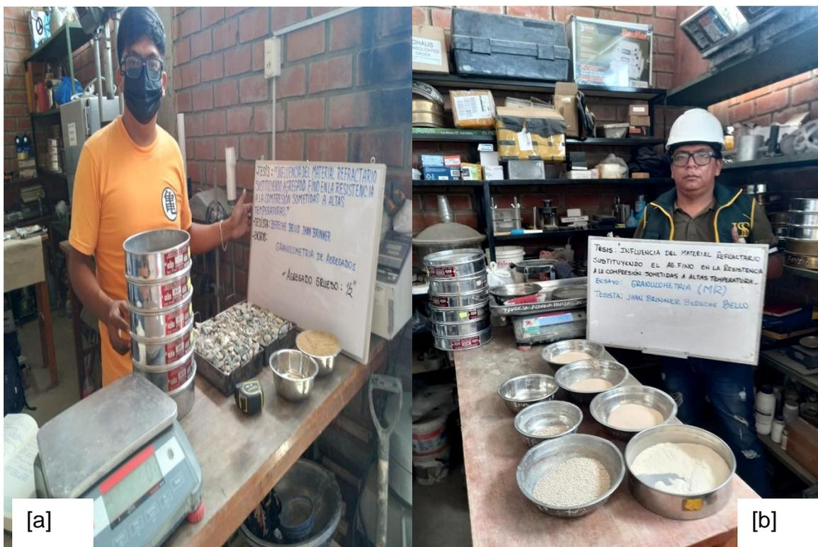
Fig. 14. Proceso de tamizado de a) materiales pétreos agregado fino y grueso, b) material refractario.
