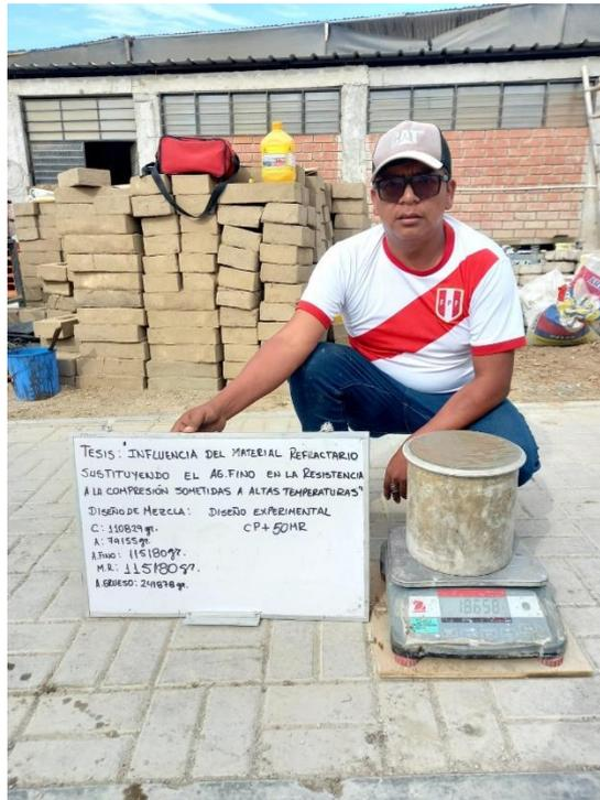
Fig. 22. Proceso de peso y varillado en el molde de la Olla de Washington.
