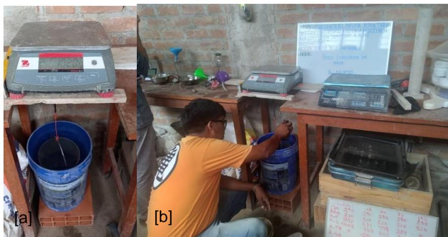
Fig. 19. Proceso de peso de muestra en canastilla sumergida a) peso de cesta, b) sumersión de árido grueso.
