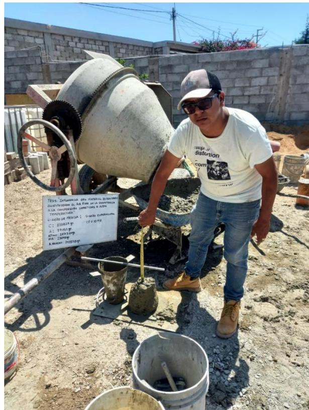
Fig. 21. Proceso de medición del slump.
