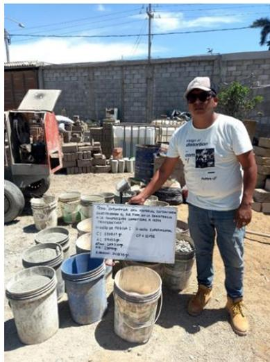
Fig. 5. Mezcla de concreto sustituyendo material pétreo por material refractario.
