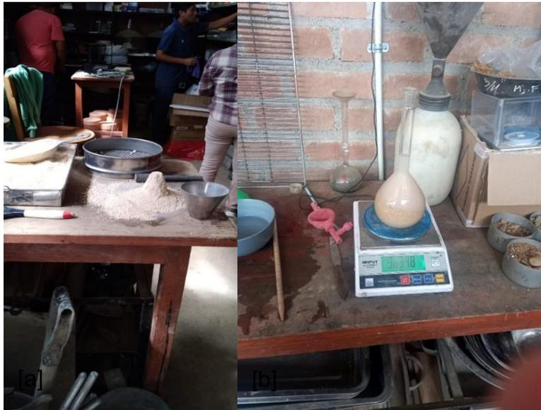
Fig. 18. Proceso de peso de muestras, a) absorción, b) peso específico
