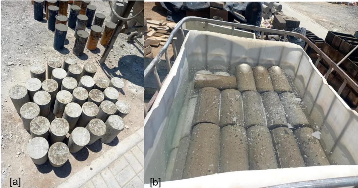
Fig. 23. Colocación de a) nomenclatura, b) curado de probetas
