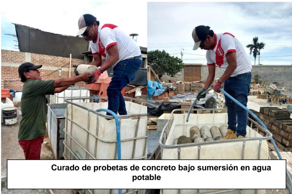
**Curado de probetas de concreto bajo sumersión en agua potable**
