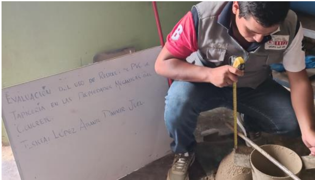
Fotografía 9. Ensayo para determinar de asentamiento del concreto
