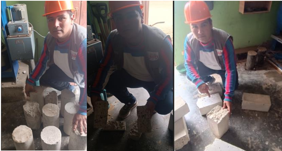
Fotografía 17. Rotura de especímenes tras someterse a los ensayos mecánicos.
