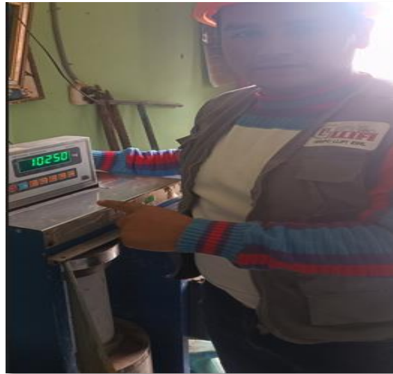
Fig. 17 Prueba de resistencia ante los esfuerzos de compresión del concreto
