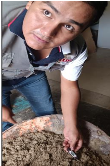
Fotografía 12. Ensayo para determinar la temperatura del concreto
