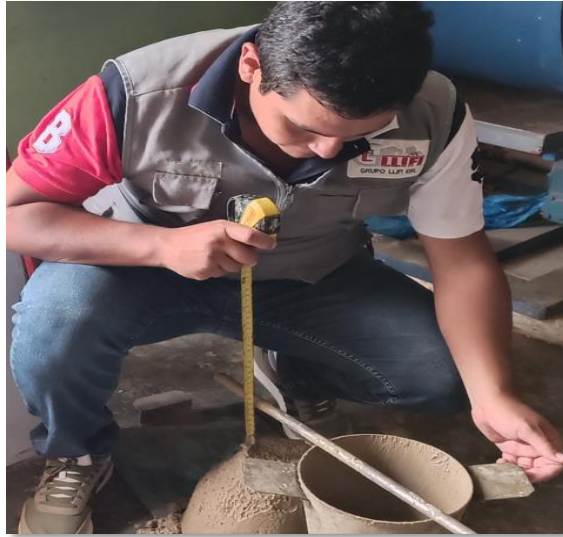
Fig. 13 Prueba para determinar el asentamiento del concreto.
