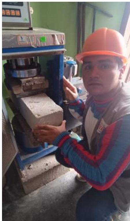
Fotografía 16. Ensayo para determinar la resistencia a la flexión del concreto
