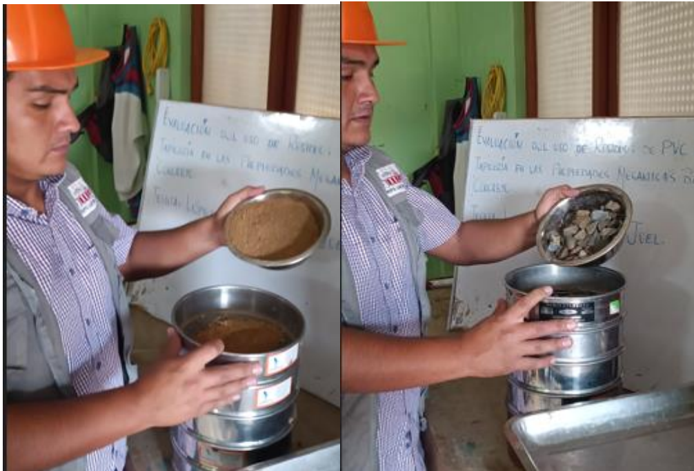
Fotografía 3. Ensayos para determinar la granulometría de los agregados finos y gruesos
