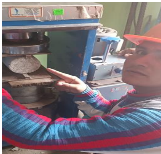
Fig. 18 Prueba de la resistencia ante los esfuerzos de tracción del concreto
