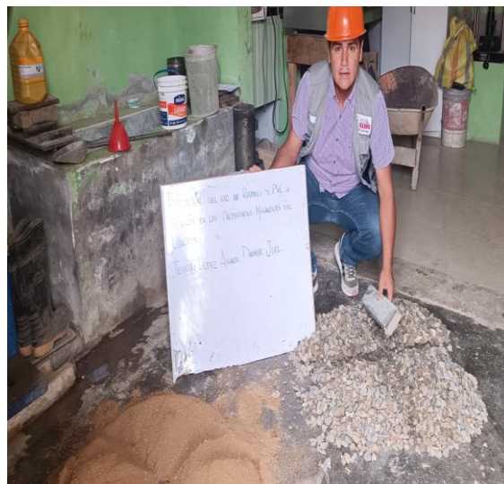
Fig. 2 Muestras finas y gruesas extraídas de las canteras "Tres Tomas" y "La Victoria"
