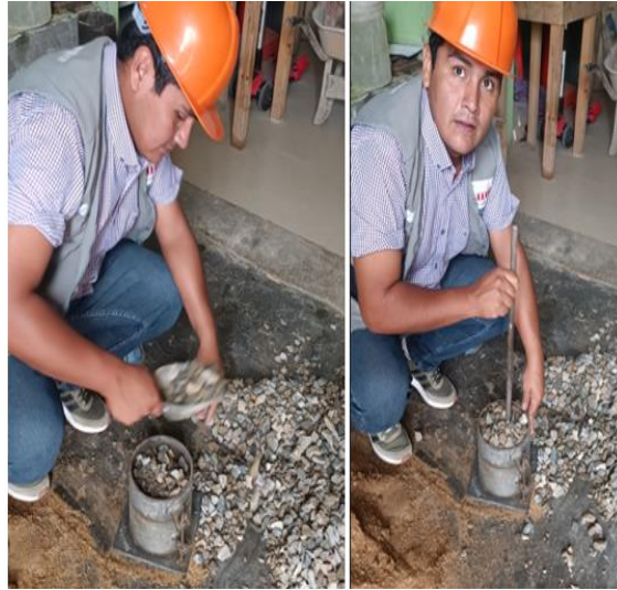
Fig. 7 Prueba para determinar el peso unitario suelto y compactado del árido grueso
