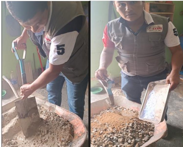
Fotografía 7. Elaboración del concreto patrón e incorporado con fibras de residuos de PVC de tapicería
