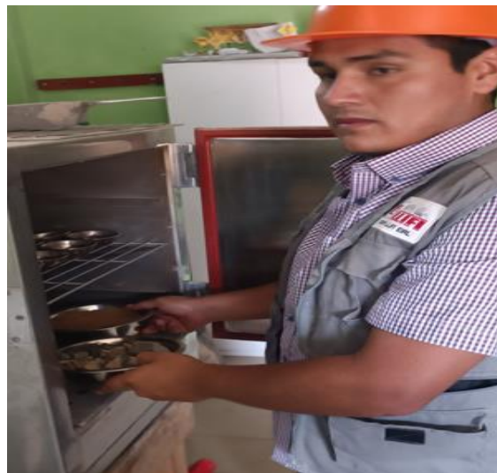
Fig. 10 Prueba para determinar el contenido de humedad del árido fino y grueso
