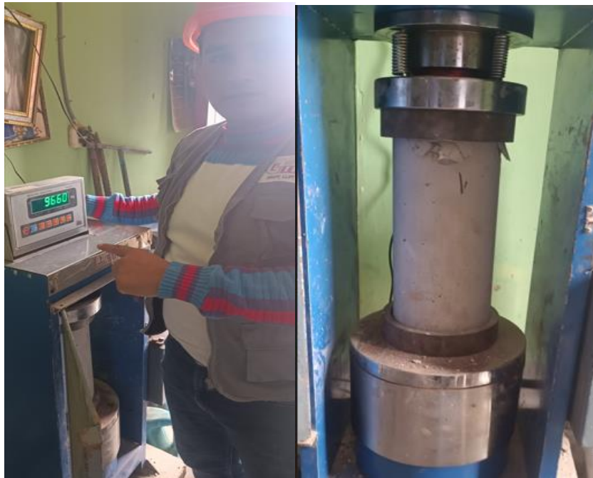
Fotografía 13. Ensayo para determinar la resistencia a la compresión del concreto
