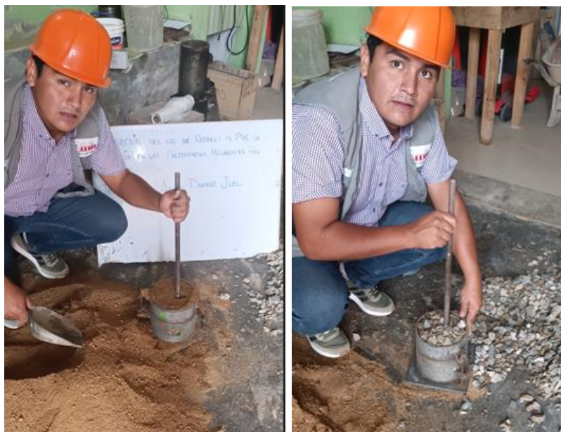
Fotografía 4. Ensayos para determinar el peso unitario para los agregados gruesos y finos
