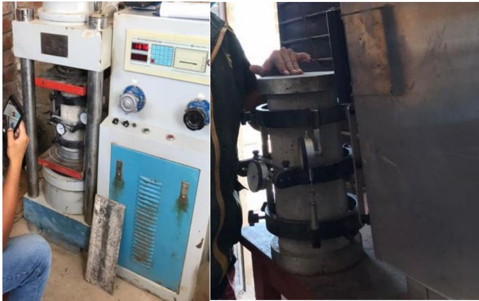
Fotografía 15. Ensayo para determinar el módulo de elasticidad del concreto
