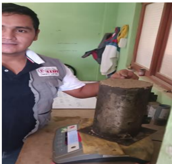
Fig. 16 Prueba para determinar el peso unitario del concreto
