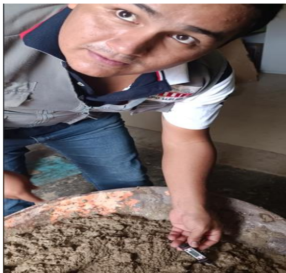
Fig. 14 Prueba para determinar la temperatura del concreto
