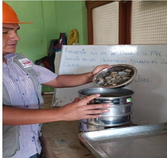
Fig. 5 Prueba para determinar el análisis granulométrico del árido grueso
