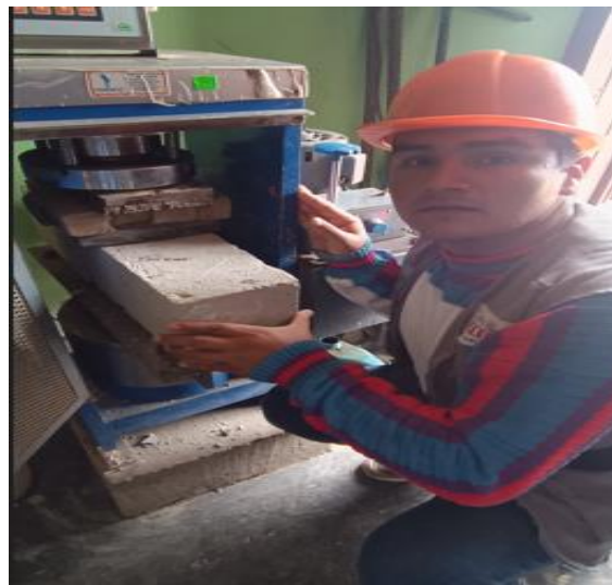
Fig. 20 Prueba de la resistencia ante los esfuerzos de flexión del concreto
