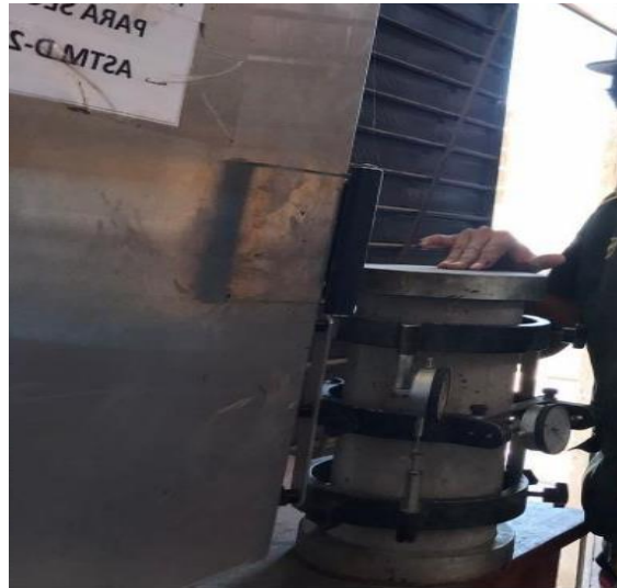
Fig. 19 Prueba para determinar el módulo de elasticidad del concreto
