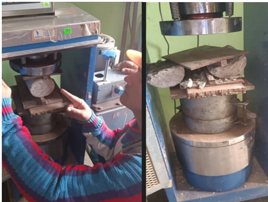
Fotografía 14. Ensayo para determinar la resistencia a la tracción del concreto
