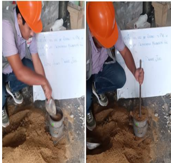
Fig. 6 Prueba para determinar el peso unitario suelto y compactado del árido fino
