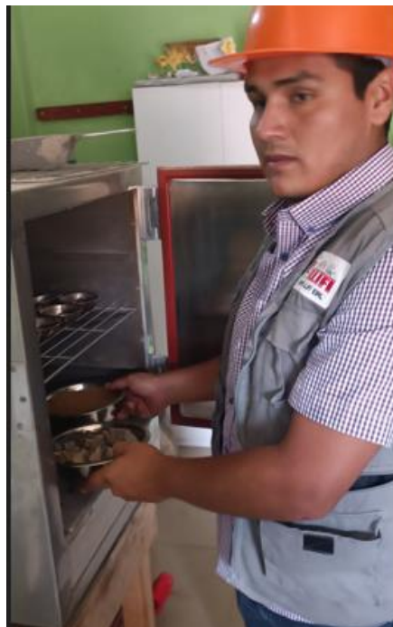
Fotografía 6. Ensayos para determinar el contenido de humedad de los agregados (fino y grueso)
