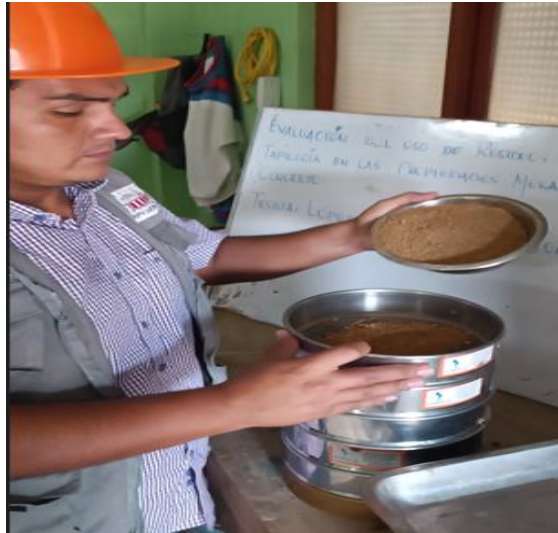
Fig. 4 Prueba para determinar el análisis granulométrico del árido fino
