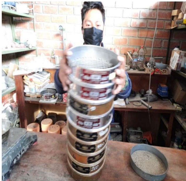
Fotografía 11: Realización de tamizado de la muestra de suelo de acuerdo al MTC.
