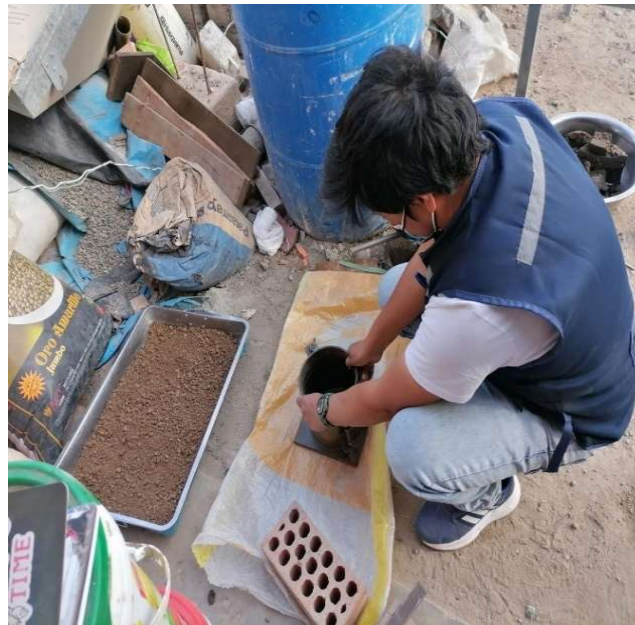
Fotografía 13: Preparación de moldes metálicos para ensayo de Proctor modificado.
