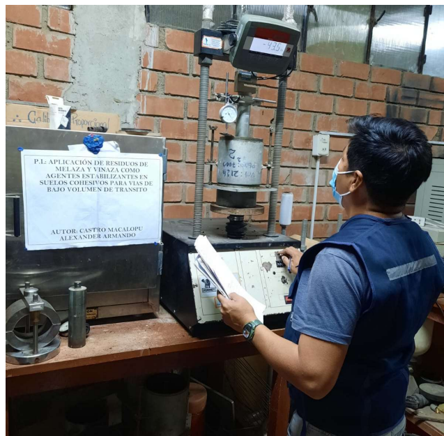
Fotografía 17: Realización de ensayo de CBR.
