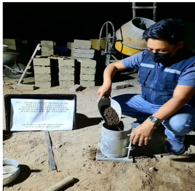
Fotografía 15: Vertido de muestra de suelo en moldes metálicos para ensayo de CBR.
