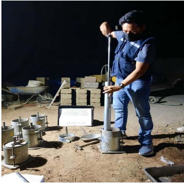
Fotografía 16: Compactación de muestra de suelo en moldes metálicos para ensayo de CBR.
