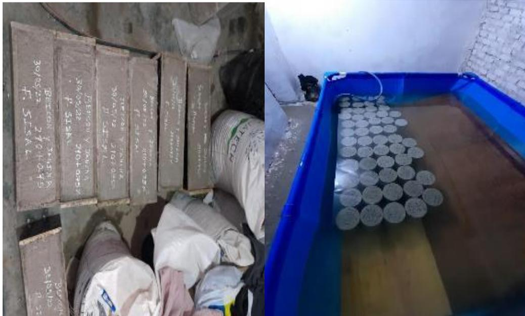
Elaboración de testigos para el concreto patrón  $F'c=210 \text{ kg/cm}^2$  y  $F'c=280 \text{ kg/cm}^2$  con adiciones de 0.25% , 0.50% , 0.75% y 1 % de fibra de coco(FCC) .
