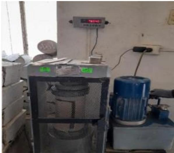
**Fig. 20.** Ruptura de testigos ensayado a compresión.
