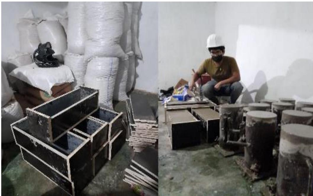
Se desencofro las muestras y se procedió a colocar una identificación, seguidamente se colocaron en una piscina para su respectivo curado.
