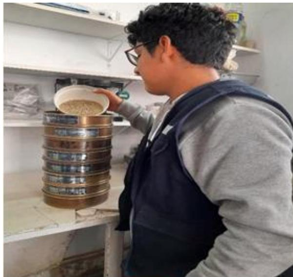
**Fig. 11.** Tamizado de agregado fino y grueso de material pétreo
