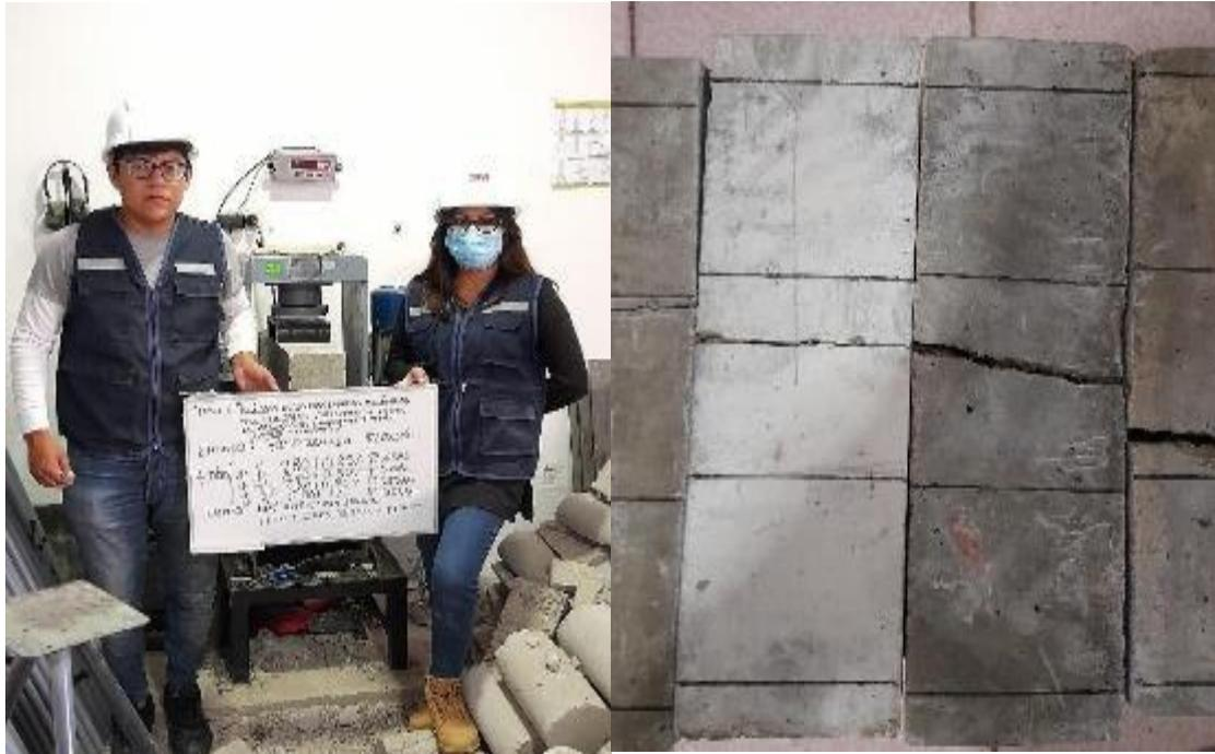
Módulo de elasticidad, ruptura de vigas a los 7, 14 y 28 días de curado.
