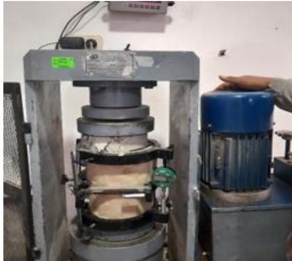
**Fig. 23.** Módulo de elasticidad a probetas de concreto.
