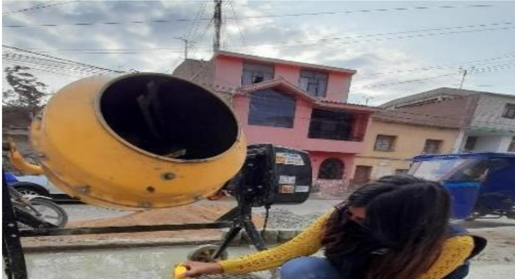
Luego de tener la mezcla lista , se procede a realizar el ensayo de asentamiento para determinar la trabajabilidad del concreto con adicionesde 0.25% , 0.50% , 0.75% y 1% de fibra de sisal ( FSS ). De tal manera para las tandas siguientes .
