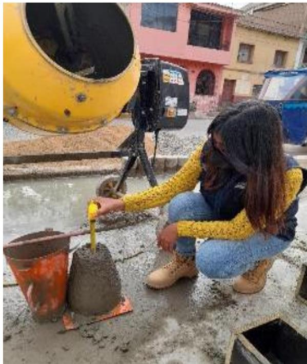
Se procede a alistar los moldes tanto de probetas como vigas para su respectivo llenado siguiendo los procedimientos según la NTP
