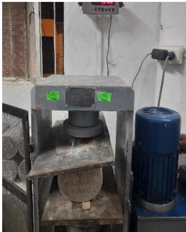
Resistencia a la Flexión, ruptura de vigas a los 7 , 14 y 28 días de curado .
