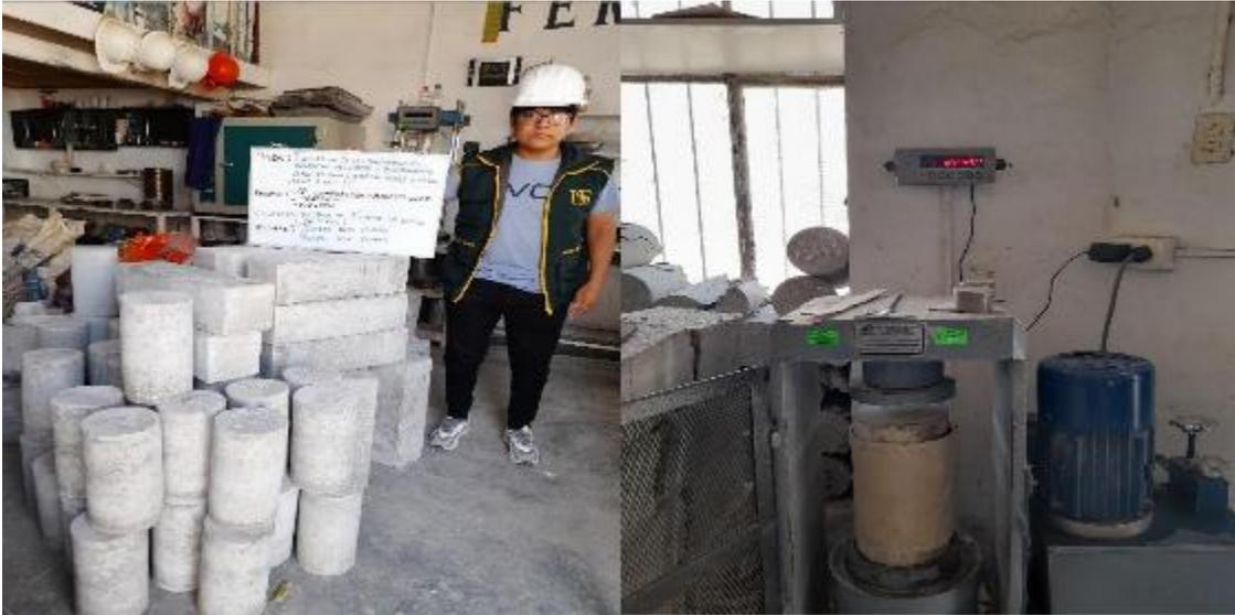
Resistencia a la tracción , ruptura de probetas a los 7 , 14 y 28 días de curado
