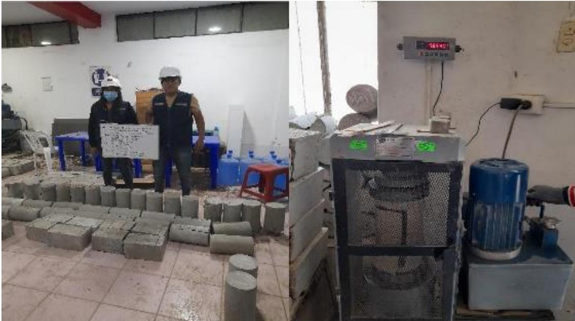
Resistencia a la tracción, ruptura de probetas a los 7, 14 y 28 días de curado
