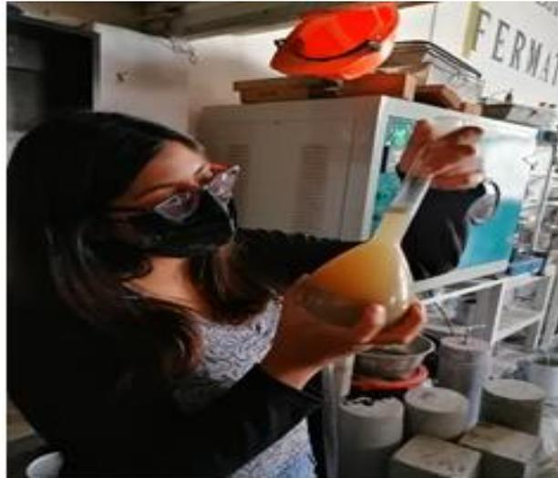
**Fig. 15.** Fiola con muestra y agua para peso específico.
