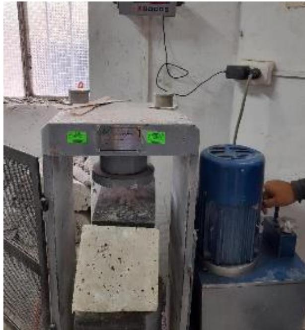
Módulo de elasticidad , ruptura de probetas a los 7 , 14 y 28 días de curado
