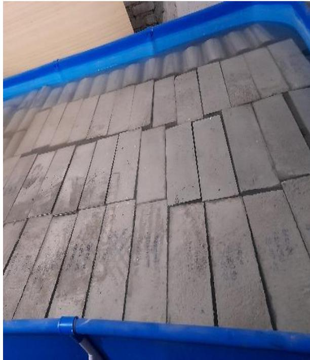
Para luego realizar los ensayos a los 7 , 14 y 28 días y determinar sus propiedades mecánicas del concreto .
