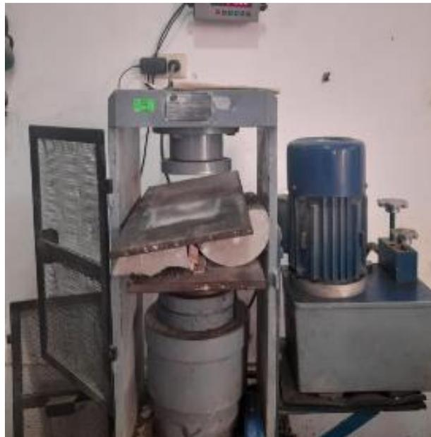
Resistencia a la flexión, ruptura de vigas a los 7, 14 y 28 días de curado
