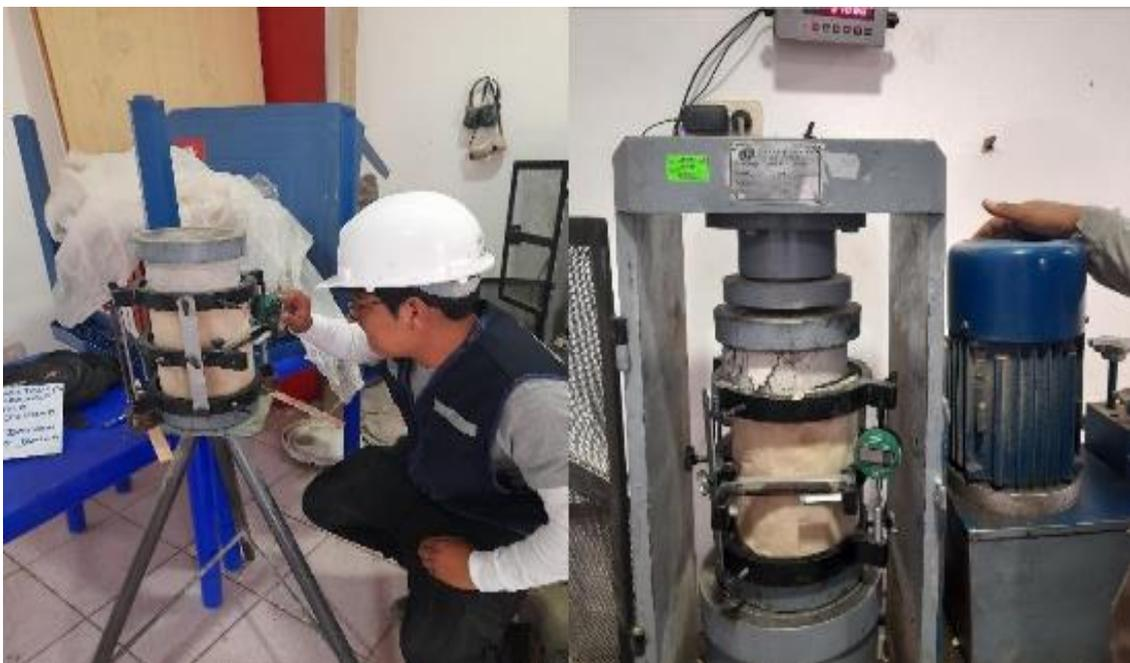
Para concreto patrón  $F'c=210 \text{ kg/cm}^2$  y  $F'c=280 \text{ kg/cm}^2$ , con adiciones de 0.25%, 0.50%, 0.75% y 1% fibra de sisal (FSS) ensayos a realizar compresión, tracción, flexión y módulos de elasticidad.
