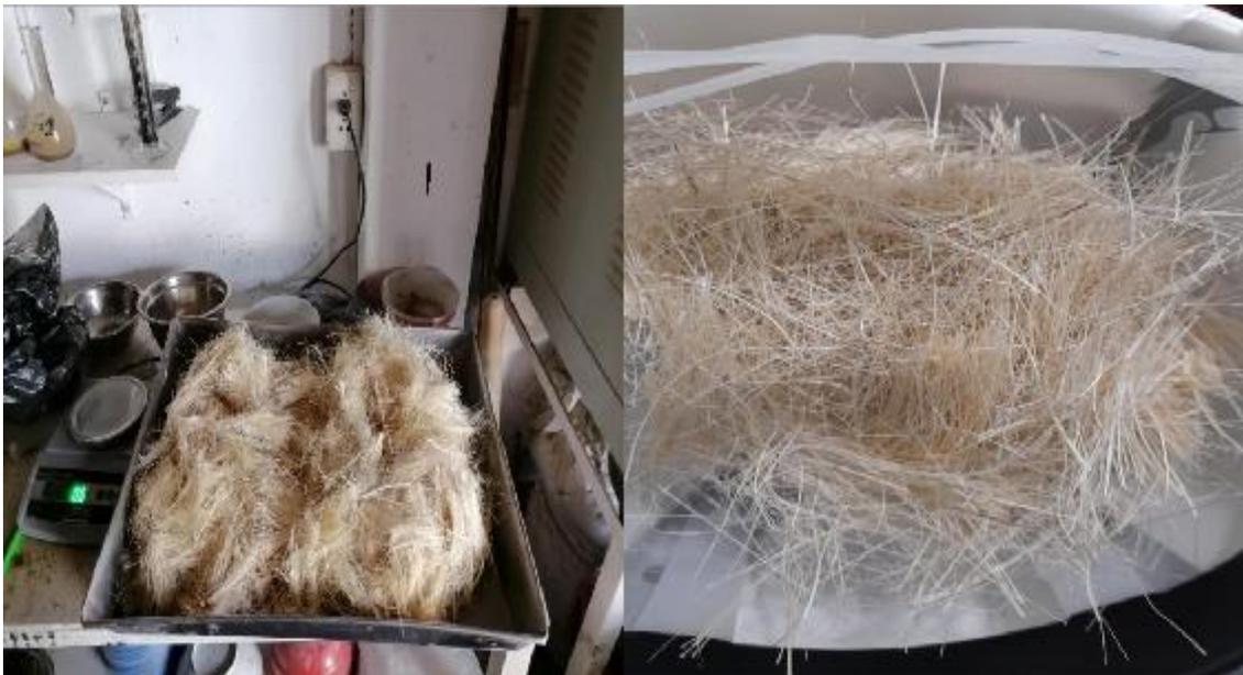
Mezclado de los agregados con la ayuda de un trompo , la fibra se debe de integrar de manera continua para que su integración sea uniforme .Tal procedimiento de debe realizar para las mezclas siguientes
