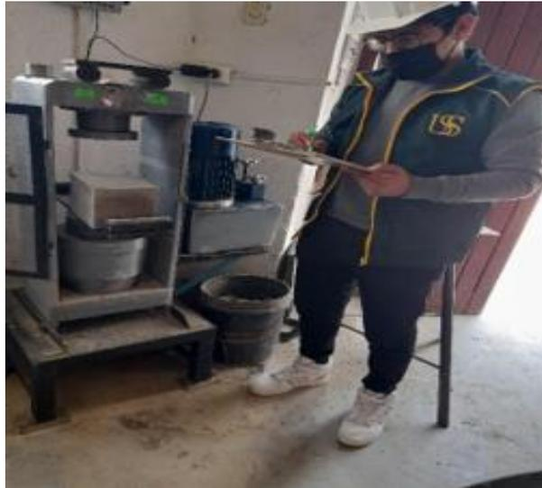
**Fig. 22.** Ensayo a flexión, ruptura de vigas.
