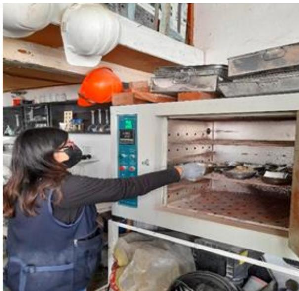
**Fig. 13.** Colocación de muestra al horno para contenido de humedad.
