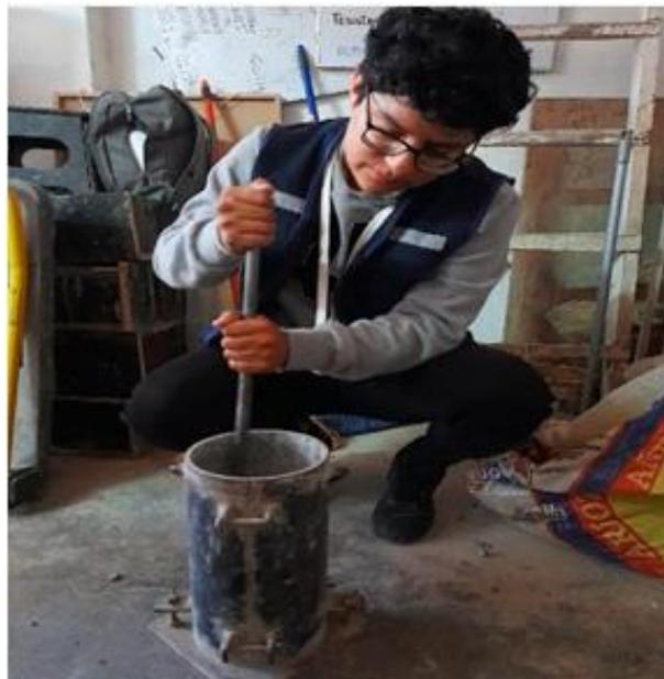
**Fig. 12.** Pesos unitarios compactados de los agregados gruesos.
