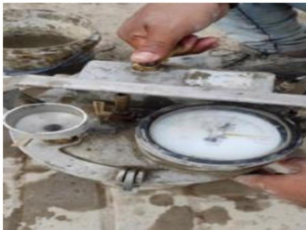
**Fig. 19.** Medición de contenido de aire en concreto fresco.
