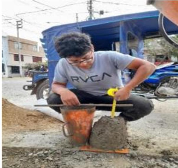
**Fig. 17.** Medición del asentamiento en concreto fresco.
