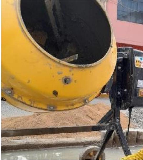
Luego de tener la mezcla lista , se procede a realizar el ensayo de asentamiento para determinar la trabajabilidad del concreto con adicionesde 0.25% , 0.50% , 0.75% y 1% de fibra de coco ( FCC ). De tal manera para las tandas siguientes .
