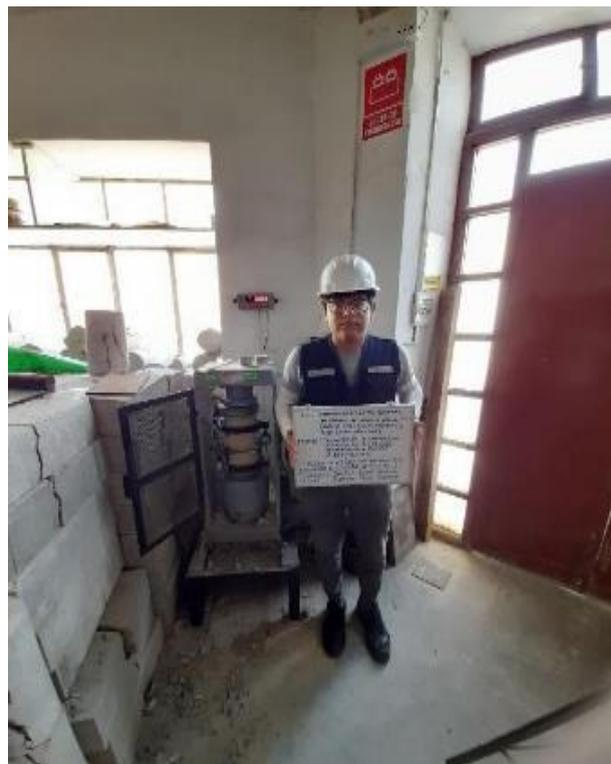
Para concreto patrón  $F'c=210 \text{ kg/cm}^2$  y  $F'c=280 \text{ kg/cm}^2$  , con adiciones de 0.25% , 0.50% , 0.75% y 1 % fibra de coco (FCC) ensayos a realizar compresión, tracción, flexión y módulos de elasticidad.
