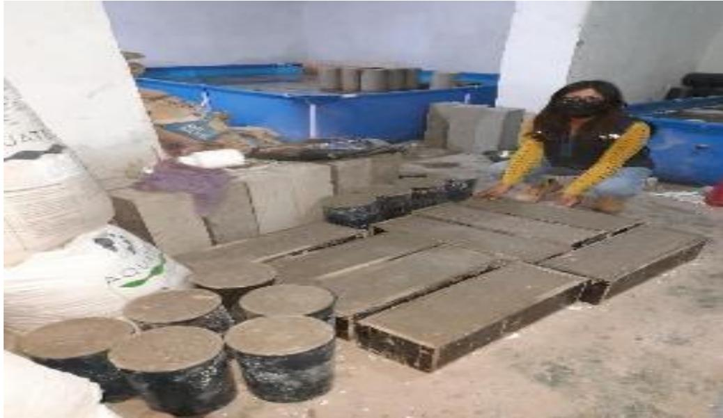
Se desencofro las muestras y se procedió a colocar una identificación . Seguidamente se colocaron en una piscina para su respectivo curado
