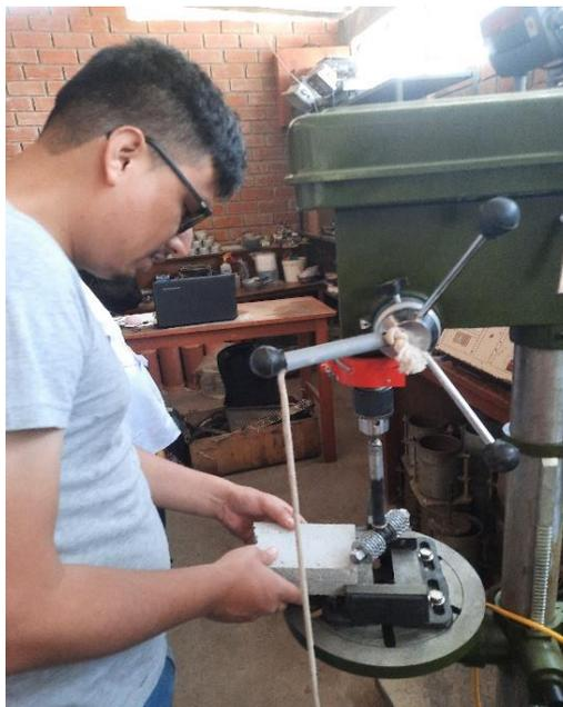
**Fig. 13.** Ensayo de abrasión del adoquín de concreto.
