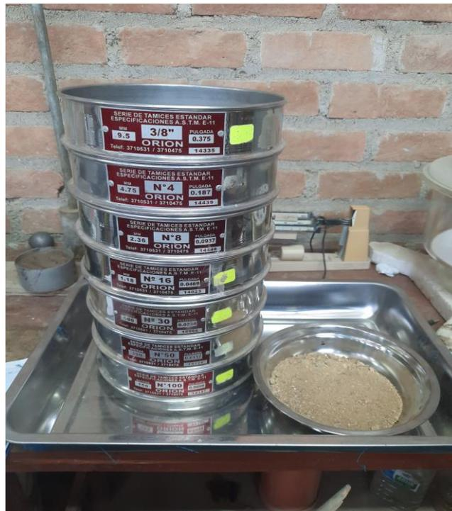
**Fig. 5.** Análisis granulométrico.
