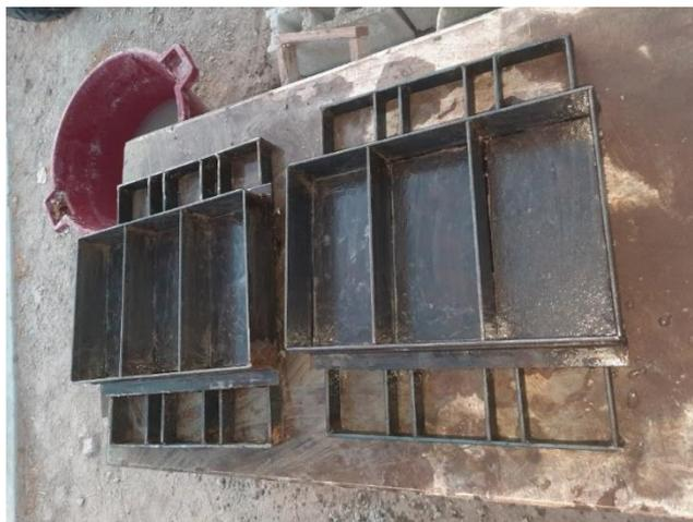
**Anexo 06.6. Moldes de adoquines de concreto.**
