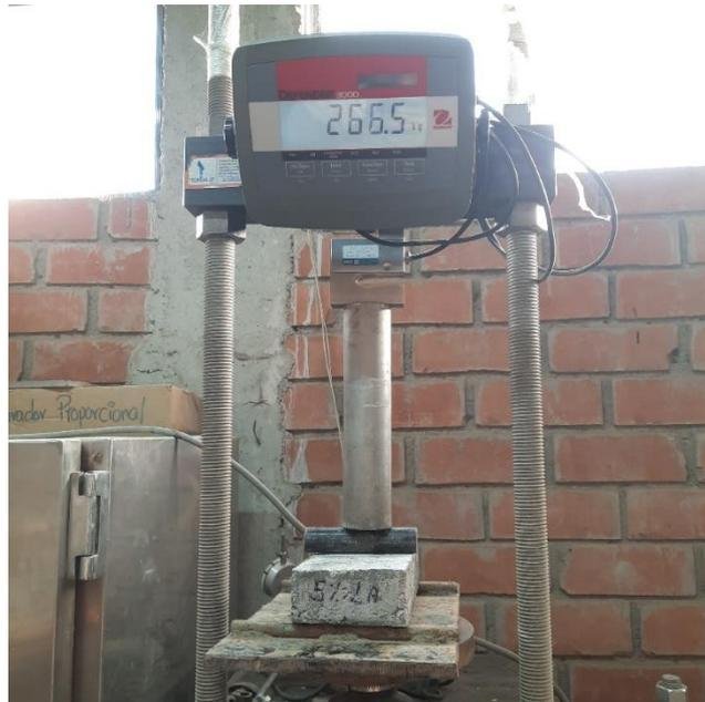
**Anexo 06.14. Resistencia a la flexión del adoquín de concreto.**
