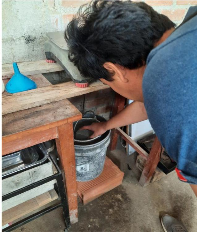
**Fig. 12.** Ensayo de absorción del adoquín de concreto
