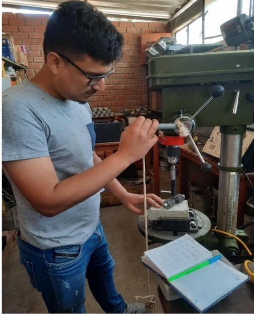
**Anexo 06.9. Ensayo de resistencia a la flexión del ad quin de concreto**
