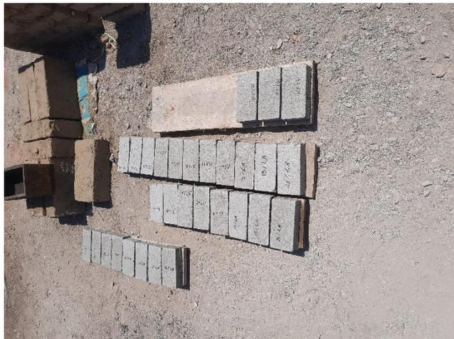
**Fig. 11.** Secado de adoquines
