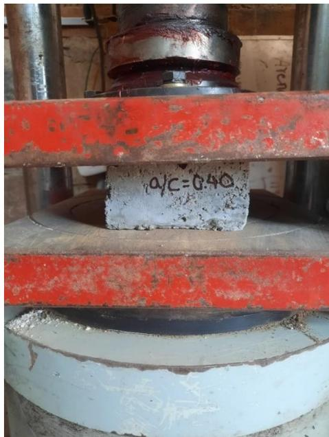
**Anexo 06.12. Resistencia a la compresión adoquín de concreto,  $a/c=0.40$ .**
