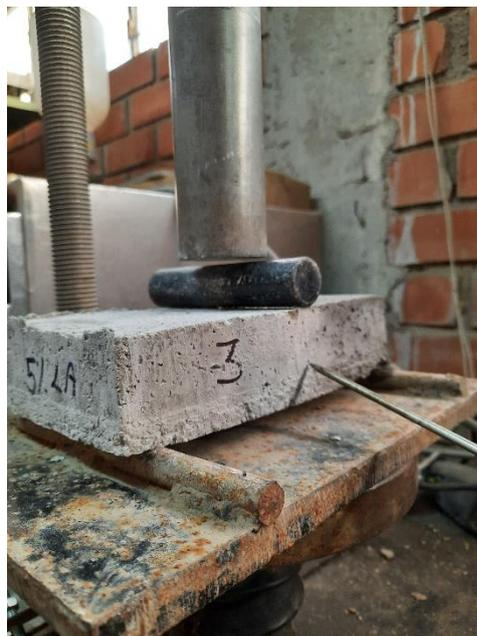
**Fig. 15.** Ensayo de resistencia a flexión del adoquín de concreto.
