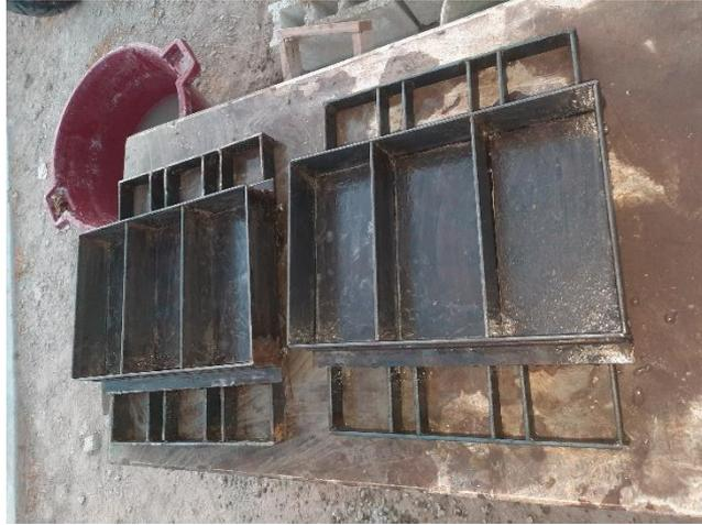
**Fig. 8.** Moldes para los adoquines de concreto
