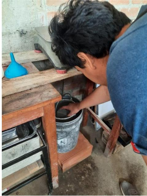
**Anexo 06.13. Absorción del adoquín de concreto**
