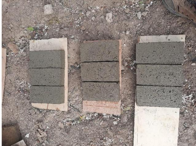
**Fig. 10.** Desencofrado de adoquines
