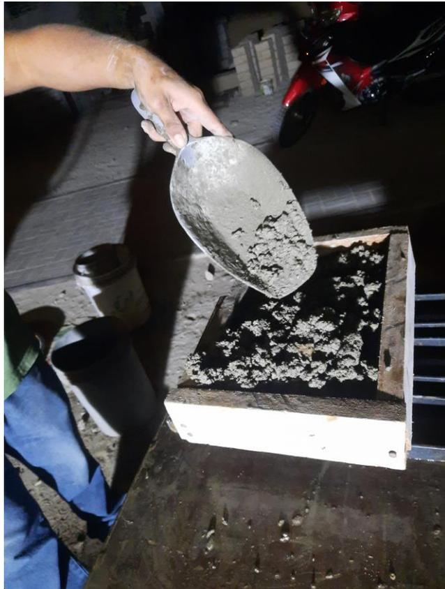
**Fig. 9.** Vaciado de mezcla en los moldes de adoquines
