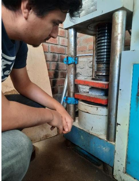
**Fig. 14.** Ensayo de resistencia a compresión del adoquín de concreto.
