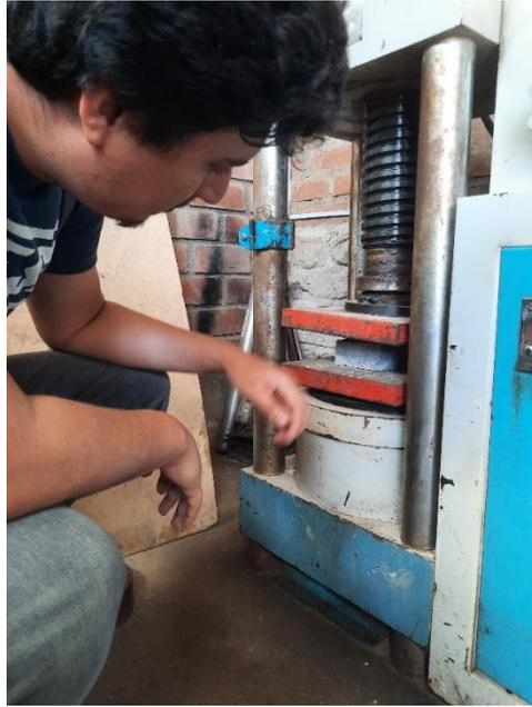
**Anexo 06.11. Resistencia a la compresión adoquín de concreto**
