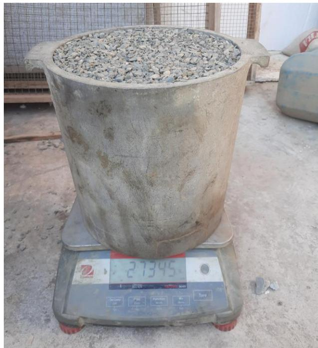
**Fig. 6.** Peso unitario del agregado grueso.
