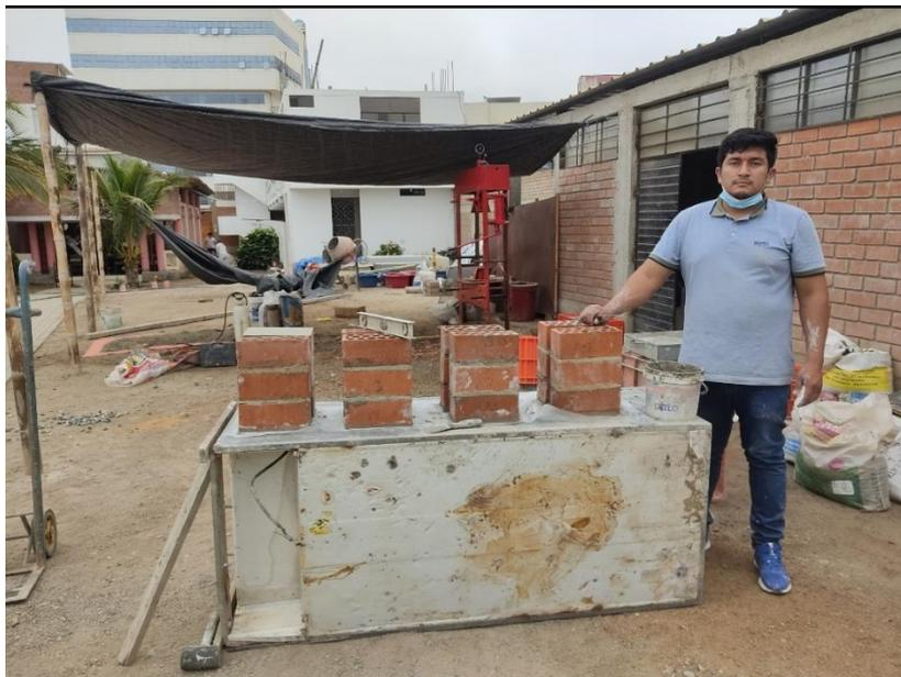
Falla de prismas de albañilería por compresión axial
