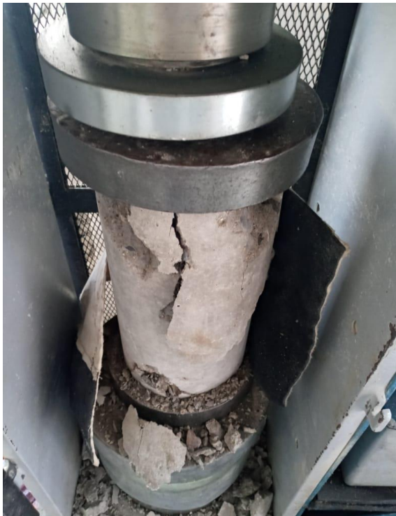
b) Muestras de concreto patrón ensayadas por el ensayo de resistencia a la compresión
