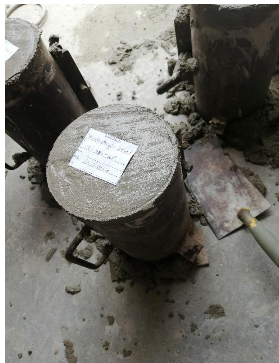
d) Colocación de nomenclatura de cada espécimen de concreto para su posterior curado
