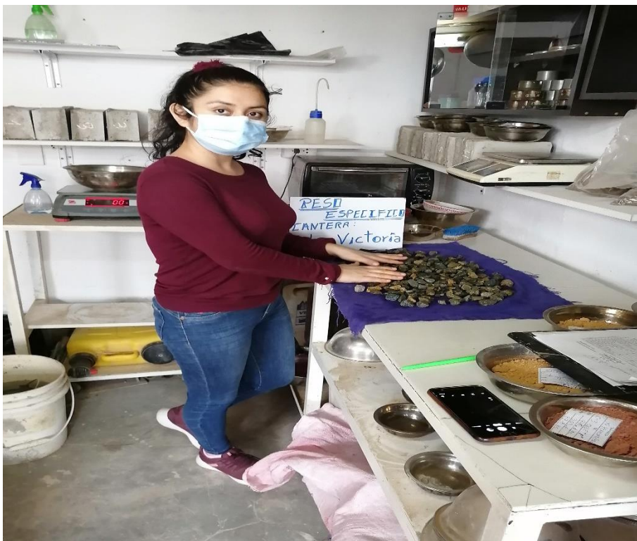
c) Ensayo de peso unitario suelto y compactado
