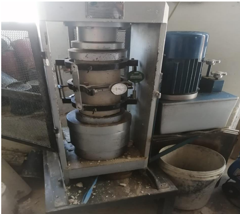
d) Muestras de concreto patrón ensayadas por el ensayo de módulo de elasticidad
