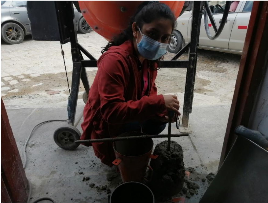
a) Medición del asentamiento, verificando que este en el rango 3" a 4" – Concreto Patrón
