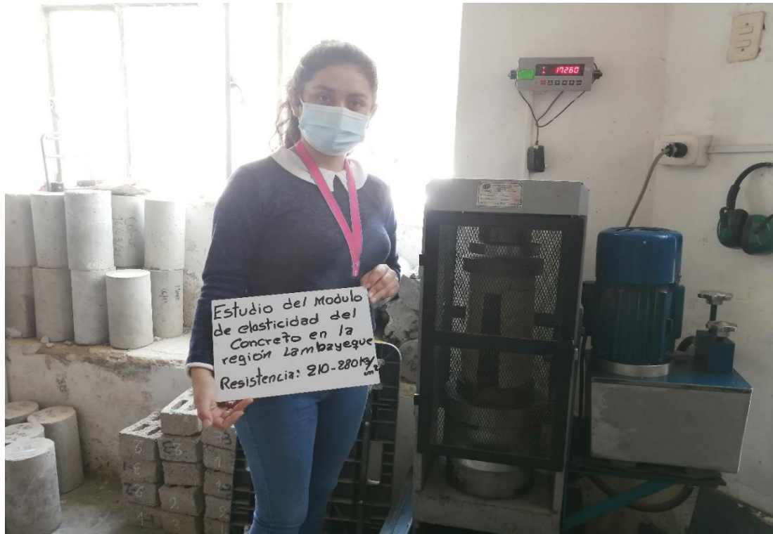
a) Ensayo de resistencia a compresión
