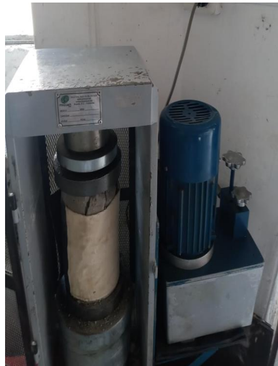
b) Muestras de concreto patrón ensayadas por el ensayo de resistencia a la compresión
