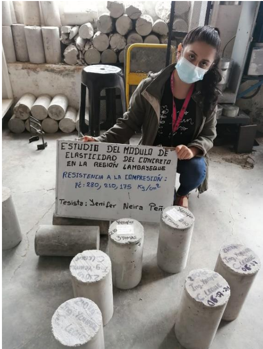
e) Desencofrado de probetas
