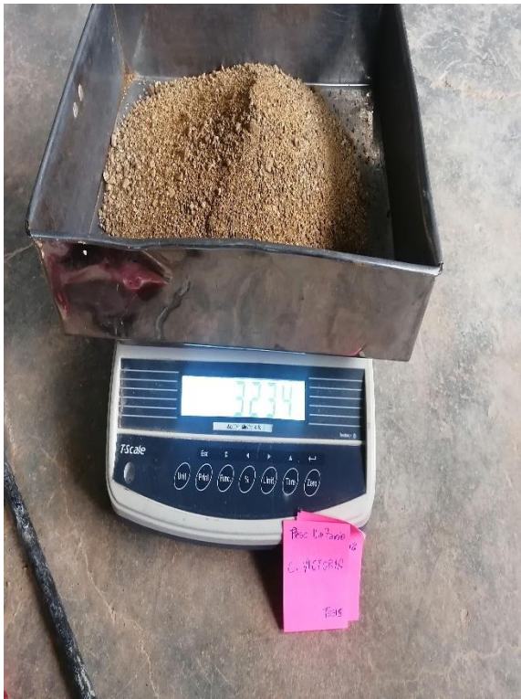
c) Ensayo de peso unitario suelto y compactado
