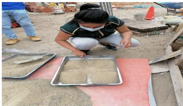
**Fig. 15.** Cuarteo de agregado fino
