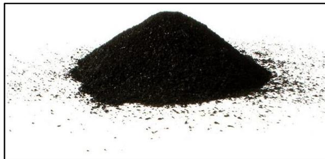
**Fig. 4.** Caucho Granulado. [22]
