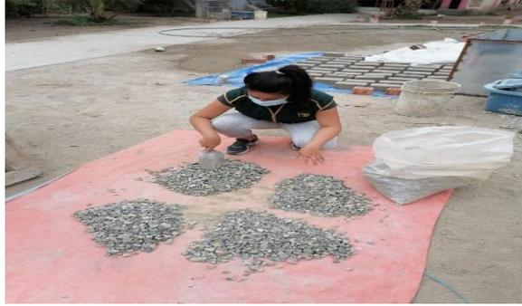
**Fig. 16.** Cuarteo de agregado grueso
