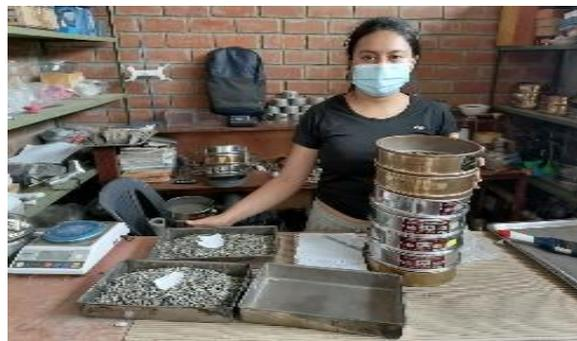
**Fig. 17.** Granulometría de agregado grueso
