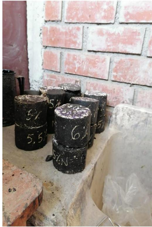
3. Ensayos a la muestra modificada con fibras de acero y caucho
