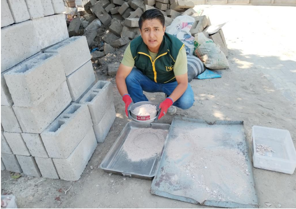
Tamizado de Conchas de abanico trituradas
