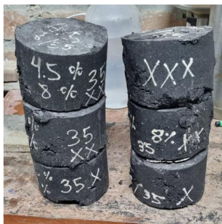
Figura 4. Briquetas para ensayos con método Marshall
