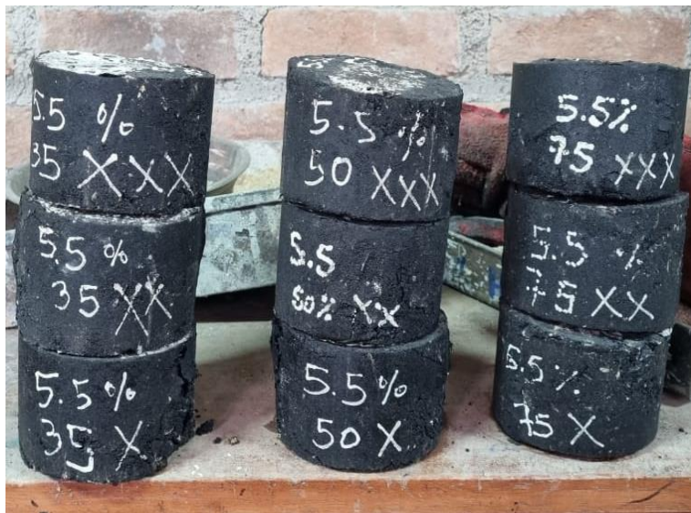
Briquetas para 3 tipos de tránsito
