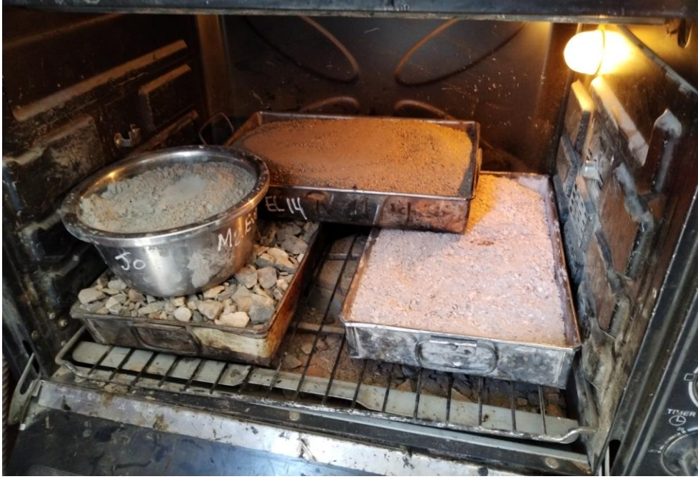
Calentamiento de materiales a 140° para fabricación de briquetas
