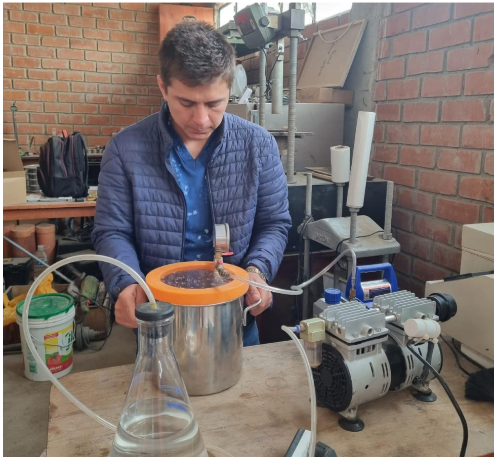
Ensayo de Rice de la mezcla asfáltica
