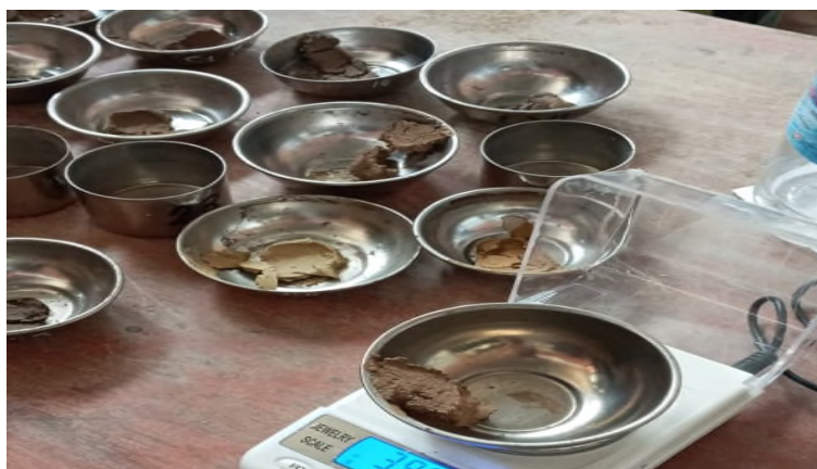
Fig. 18. Pesado de muestra secas del LL
