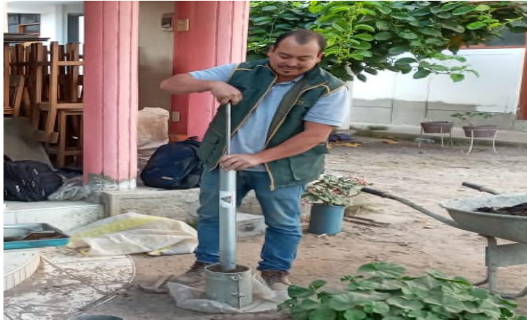
Fig. 21. Compactación para CBR
