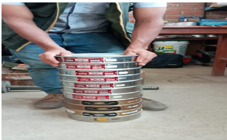
Fig. 17. Tamizado del suelo
