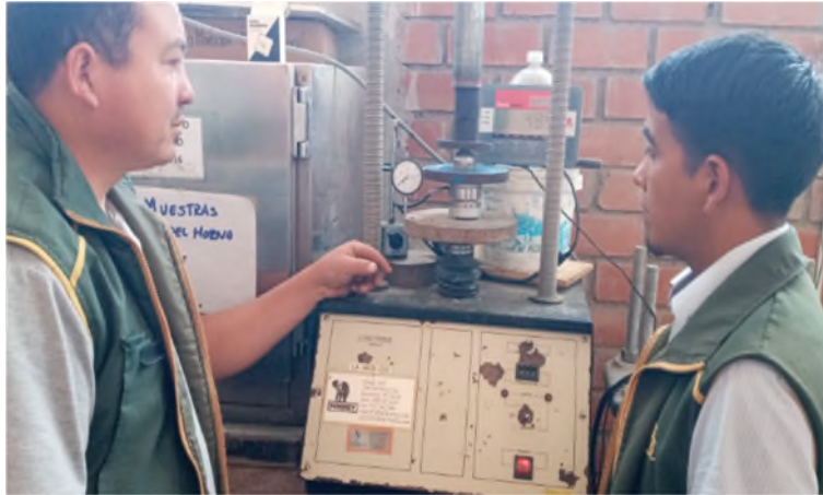
Fig. 14. Ensayo UCS para la CCA
