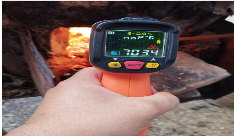
Fig. 9. Quemado de la cascarilla de oryza sativa
