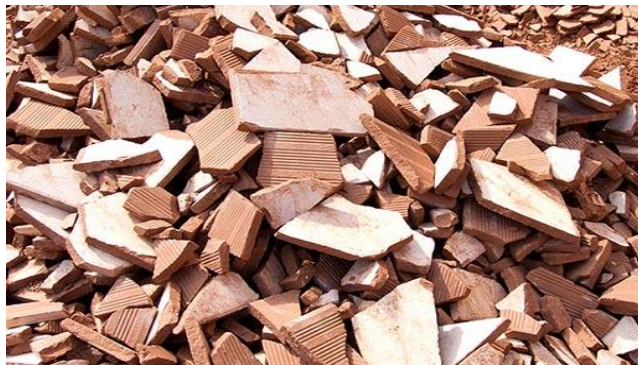
Fig. 10. Residuo en ladrillos triturados. [51]
