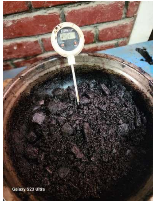
Foto. 6: Mezcla asfáltica a 140 °C
