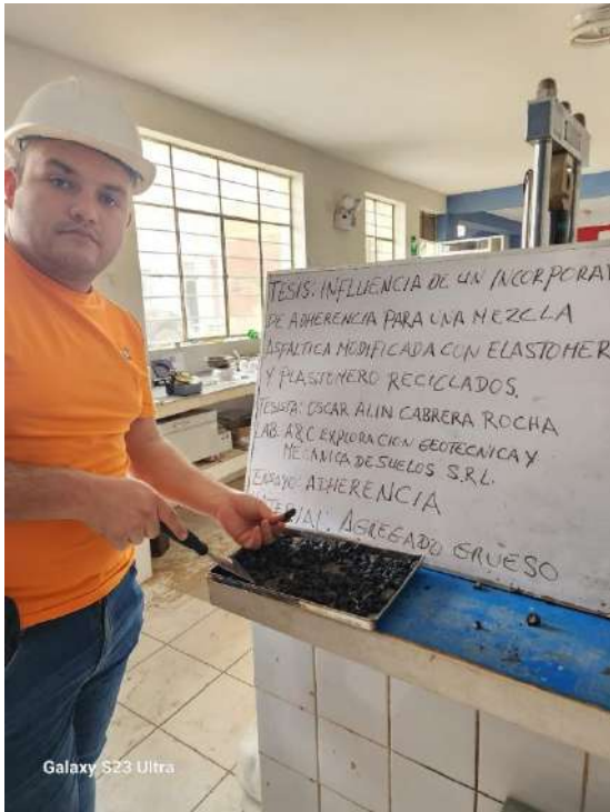
Foto. 11: Visualización del agregado bañado en asfalto Pen 60/70
