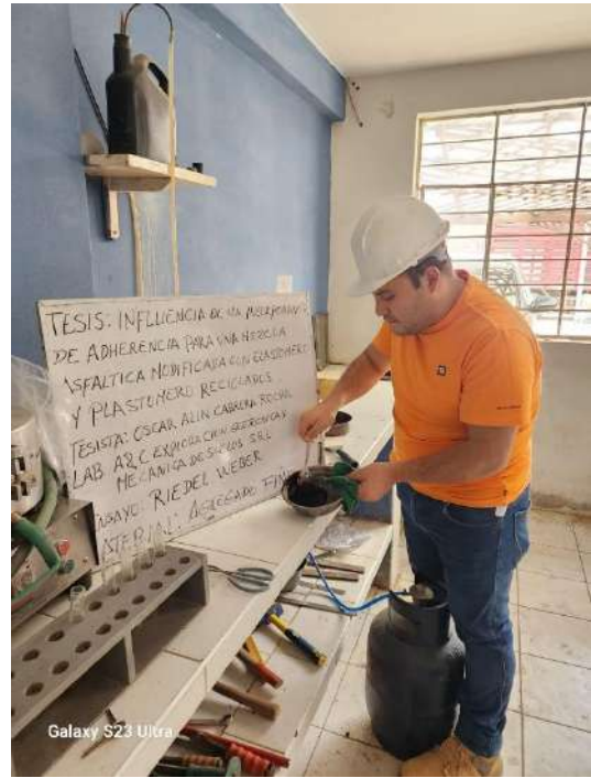
Foto. 10: Proceso de ensayo de Adherencia – método Riedel Weber
