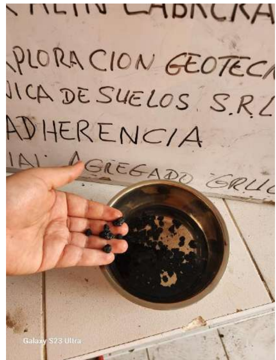
Foto. 12: agregado puesto en agua destilada para la definición del ensayo
