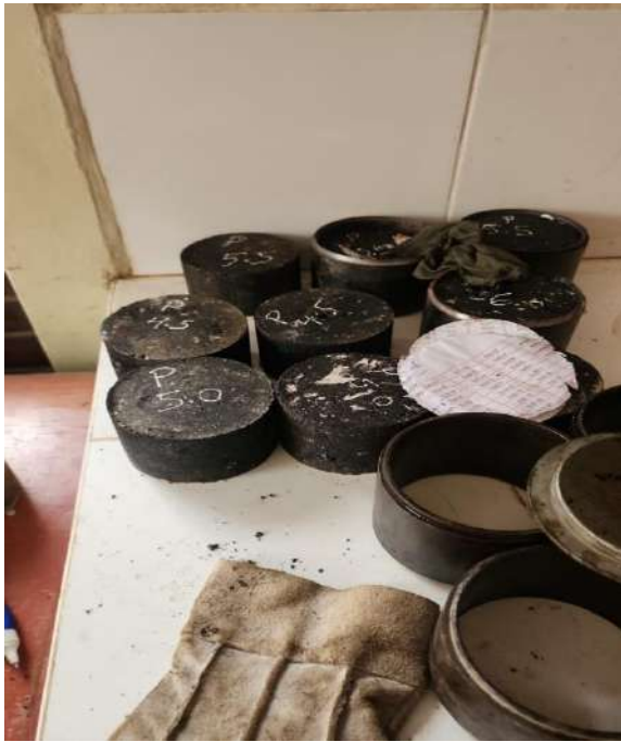
Foto. 5: Briquetas de mezcla asfáltica
