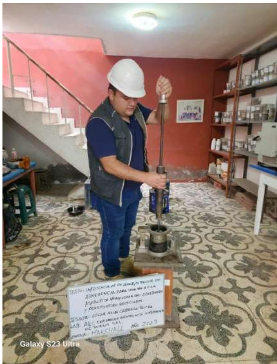
Foto. 7: Compactación de mezcla asfáltica 75 golpes
