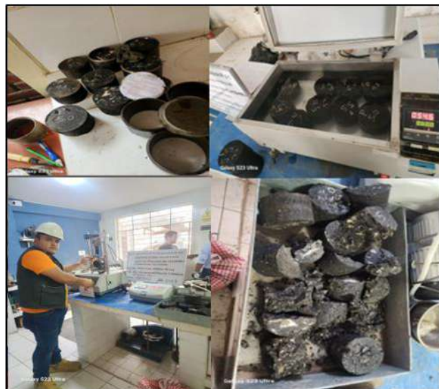
Fig. 12. Aplicación de Marshall a briquetas
