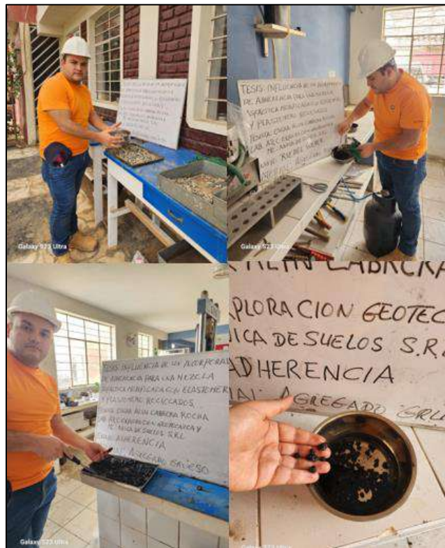
Fig. 10. Proceso de ensayo de adherencia
