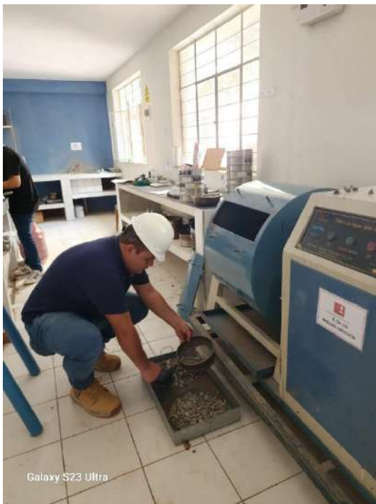
Foto. 3: Cuarteo de agregados
