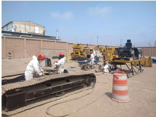
**Fig 9** Armado de componentes de excavadora CAT 312, que serán enviadas al proyecto Plus Petrol en Malvinas - Cusco
