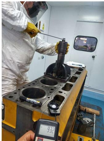
**Fig 8** Montaje y medición de altura de camisa en motor (equipo pesado)
