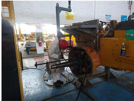
**Fig 7** Instalación de eje de mando final derecho de equipo pesado, que se enviará a Obra de Quellaveco (Moquegua)
