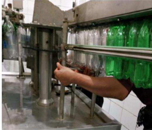
**Figura 29:** Calibrado de lavado de botellas
