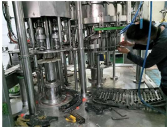
**Figura 32:** Calibrado de varillas
