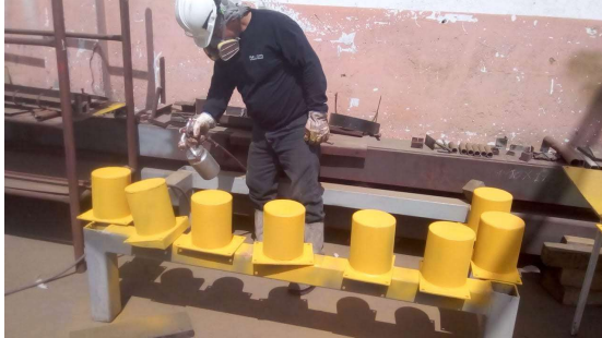
Foto 5: Trabajador haciendo uso de los EPP correspondientes
