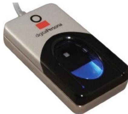
**Fig. 18.** Imagen del Lector óptico “U.are.U 4500”, marca de DigitalPersona, utilizado para el escaneo de huellas dactilares. Fuente: Elaboración Propia
