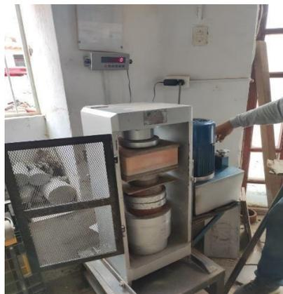
**Anexo 8:** Ensayo de laboratorio de las propiedades mecánicas del mortero de albañilería y Certificados
