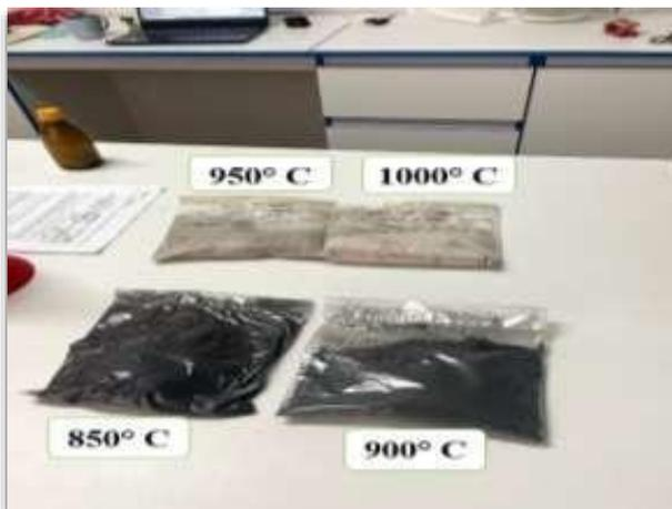
**Fig. 17.** Aspecto físico y químico en ceniza de carbón
