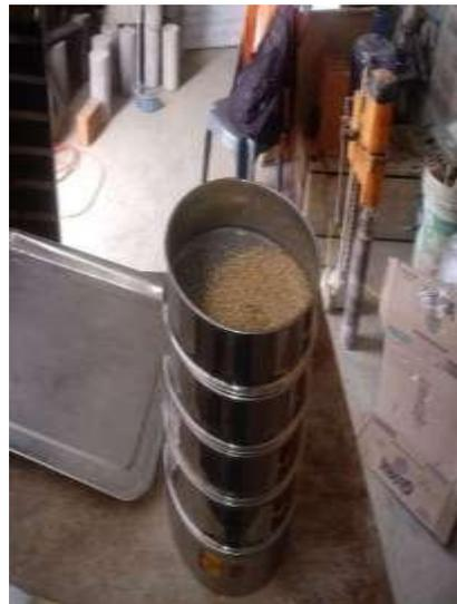
**Fig. 25.** Análisis granulométrico
