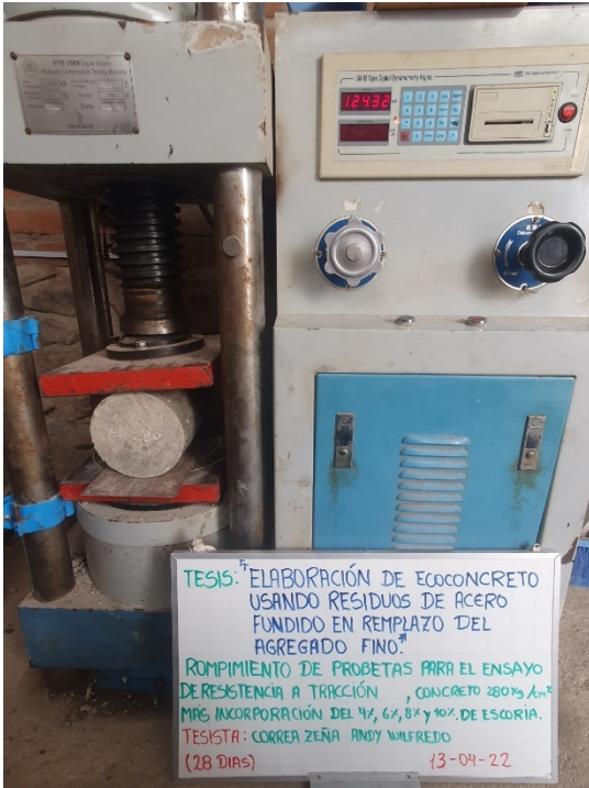
Fig. 29. Ensayo tracción probetas 280 kg/cm 2 – 28 días
