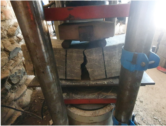
Fig. 31. Ensayo tracción vigas 210 kg/cm 2 – 28 días
