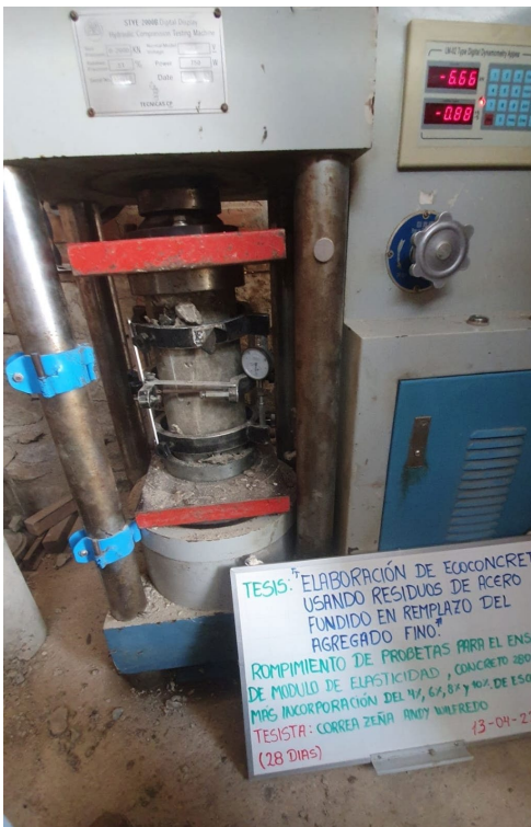
Fig. 34. Ensayo módulo de elasticidad probetas 280 kg/cm 2 – 28 días
