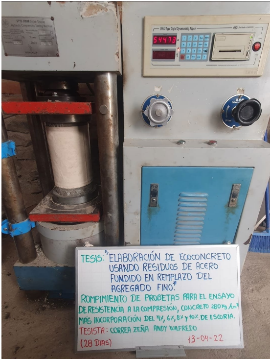
Fig. 33. Ensayo compresión probetas 280 kg/cm 2 – 28 días
