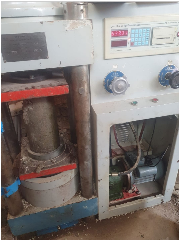
Fig. 32. Ensayo tracción probetas 210 kg/cm 2 – 14 días
