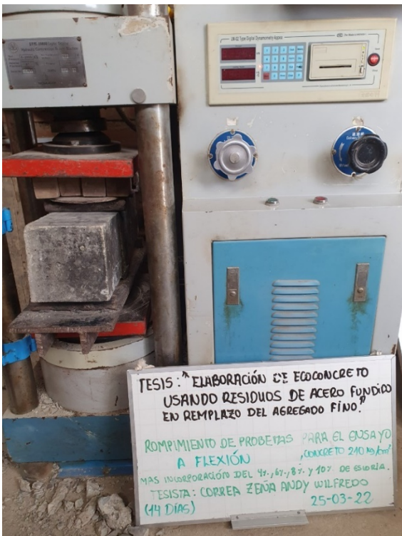
Fig. 24. Ensayo tracción probetas 210 kg/cm 2 – 14 días
