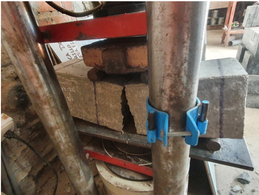
Fig. 26. Ensayo tracción vigas 280 kg/cm 2
