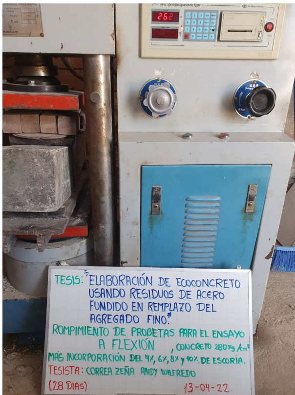
Fig. 20. Ensayo flexión probetas 280 kg/cm 2 – 28 días
