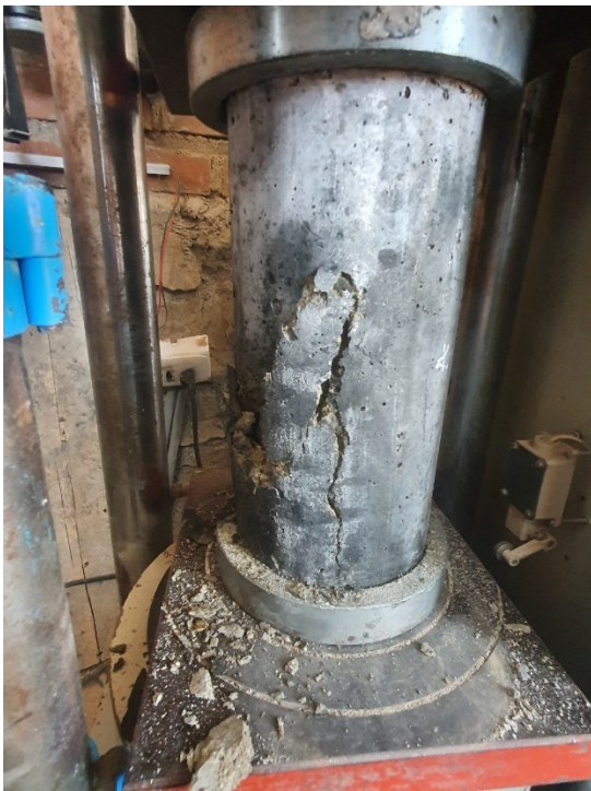
Fig. 28. Ensayo compresión probetas 280 kg/cm 2 – 14 días
