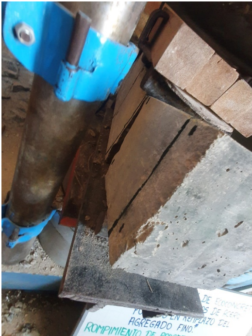
Fig. 30. Ensayo tracción vigas 210 kg/cm 2 – 14 días
