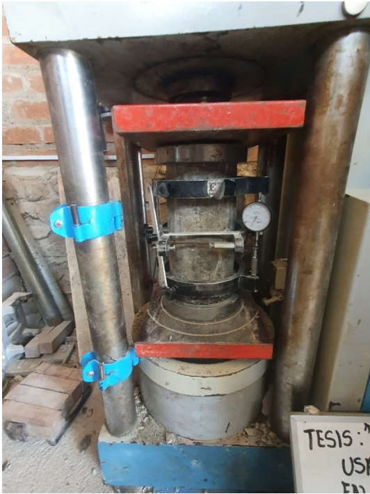
Fig. 21. Ensayo compresión probetas 280 kg/cm 2 – 28 días
