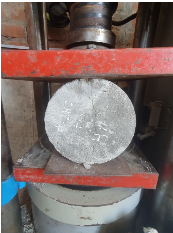
Fig. 22. Ensayo tracción probetas 280 kg/cm 2 – 14 días
