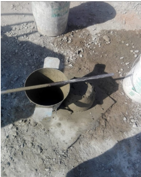
Fig. 16. Slump mezcla de concreto
