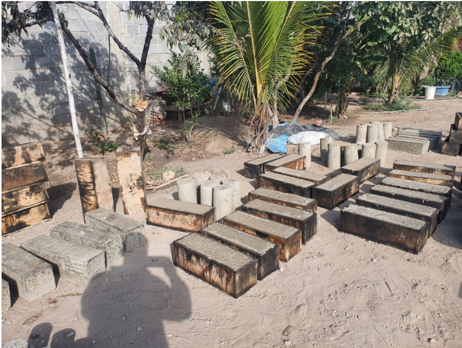
Fig. 19. Secado de vigas
