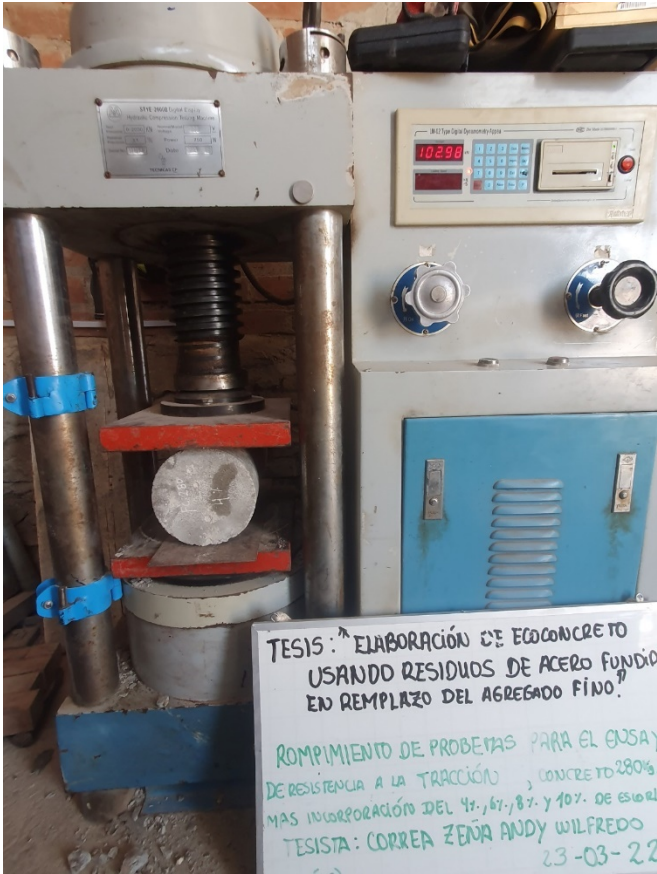
Fig. 25. Ensayo tracción probetas 280 kg/cm 2 –28 días
