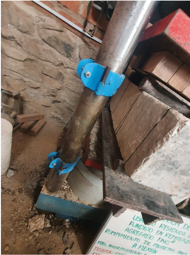
Fig. 27. Ensayo tracción vigas 210 kg/cm 2
