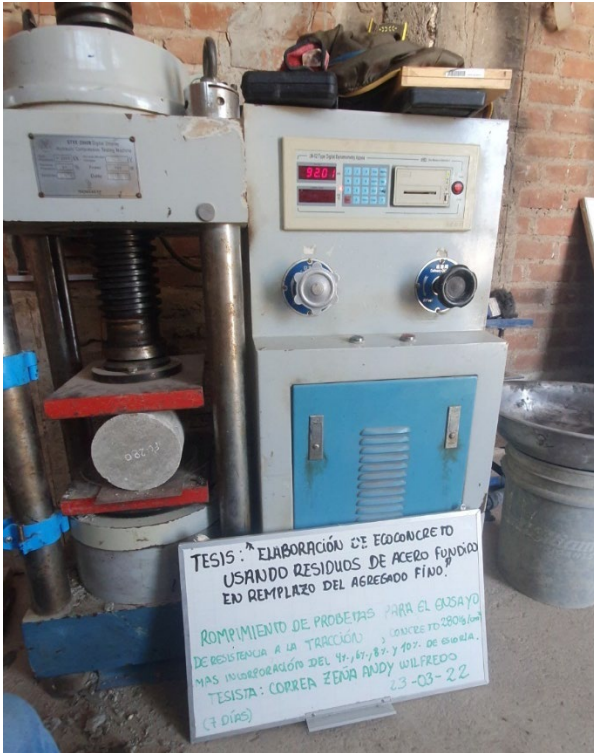
Fig. 23. Ensayo tracción probetas 280 kg/cm 2 – 7 días
