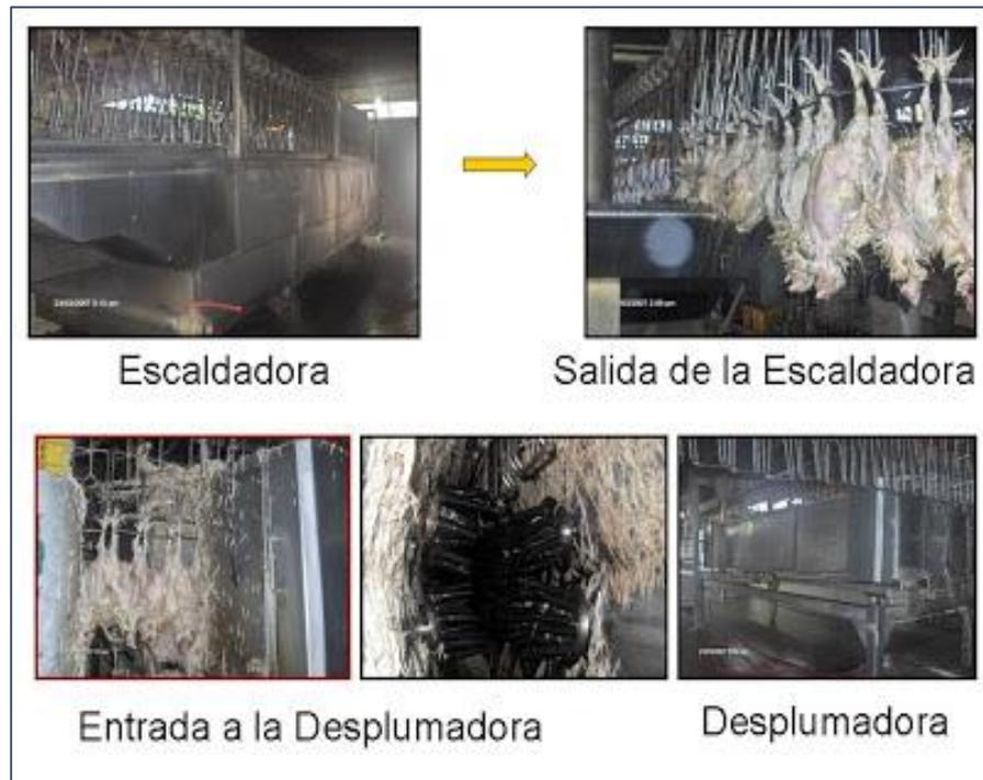
**Figura 5** Fases de Escaladora y Desplumadora
