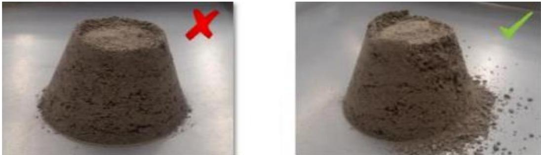
**Fig. 8:** Condición SSS para árido, con poco o nada de material grueso [75].
