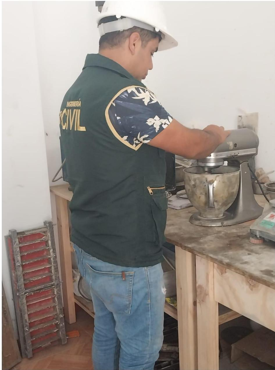
**Fig. 28.** Preparación de Mortero.
