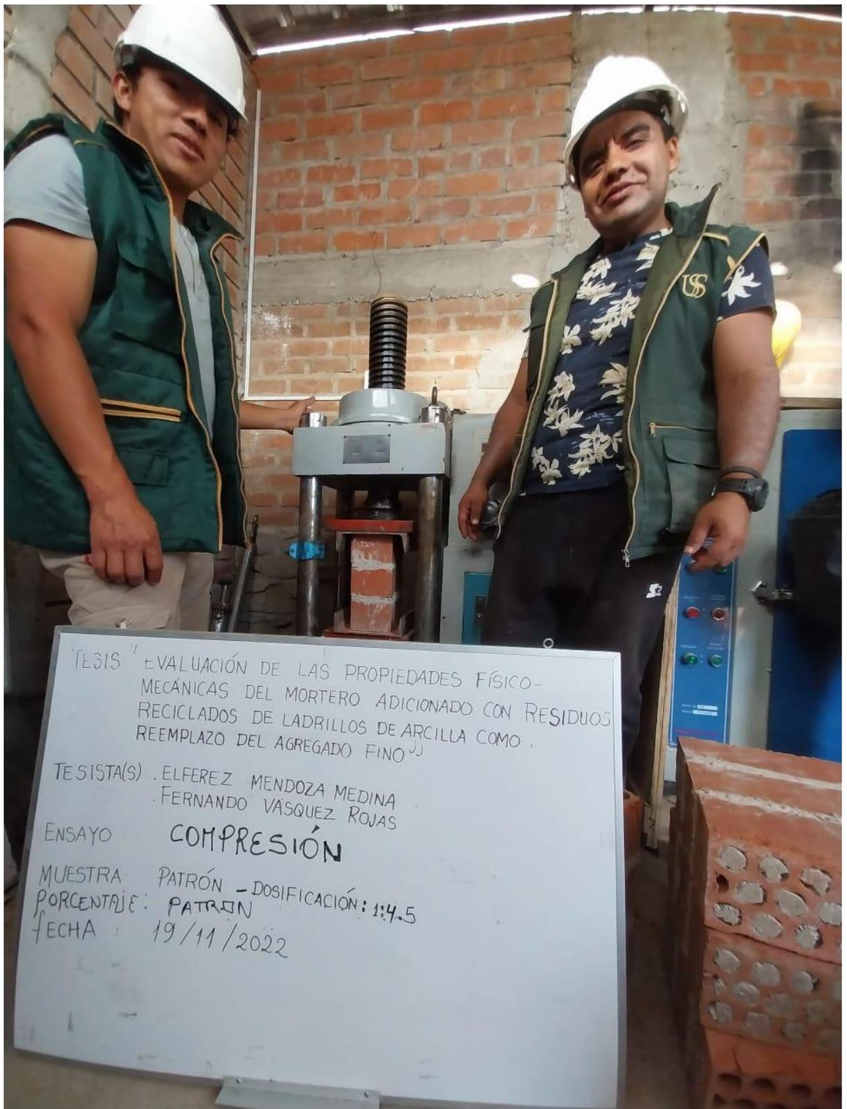
Fig. 33. Prisma ensayando a resistencia a compresión axial.
