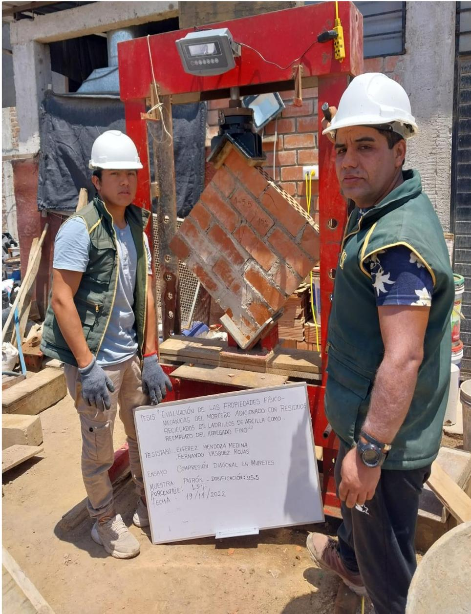
**Fig. 31.** Resistencia a la compresión diagonal de muretes.
