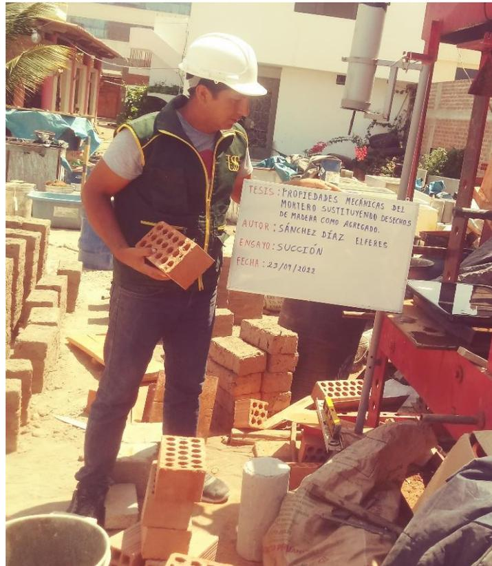
**Fig. 39.** Absorción de unidades de albañilería
