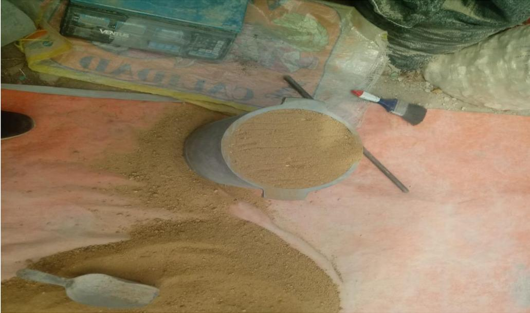
**Fig. 34.** Peso unitario suelto del agregado fino
