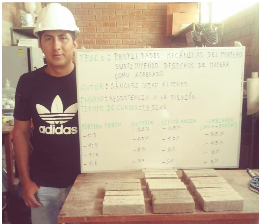
Fig. 44. Ensayo “Resistencia a la flexión”
