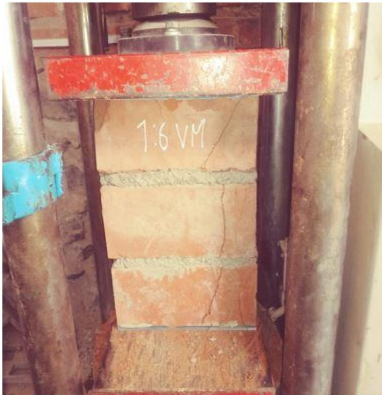
**Fig. 50.** Prisma ensayado a resistencia a compresión axial
