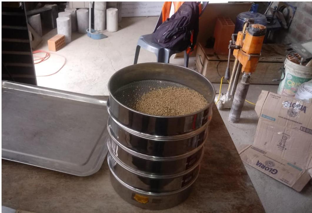
**Fig. 33.** Análisis granulométrico del agregado fino
