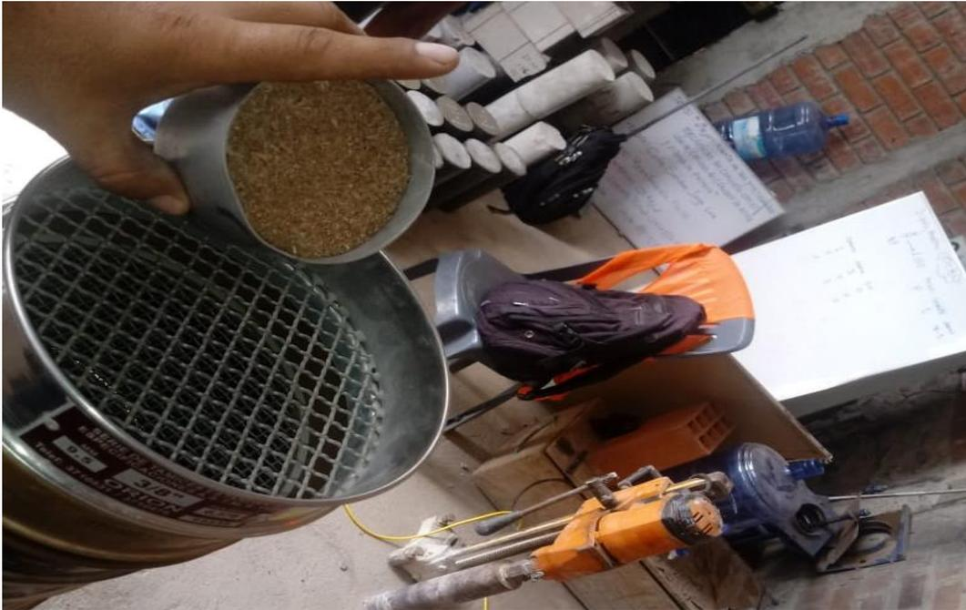
**Fig. 32.** Análisis granulométrico de los desechos de madera
