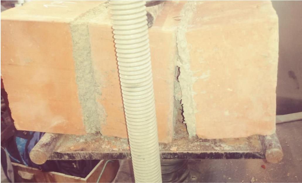
**Fig. 49.** Pila ensayada a resistencia a la adherencia por flexión
