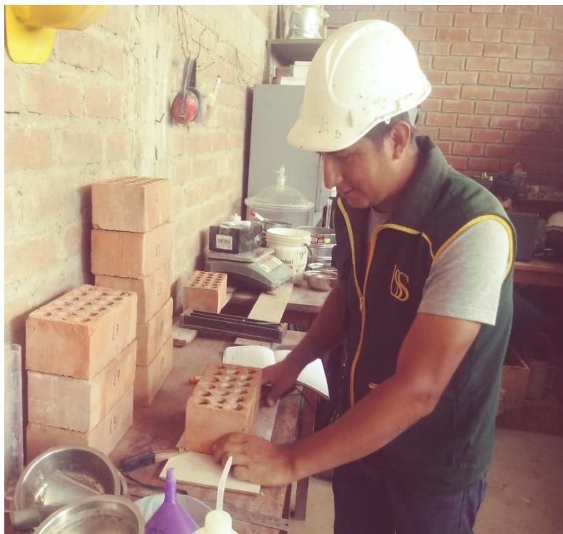
**Fig. 40.** Alabeo de unidades de albañilería
