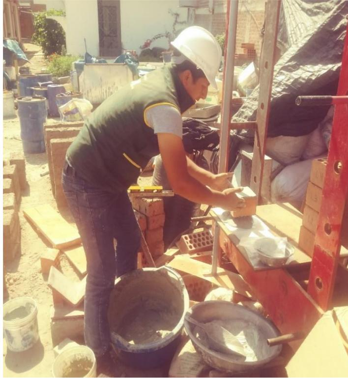
**Fig. 41.** Refrentado de unidades de albañilería
