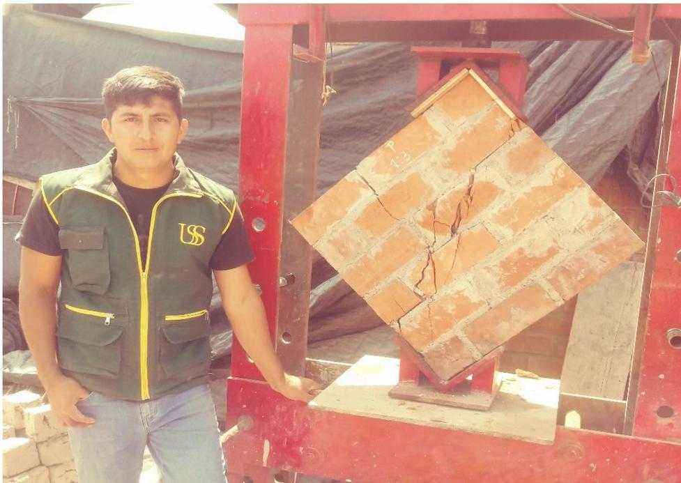
**Fig. 52.** Resistencia a la compresión diagonal de muretes
