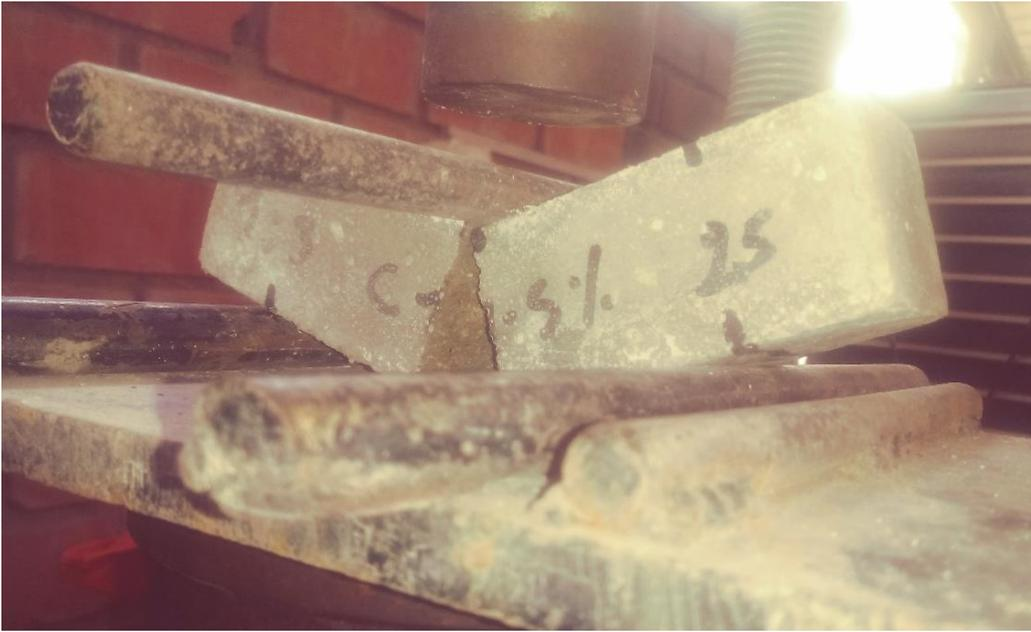
**Fig. 45.** Prisma ensayado a flexión
