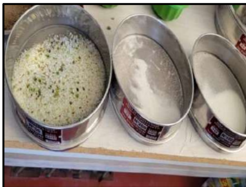
Fig. 16. Ensayo de granulometría de vidrio pulverizado
