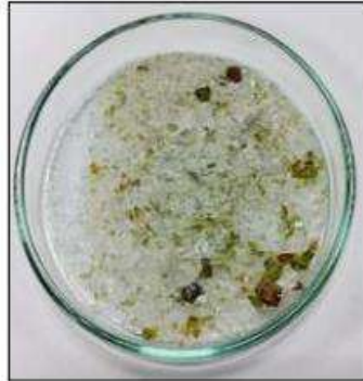
Figura N°1. MUESTRA DE VIDRIO PULVERIZADO.
