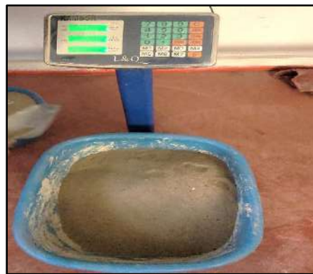
Fig. 23. Ensayo de Proctor modificado del suelo
