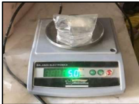
Fig. 19. Pesado de vidrio pulverizado para el ensayo químico.
