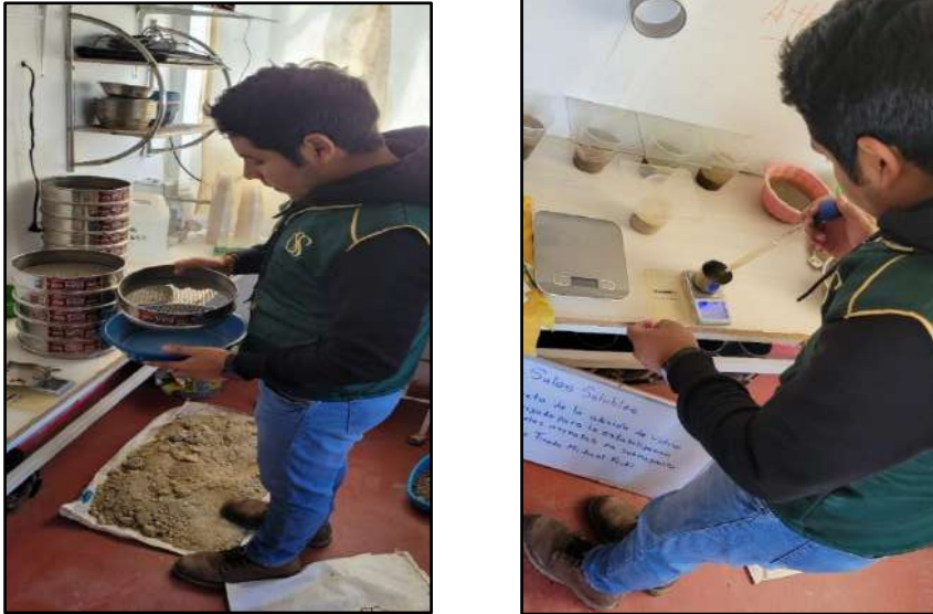
Fig. 30. Ensayo de granulometría y ensayo de sales
