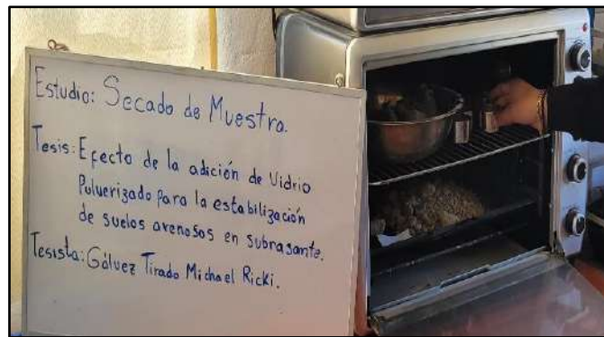
Fig. 21. Ensayo de contenido de humedad del suelo
