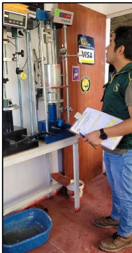
Fig. 31. Elaboración de Proctor y CBR
