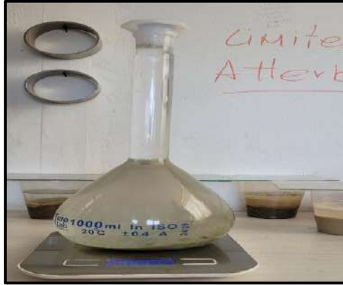
Fig. 18. Ensayo de peso específico del vidrio en partículas trituradas
