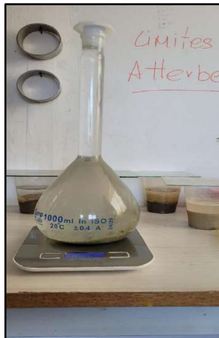
Fig. 34. Ensayo de peso unitario y peso específico
