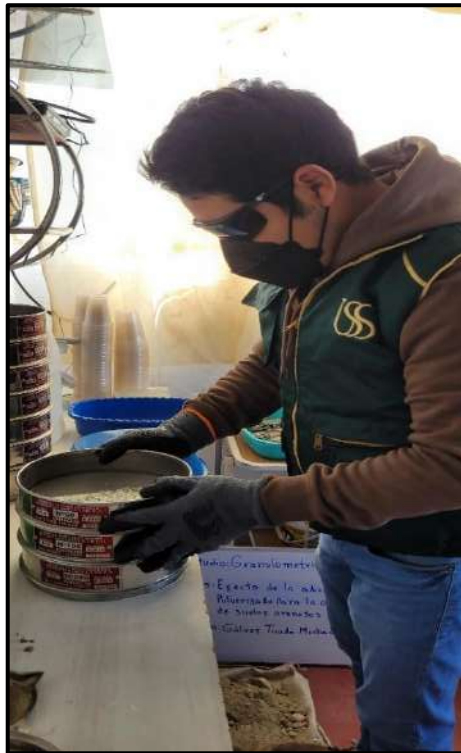
Fig. 33. Ensayo granulométrico del vidrio pulverizado
