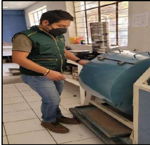
Fig. 15. Pulverización de partículas no uniformes de vidrio
