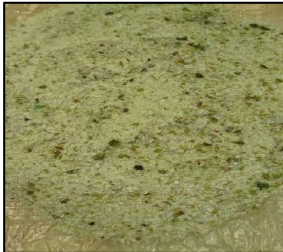
Fig. 14. Trituración de botellas
