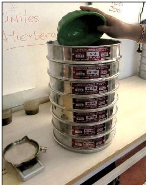
Fig. 20. Ensayo de granulometría del suelo
