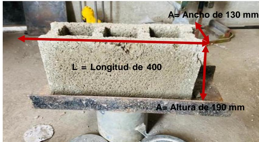
**Fig. 3.** Dimensiones de Bloques de concreto.
