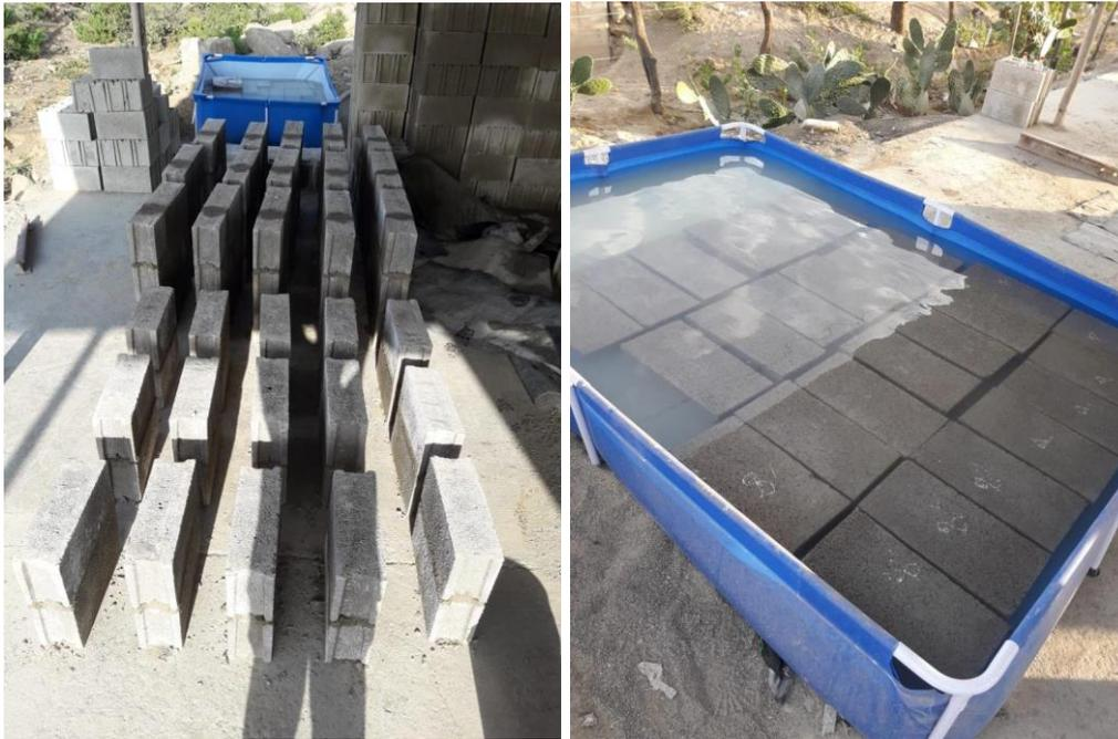
**Fotografía 7. Elaboración de pilas de bloque de concreto y curado de unidades**
