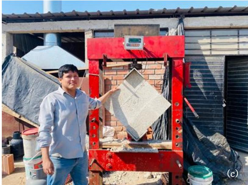
**Fig. 11.** Rotura de bloques de concreta resistencia a la compresión.
