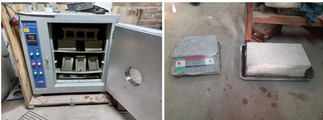
**Fotografía 9. Pruebas de absorción y succión para los bloques de concreto**
