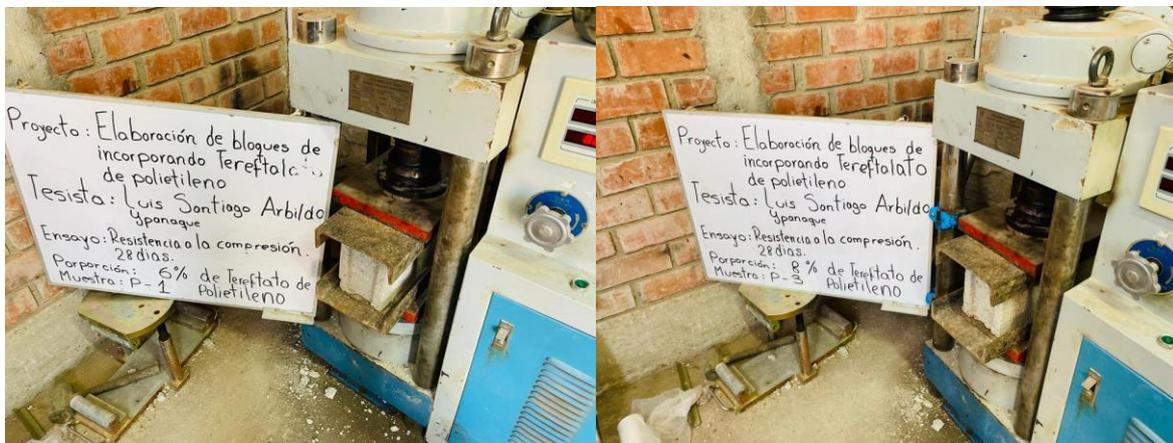
**Fotografía 11. Resistencia a la compresión en bloques con PET**
