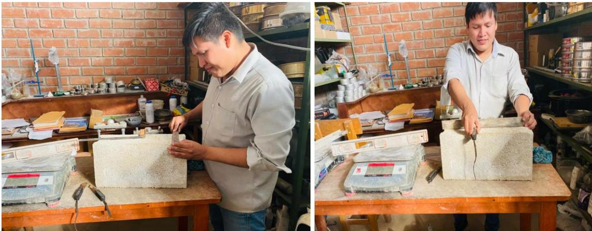
**Fotografía 8. Variación dimensional y alabeo de los bloques de concreto**
