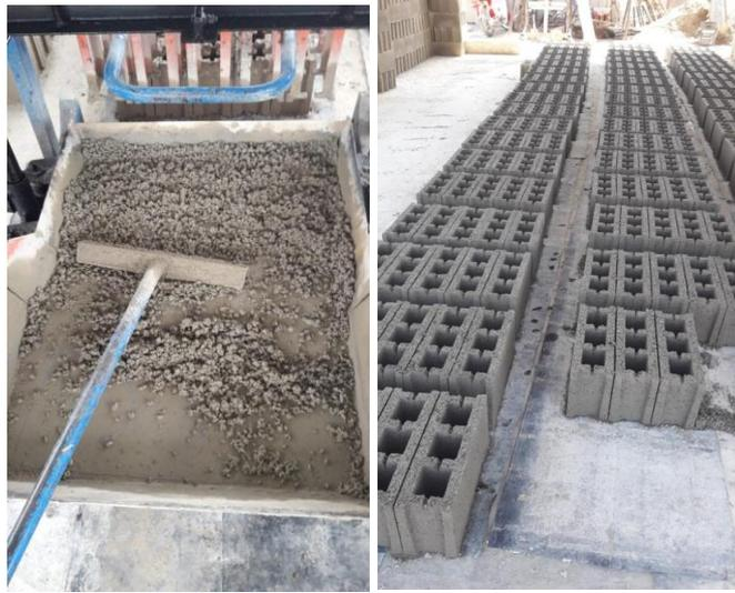
**Fig. 7.** Elaboración de bloques de concreto.
