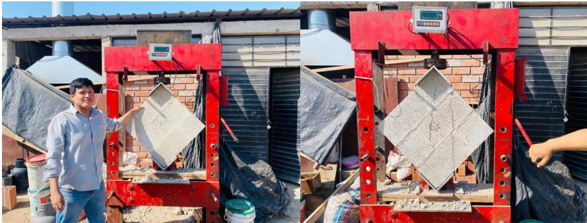
**Fotografía 13. Resistencia a la compresión en muretes con muestras con PET**
