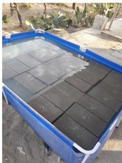
**Fig. 8.** Poza de curación de bloques de concreto.
