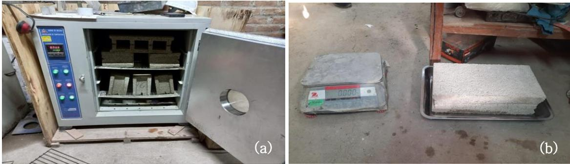
**Fig. 10.** Pruebas de (a) absorción y (b) succión.
