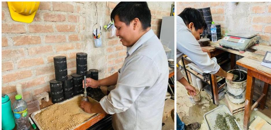
**Fotografía 4. Peso específico y absorción de los árido pétreos**
