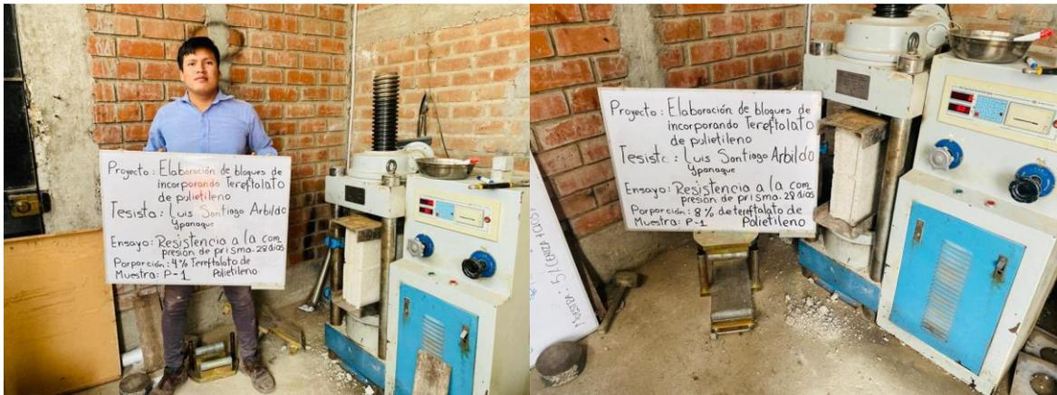
**Fotografía 12. Resistencia a la compresión en pilas de muestras con PET**
