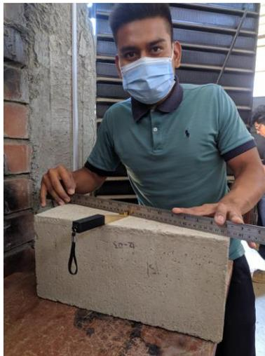
**Fig. 22.** Prueba de alabeo a la unidad de albañilería.
