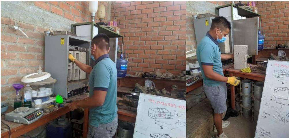
Muestras puestas en horno a  $110^{\circ}\text{C} \pm 5^{\circ}\text{C}$  de temperatura
