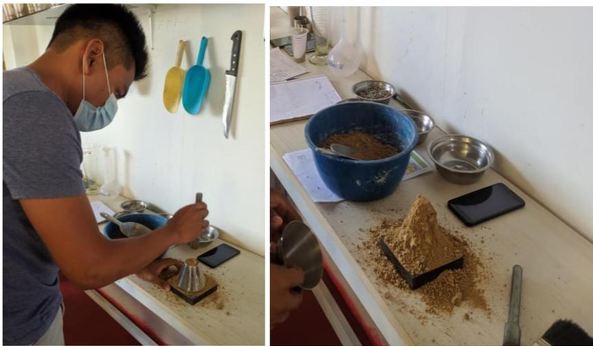
**Fig. 12.** Apisonado de la muestra de agregado fino en el interior del molde cónico y desmolde.
