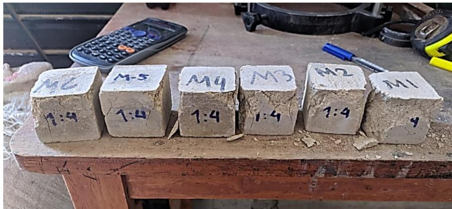
**Fig. 29.** Cubos de mortero sometidos al ensayo de compresión.
