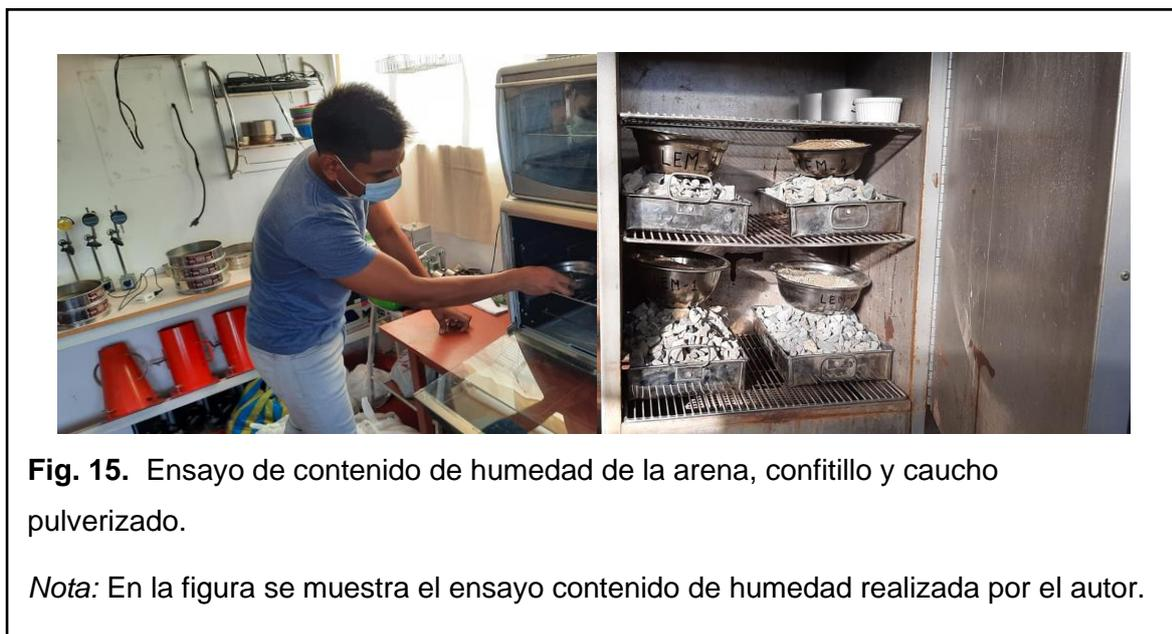
**Fig. 15.** Ensayo de contenido de humedad de la arena, confitillo y caucho pulverizado.
