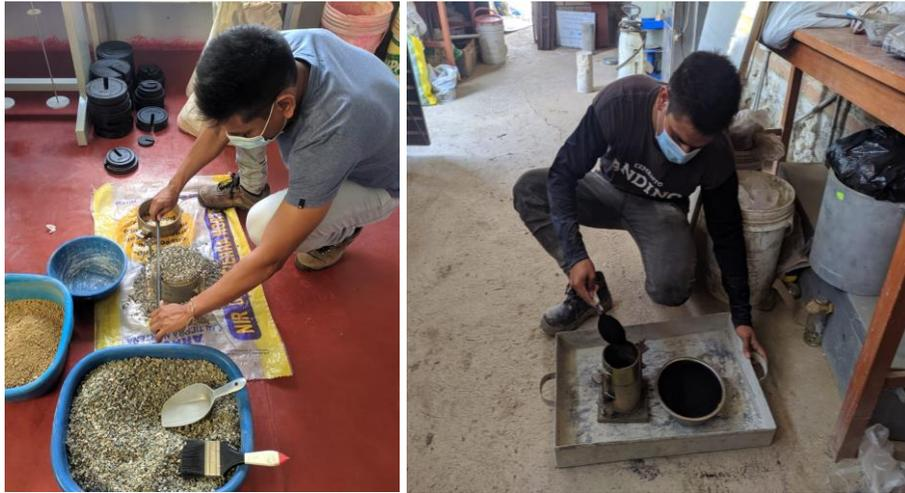
**Fig. 11.** Peso unitario suelto y compactado de la arena gruesa, confitillo y caucho pulverizado.
