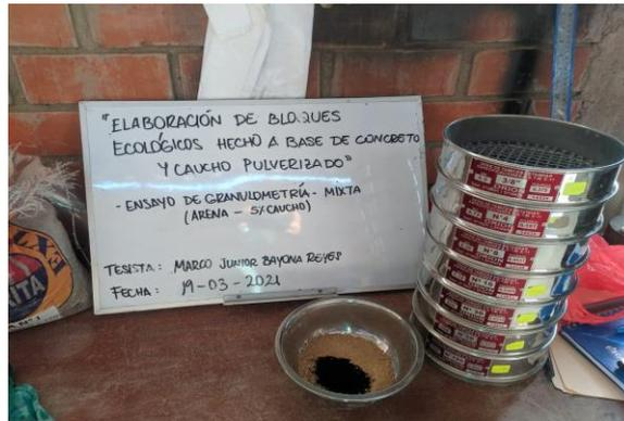
**Fig. 10.** Granulometría mixta del agregado fino (Arena – caucho).
