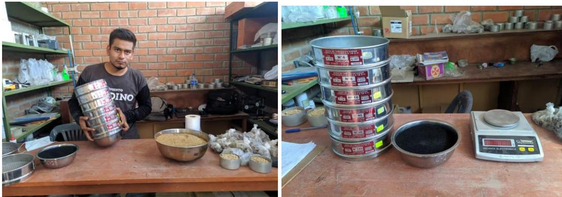
**Fig. 8.** Granulometría del agregado fino y caucho pulverizado.
