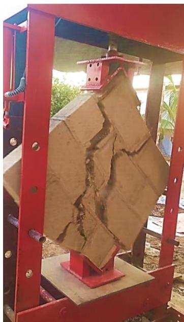
**Fig. 35.** Falla por tracción diagonal del murete de albañilería.
