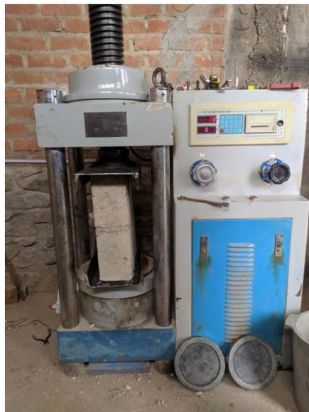
**Fig. 31.** Ensayo de resistencia a la compresión de prismas de albañilería.
