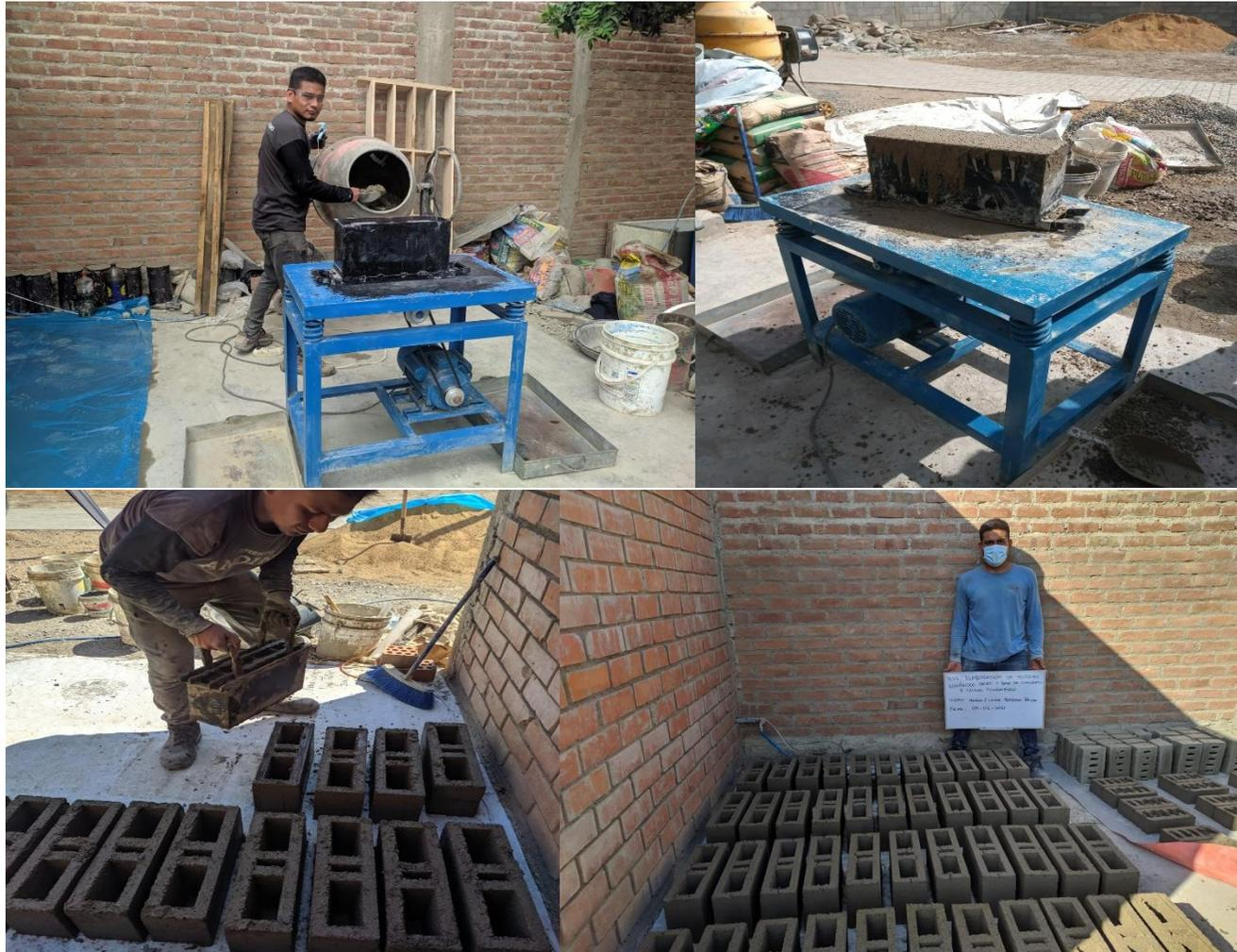
Proceso de elaboración: Preparación de la mezcla, vaciado en el molde y desmolde de bloques
