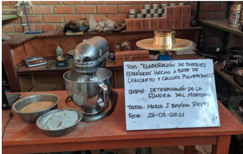
**Fig. 26.** Material y equipo para la preparación de mortero.
