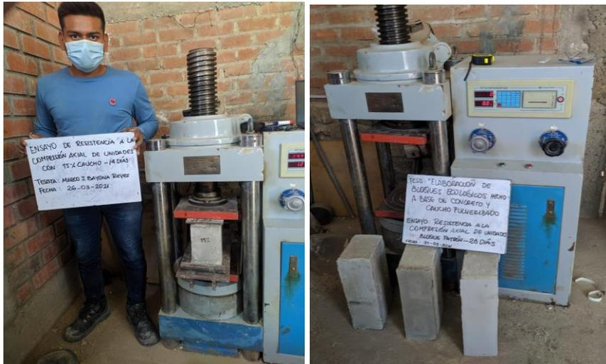
**Fig. 25.** Ensayo de compresión de bloques de concreto - caucho.
