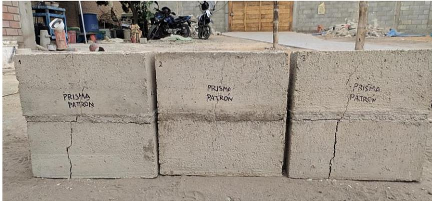
**Fig. 32.** Falla vertical presentada en primas de albañilería.
