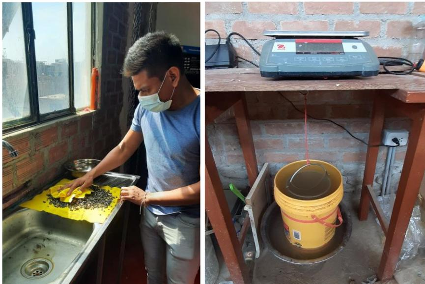
**Fig. 14.** Secado superficial y sumergido del confitillo.
