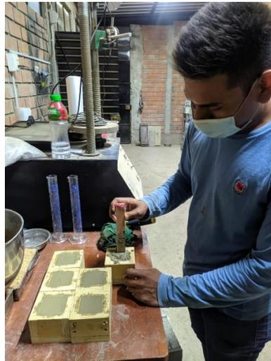
**Fig. 28.** Elaboración de cubos de mortero de 50 mm de lado.
