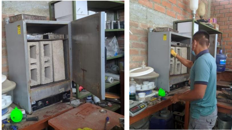
**Fig. 23.** Secado de bloques de concreto en horno para ensayo de absorción.
