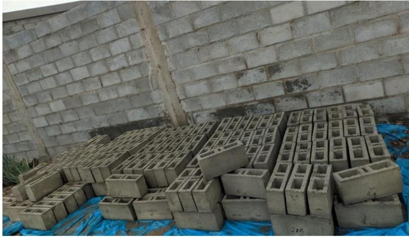
**Fig. 19.** Apilado y curado de bloques.
