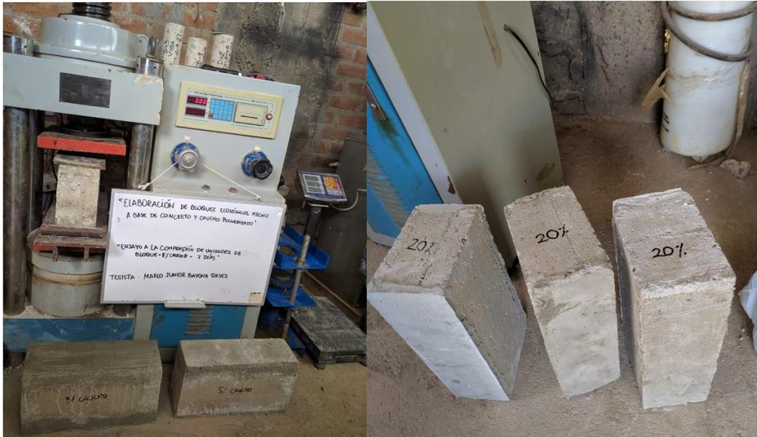
Refrentado de las superficies de los bloques con una mezcla de (cemento – yeso)
