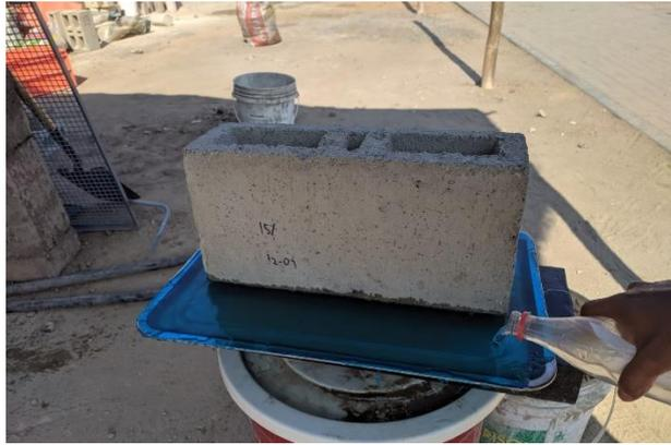
**Fig. 24.** Ensayo de succión en la cara de asiento de la unidad de concreto.
