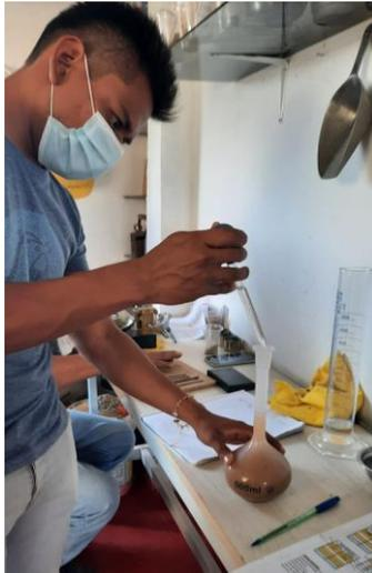
**Fig. 13.** Procedimiento gravimétrico del agregado fino.
