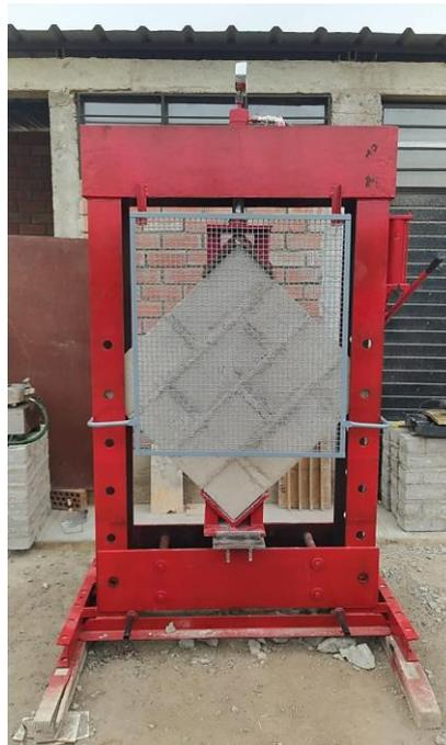
**Fig. 34.** Ensayo de compresión diagonal en muretes.
