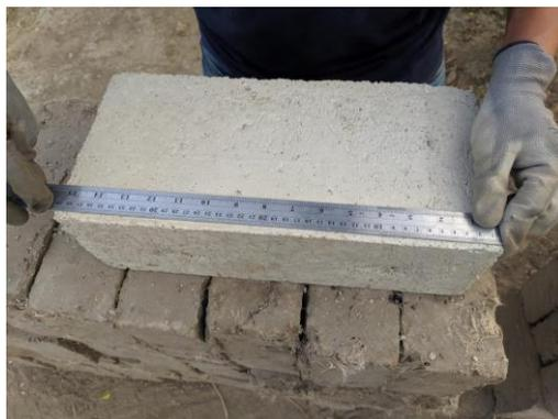
**Fig. 21.** Medición de dimensiones de bloques.
