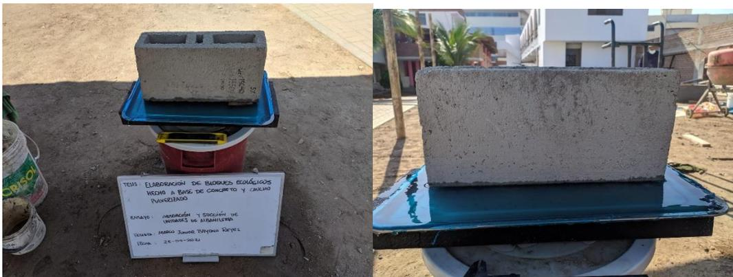
Ensayo de Succión a bloques de concreto
