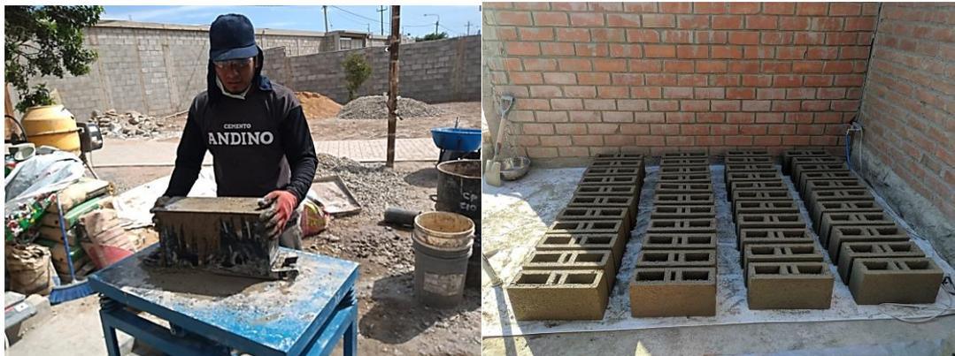
**Fig. 18.** Elaboración y fraguado de bloques de concreto.
