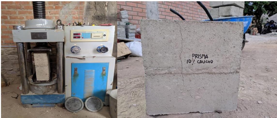
Ensayo de compresión de pilas, presenta una falla de tipo vertical
