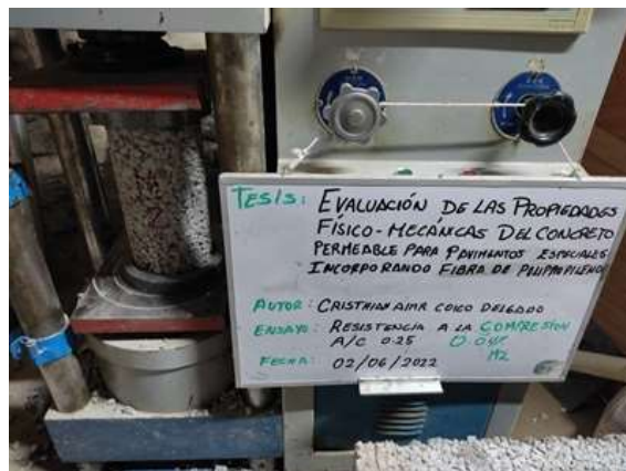
Ensayo de Resistencia a la Compresión del Concreto Permeable con 0.04% de Fibra con relación a/c 0.25
