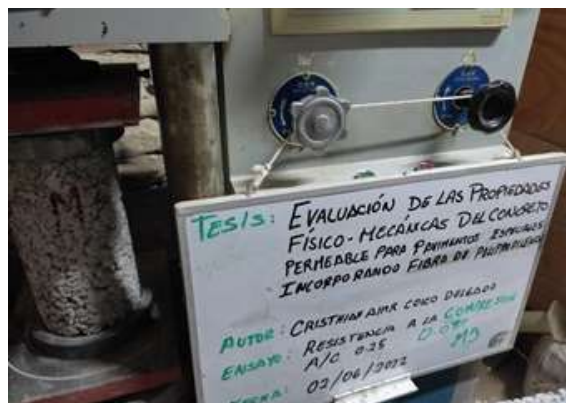
Ensayo de Resistencia a la Compresión del Concreto Permeable con 0.07% de Fibra
