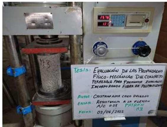
Ensayo de Resistencia a la Compresión del Concreto Permeable con 0.04% de Fibra con relación a/c 0.25
