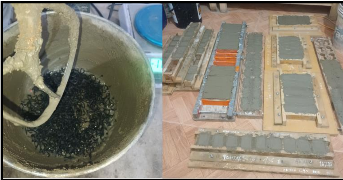
Preparación de Mortero Patrón y Mortero con HDPE
