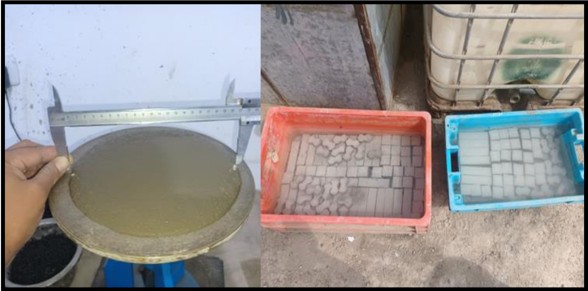
Ensayo de Fluides del Mortero y Muestras puestas a curar
