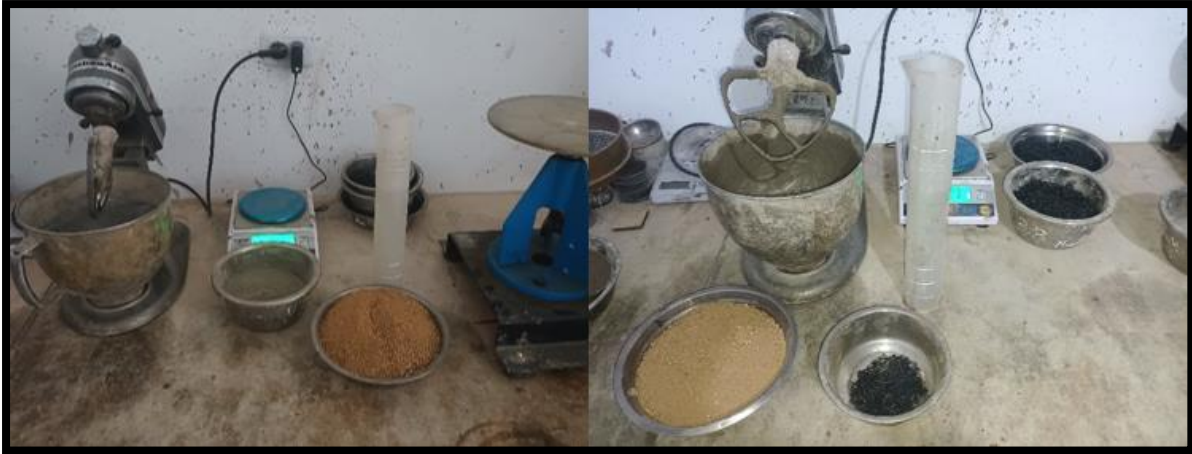
Preparación de Mortero Patrón y Mortero con HDPE
