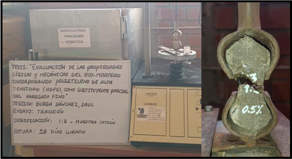
Ensayo a Tracción del Mortero
