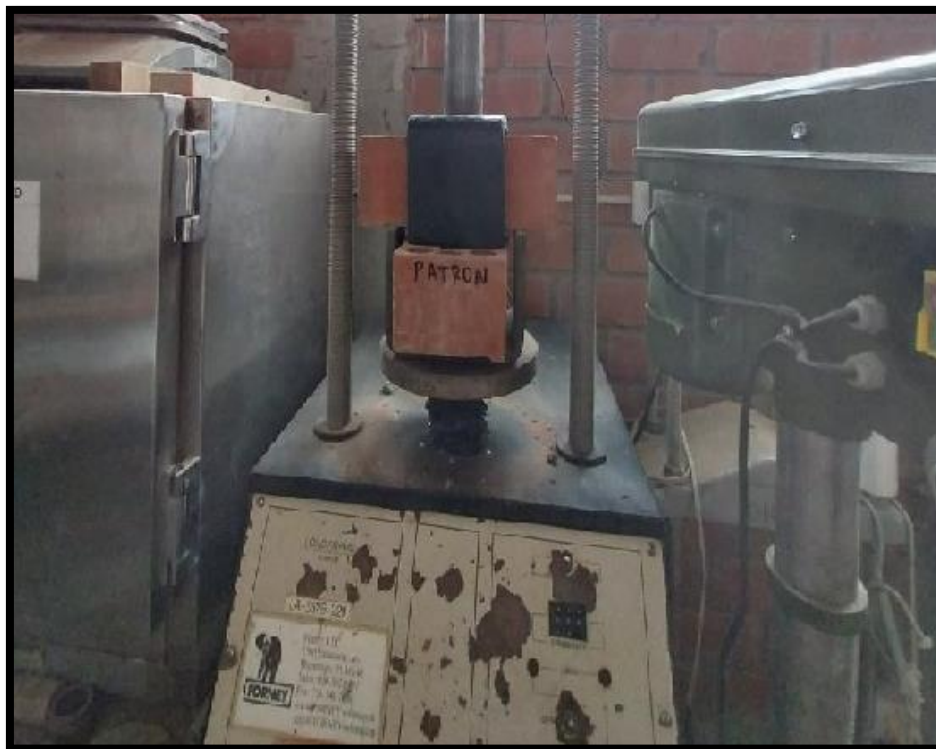
Ensayo de adherencia en unidades de albañilería
