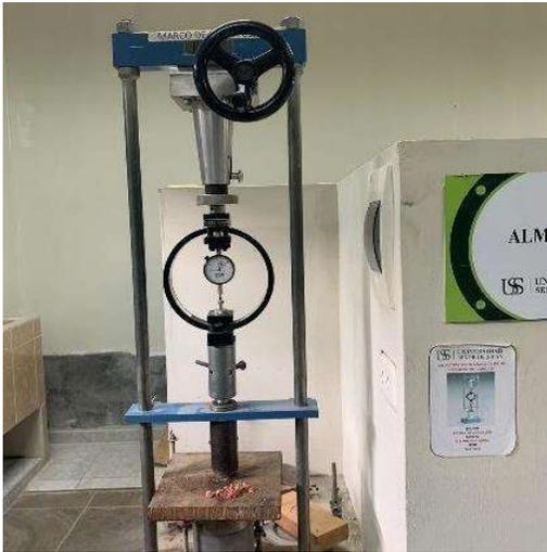
**Figura 17** Prensa CBR - Ensayo de resistencia
