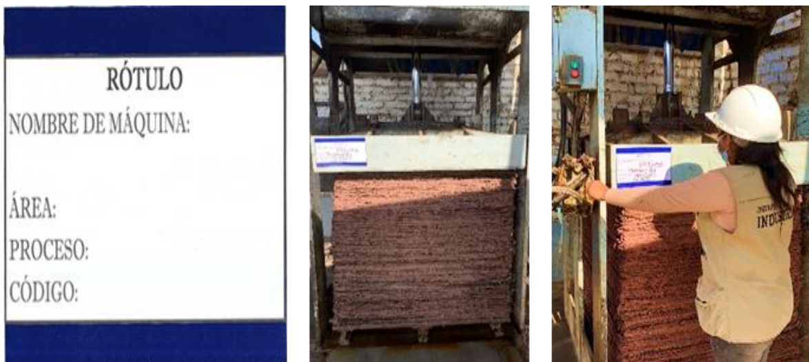
Figura 41. Rotulado de máquinas y herramientas
