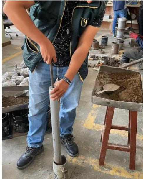
**Fig. 7.** Ensayo de Proctor modificado
