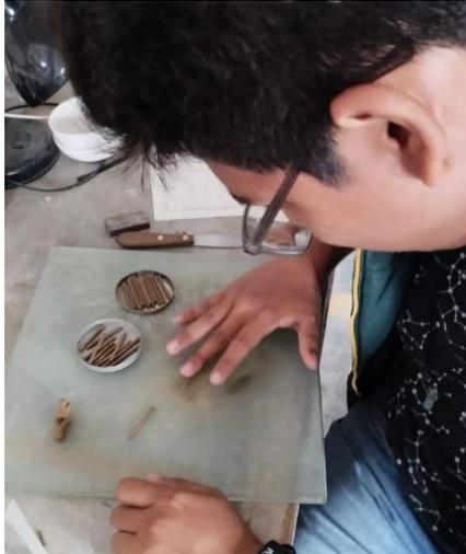
**Fig. 6.** Ensayo de limite plástico y limite líquido
