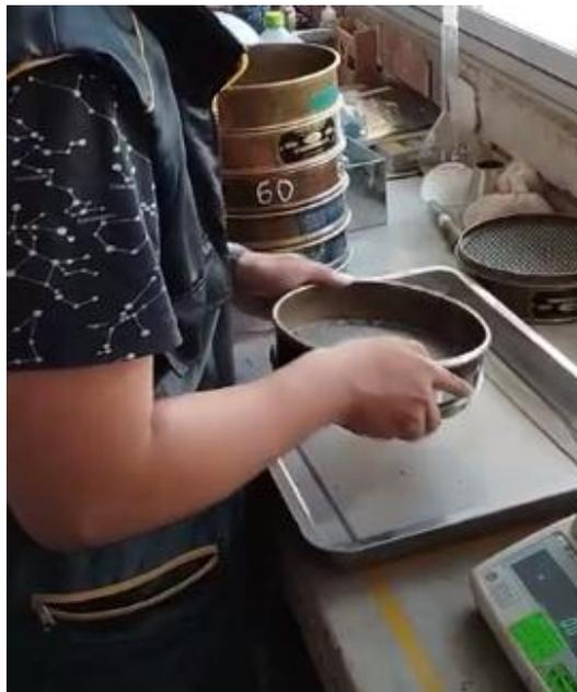
**Fig. 5.** Tamices para el ensayo granulométrico
